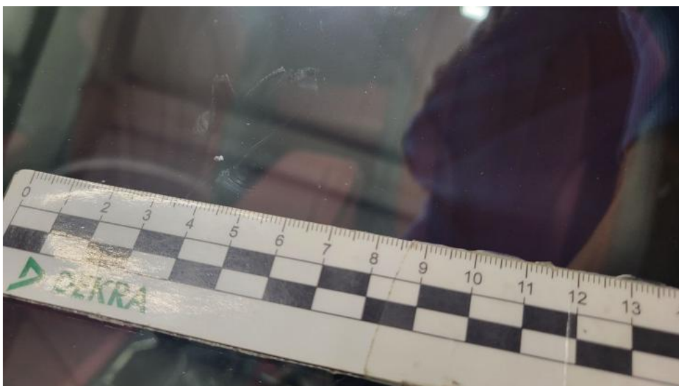
Photo 42. Szyba czołowa - Rysa/odprysk 1
