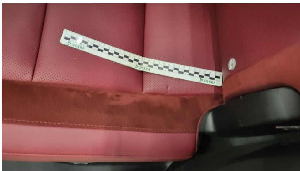
Photo 54. Kanapa tyl. - Wgniecenie/odkształcenie 1
