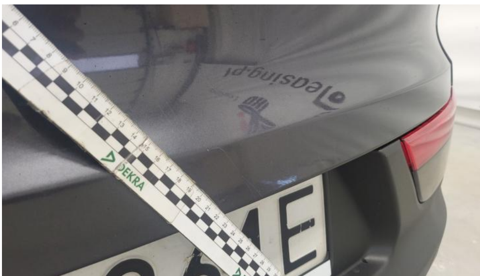
Photo 77. Pokrywy bagażnika - Rysa/odprysk 2
