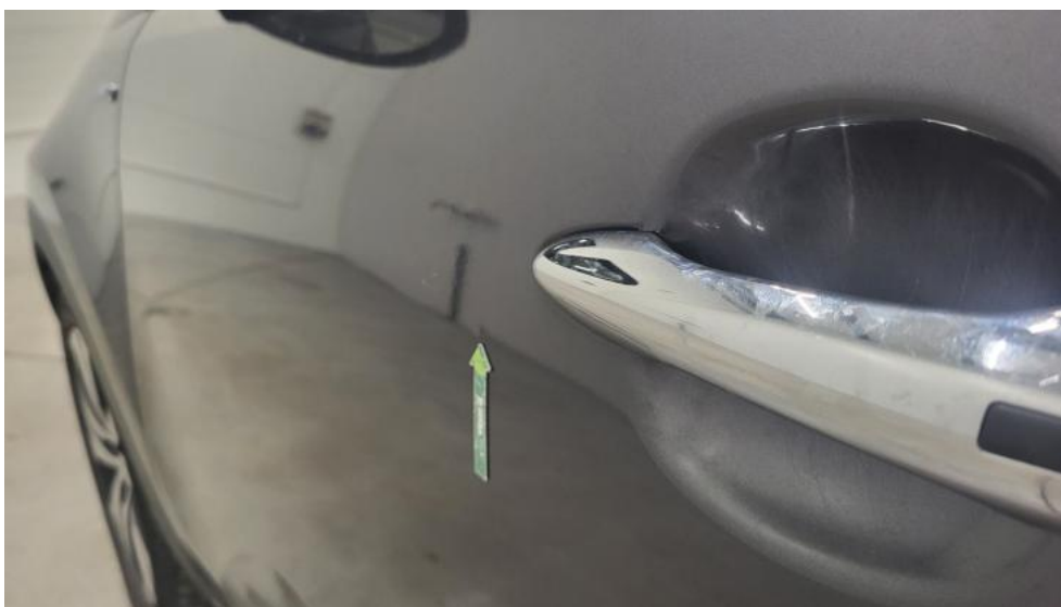
Photo 107. Drzwi przed L - Wgniecenie/odkształcenie 1
