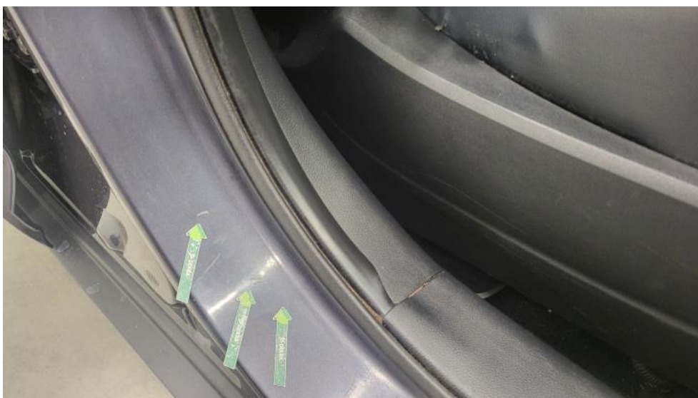
Photo 72. Słupek środkowy P - Wgniecenie/odkształcenie 1
