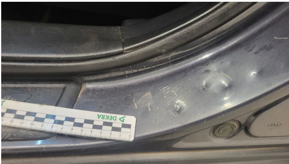
Photo 109. Próg L - Rysa/odprysk 1
