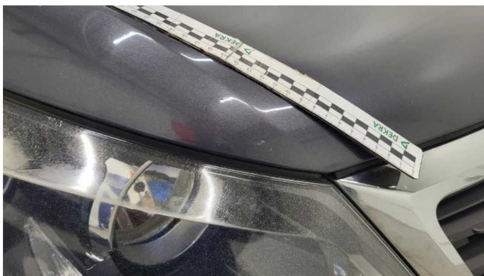
Photo 46. Pokrywa komory silnika - Rysa/odprysk 2
