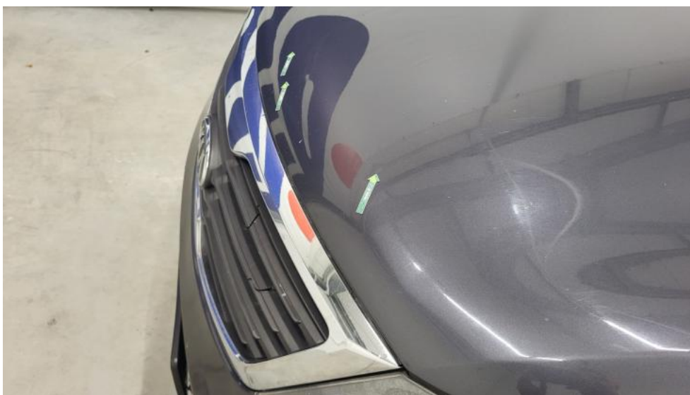
Photo 49. Pokrywa komory silnika() - Wgniecenie/odkształcenie 3
