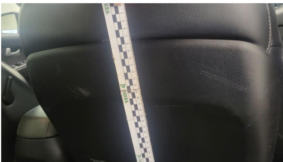
Photo 130. Fotel prz. praw. - Rysa/odprysk 1
