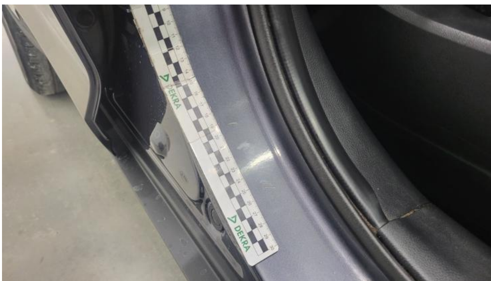
Photo 71. Słupek środkowy P - Rysa/odprysk 1
