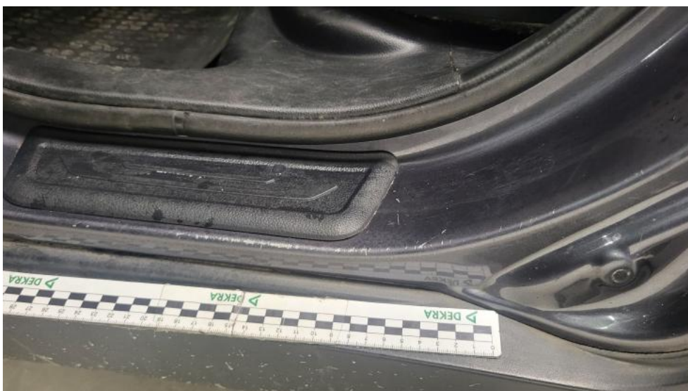
Photo 110. Próg L - Rysa/odprysk 2
