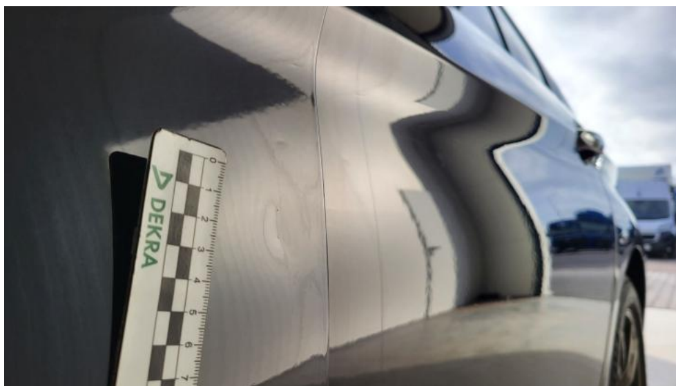
Photo 85. Drzwi przed L - Wgniecenie/odkształcenie 1
