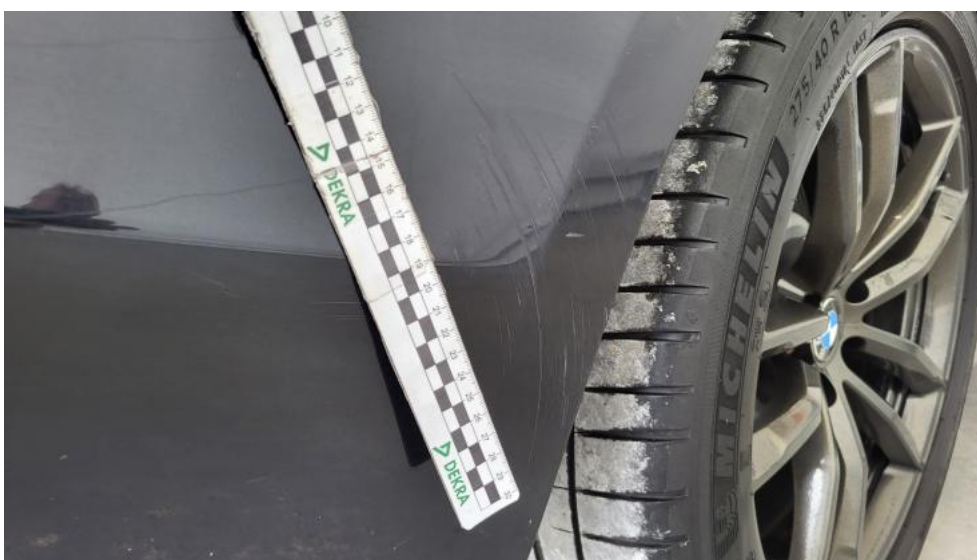
Photo 74. Zderzak tylny - Rysa/odprysk 2
