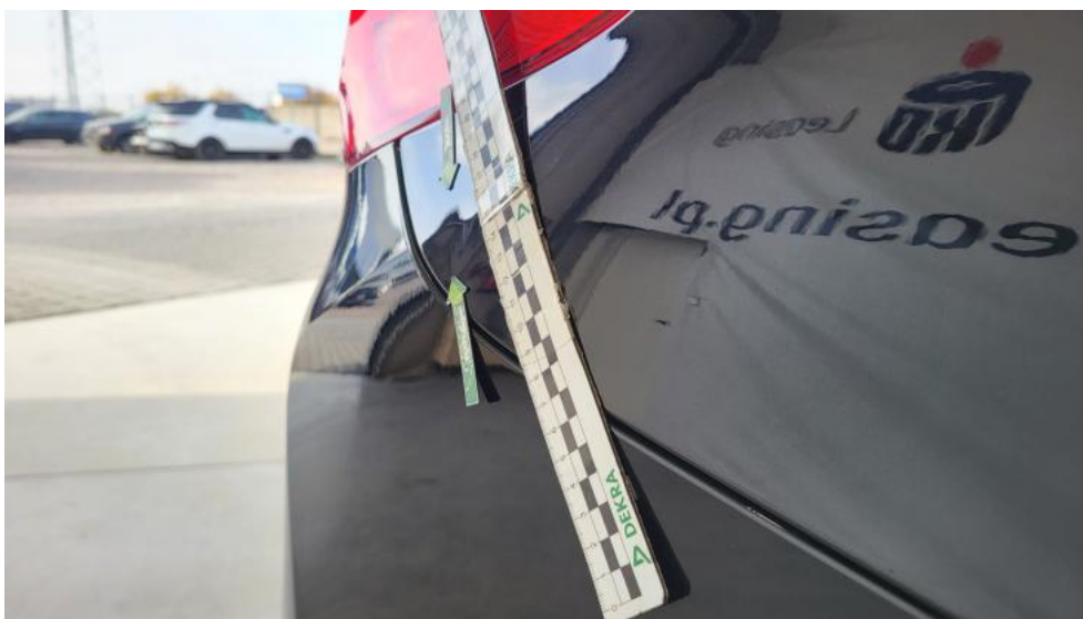
Photo 69. Błotnik tylny P / Ściana boczna P - Wgniecenie/odkształcenie 1
