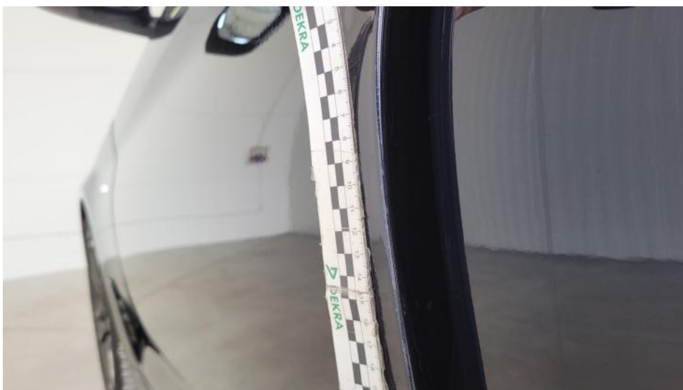
Photo 82. Drzwi przed L - Rysa/odprysk 1
