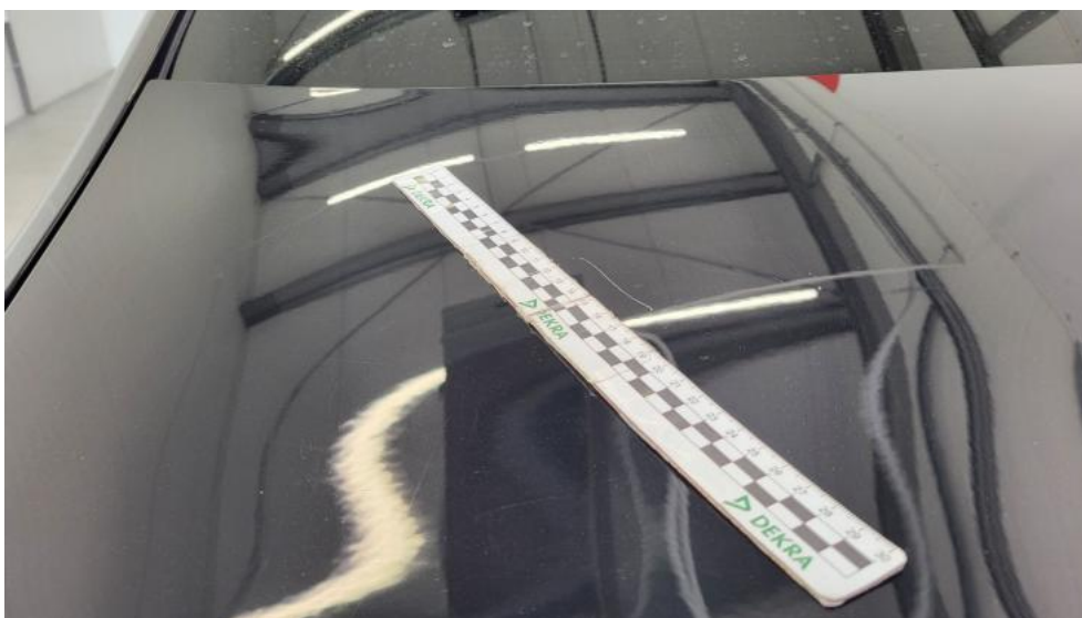
Photo 70. Pokrywy bagażnika - Rysa/odprysk 1
