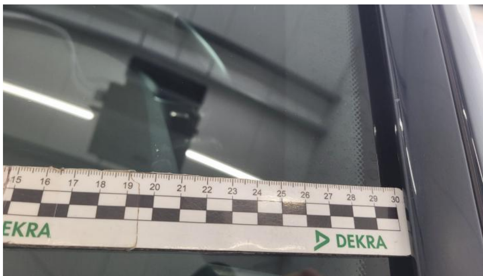
Photo 53. Szyba czołowa - Rysa/odprysk 1
