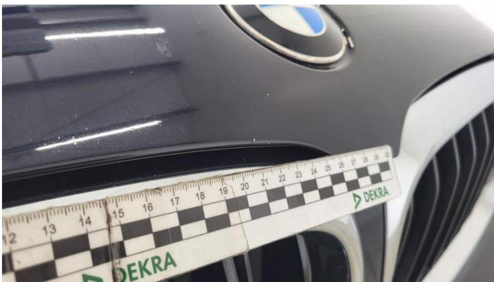
Photo 51. Pokrywa komory silnika() - Rysa/odprysk 3
