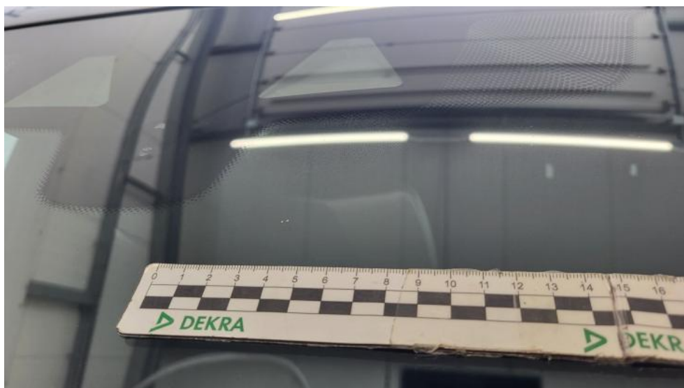
Photo 54. Szyba czołowa - Rysa/odprysk 2
