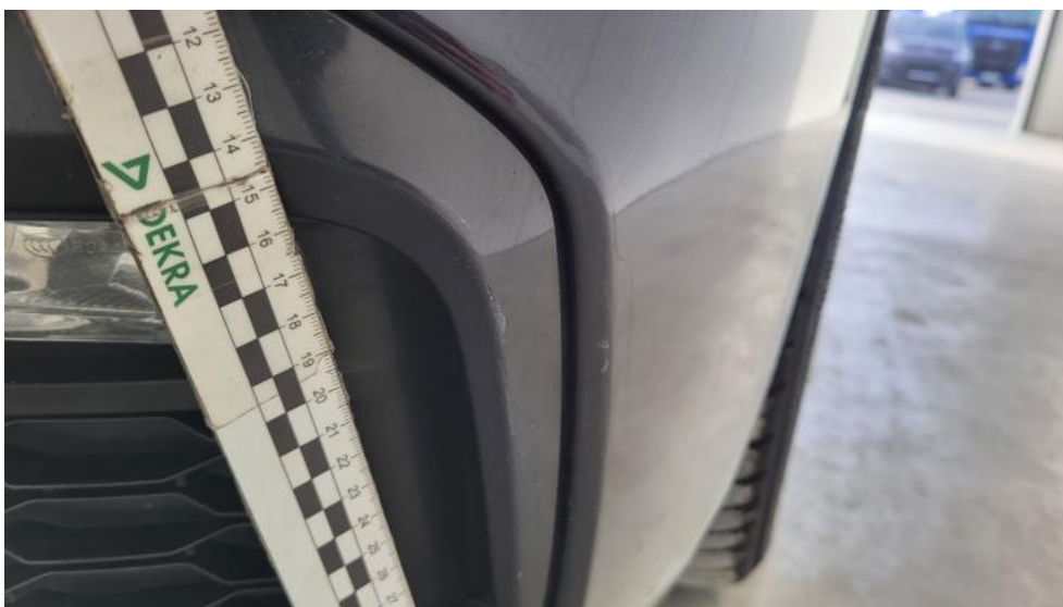
Photo 48. Atrapa przednia - Rysa/odprysk 1
