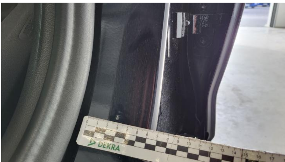
Photo 88. Słupek środkowy L - Rysa/odprysk 1
