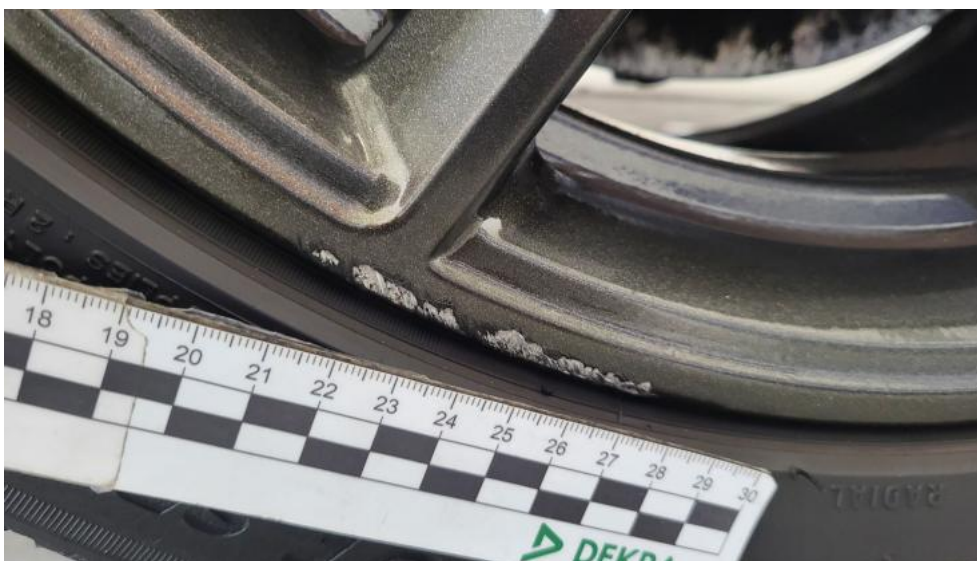
Photo 61. Felga aluminiowa przednia P - Rysa/odprysk 1
