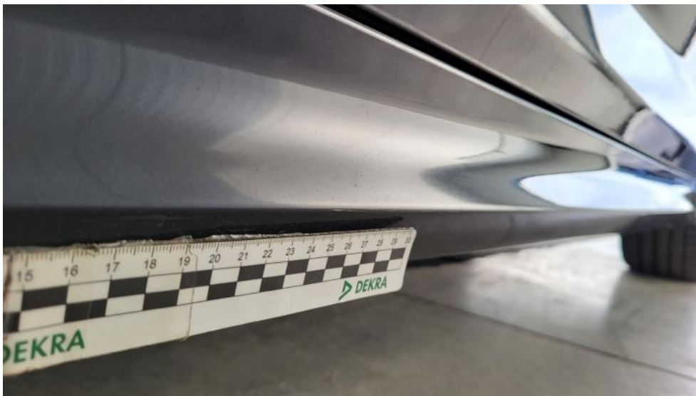
Photo 87. Próg L - Rysa/odprysk 1
