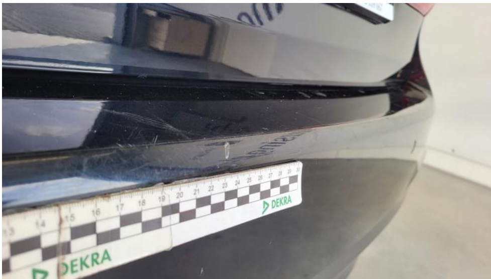
Photo 75. Zderzak tylny() - Rysa/odprysk 3
