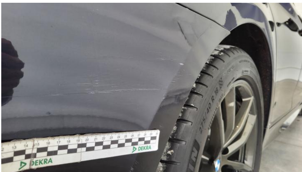
Photo 73. Zderzak tylny - Rysa/odprysk 1
