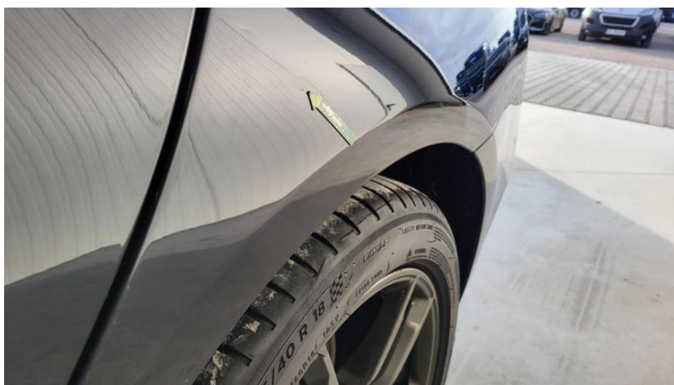
Photo 80. Błotnik tylny L / Ściana boczna L - Wgniecenie/odkształcenie 1
