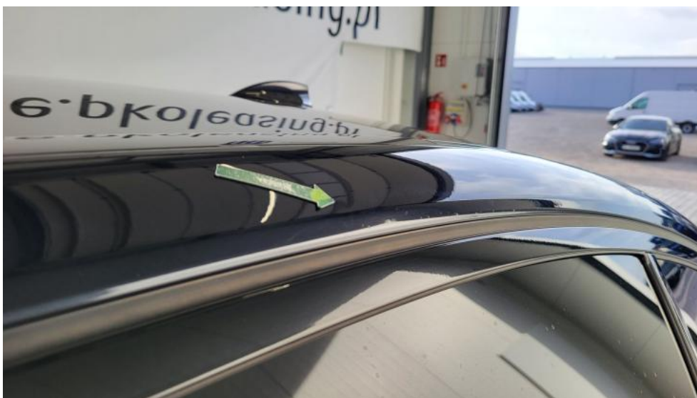
Photo 81. Błotnik tylny L / Ściana boczna L - Wgniecenie/odkształcenie 2
