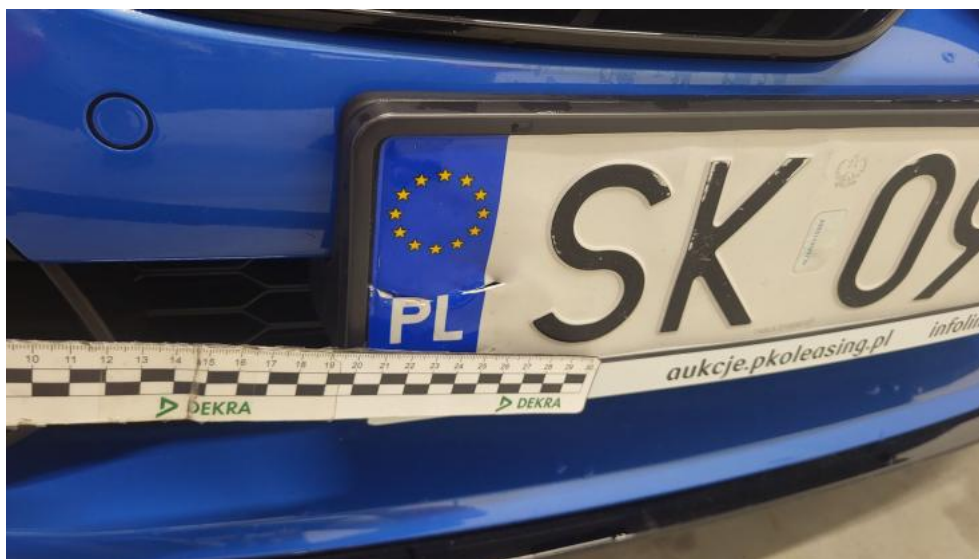
Photo 47. Tablica rejestracyjna- Pęknięcie/rozerwanie 2
