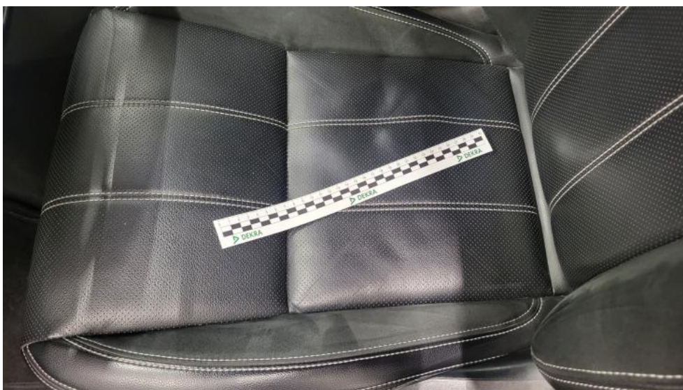
Fot. 79. Fotel prz. lew. - Wgniecenie/odkształcenie 1
