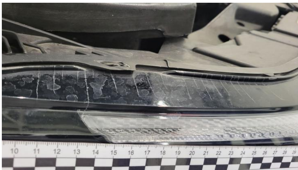
Fot. 59. Reflektor P - Pęknięcie/rozerwanie 2
