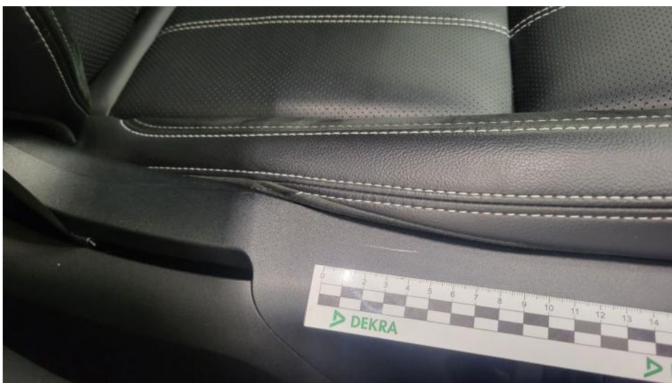
Fot. 81. Fotel prz. praw. - Rysa/odprysk 1
