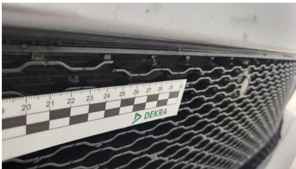
Fot. 44. Atrapa przednia - Pęknięcie/rozerwanie 2
