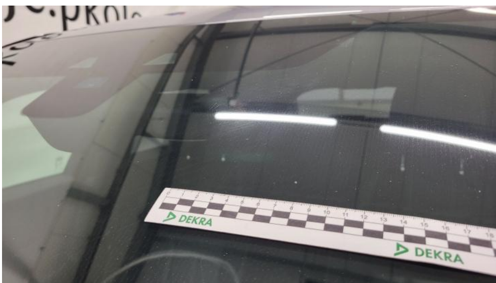
Fot. 50. Szyba czołowa ogrzewana - Rysa/odprysk 2
