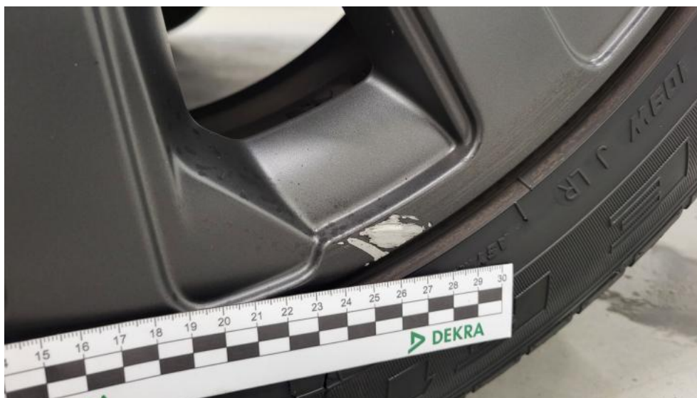
Fot. 69. Felga aluminiowa tylna L - Rysa/odprysk 1
