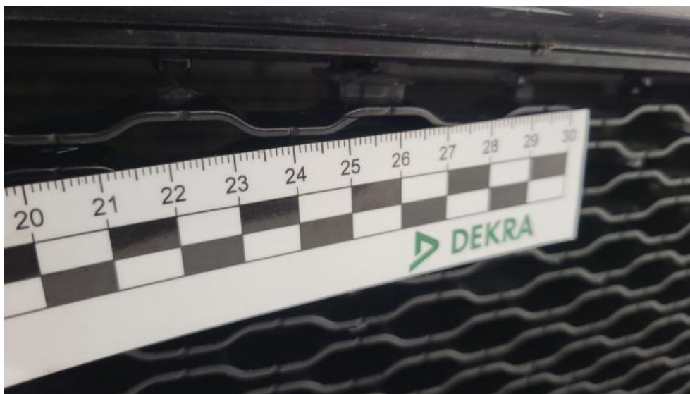
Fot. 45. Atrapa przednia() - Pęknięcie/rozerwanie 3
