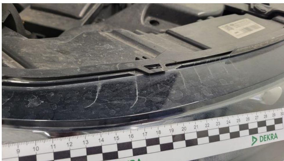
Fot. 60. Reflektor P() - Pęknięcie/rozerwanie 3
