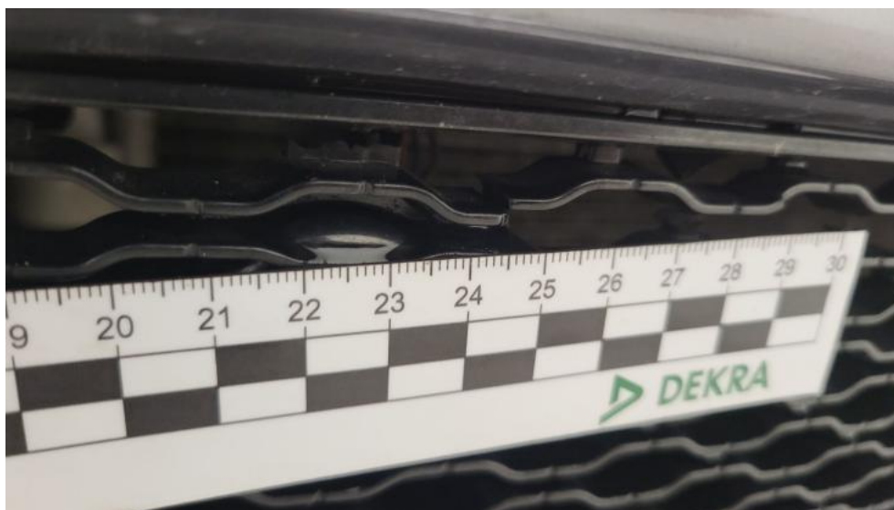
Fot. 43. Atrapa przednia - Pęknięcie/rozerwanie 1
