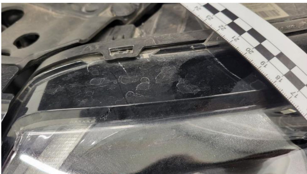
Fot. 78. Reflektor L - Pęknięcie/rozerwanie 2
