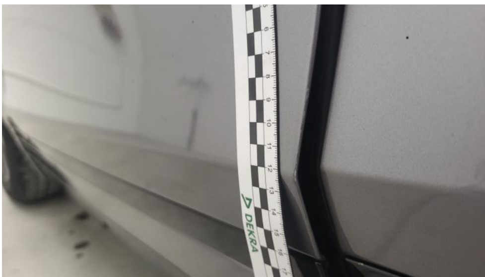
Fot. 71. Drzwi przed L - Rysa/odprysk 1
