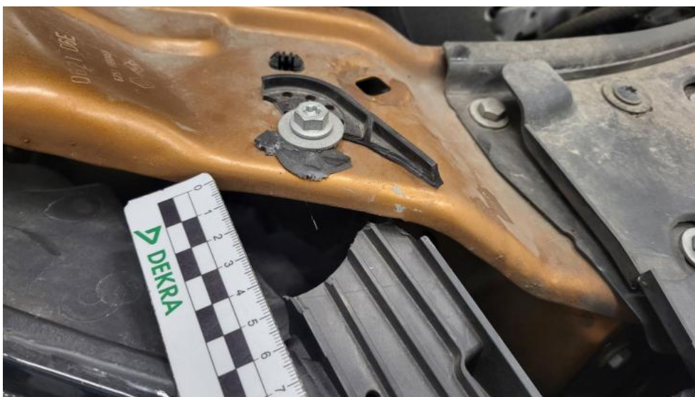
Photo 71. Reflektor P - Pęknięcie/rozerwanie 2
