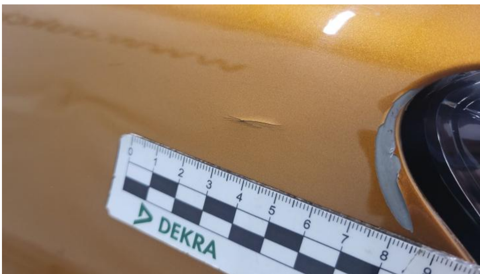
Photo 67. Błotnik przedni P - Pęknięcie/rozerwanie 1
