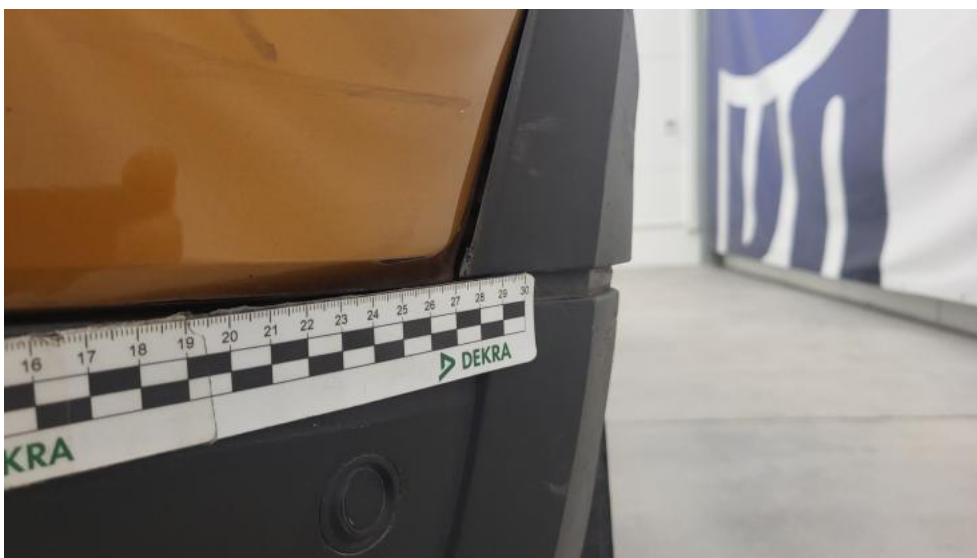
Photo 88. Zderzak tylny - Rysa/odprysk 2
