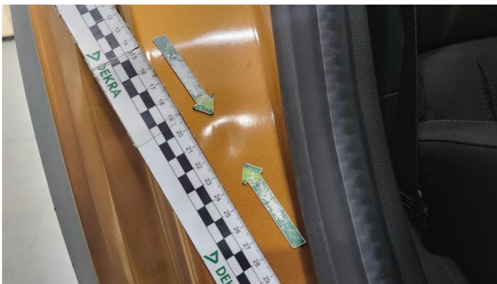
Photo 81. Błotnik tylny P / Ściana boczna P - Wgniecenie/odkształcenie 1
