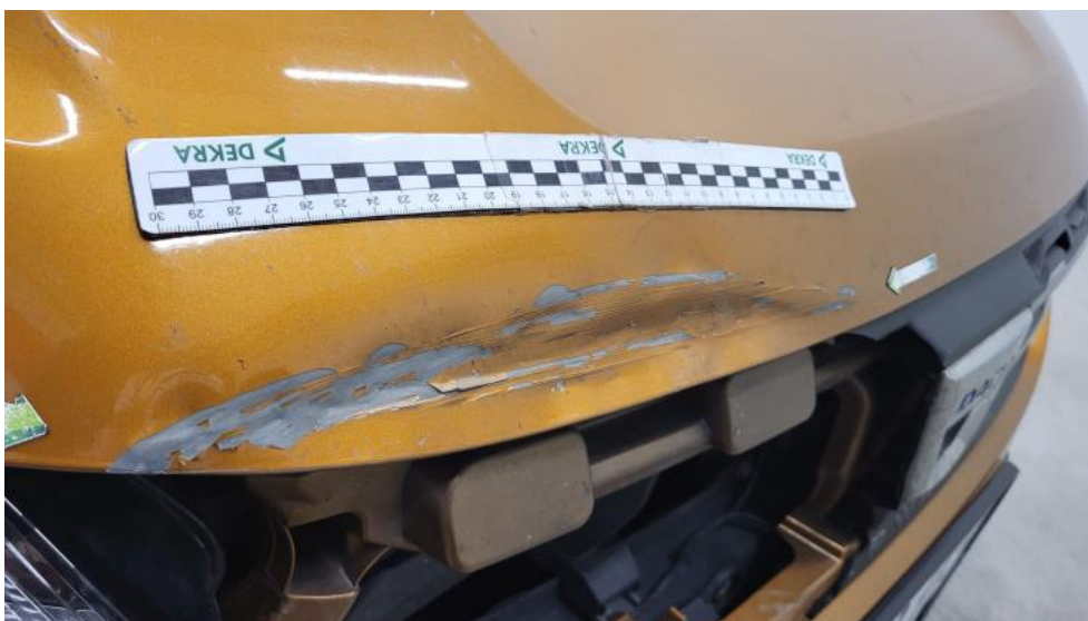
Photo 48. Pokrywa komory silnika - Rysa/odprysk 1
