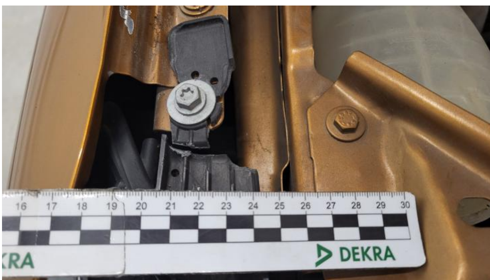
Photo 70. Reflektor P - Pęknięcie/rozerwanie 1
