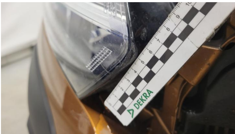
Photo 69. Reflektor P - Rysa/odprysk 1
