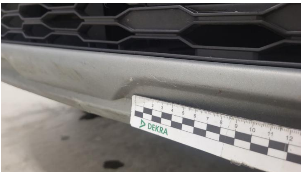
Photo 52. Spoiler zderzaka przedniego - Rysa/odprysk 1
