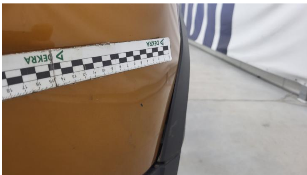
Photo 90. Zderzak tylny - Wgniecenie/odkształcenie 1
