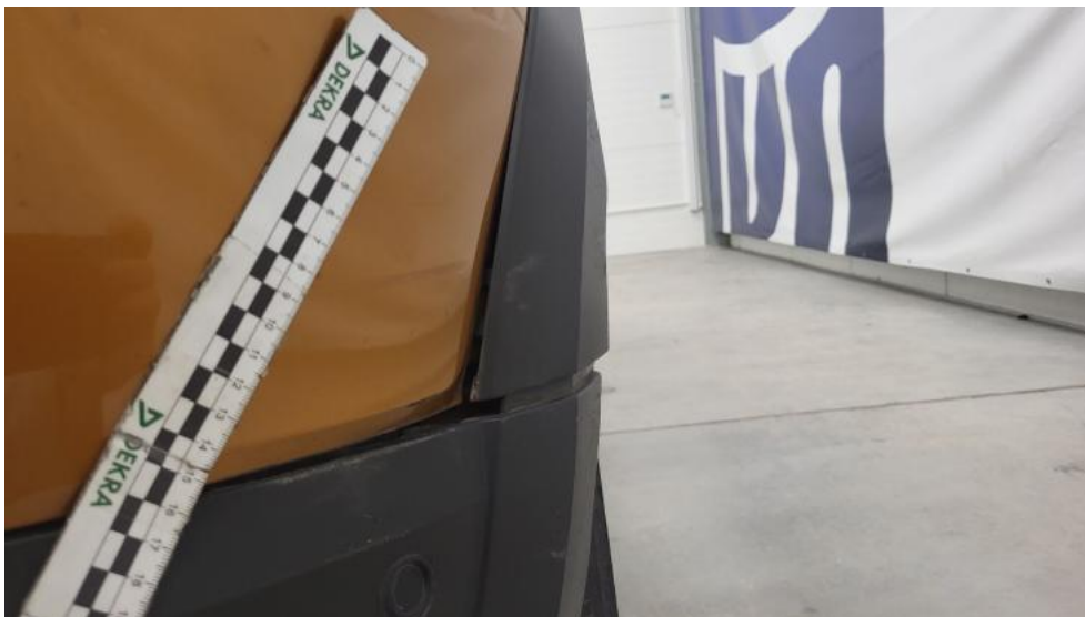
Photo 91. Zderzak tylny - Wgniecenie/odkształcenie 2
