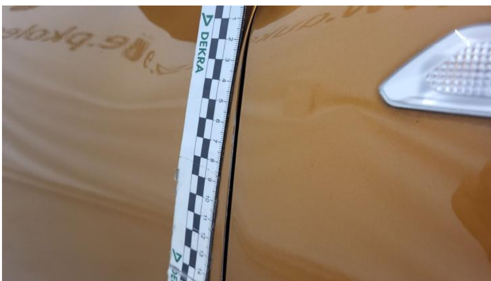
Photo 72. Drzwi przednie P - Rysa/odprysk 1
