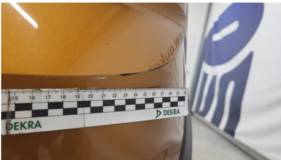
Photo 87. Zderzak tylny - Rysa/odprysk 1
