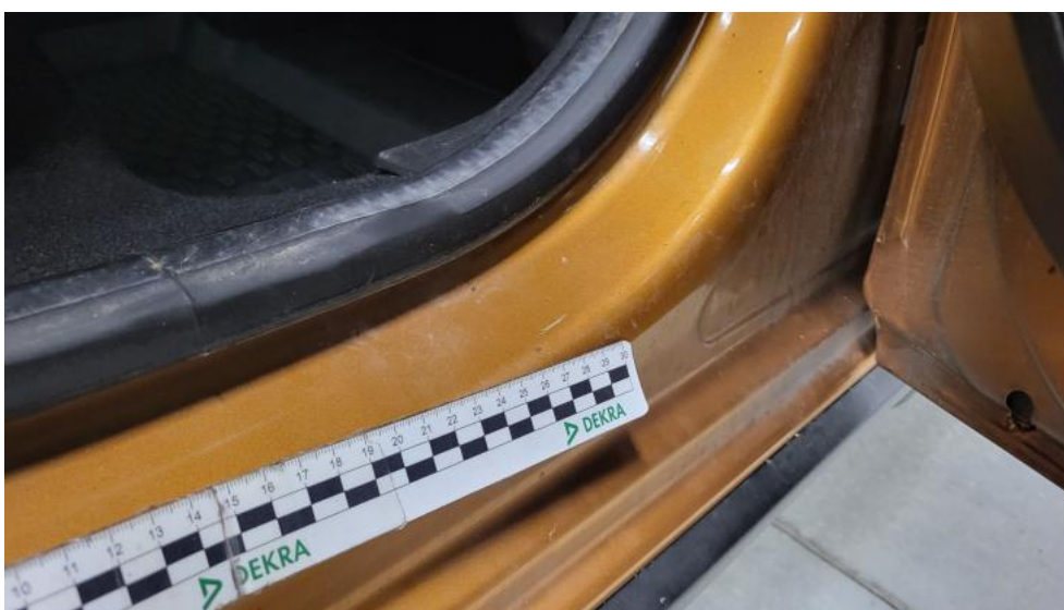
Photo 76. Próg P - Rysa/odprysk 2
