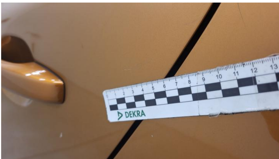
Photo 102. Drzwi tylne L - Rysa/odprysk 1
