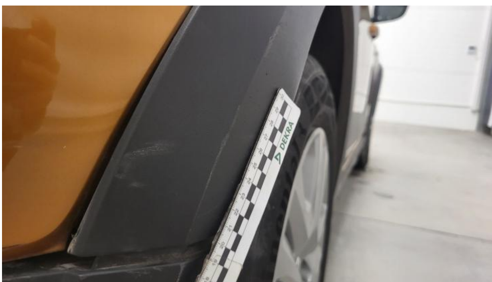
Photo 82. Listwa krawędzi błotnika tył P - Rysa/odprysk 1
