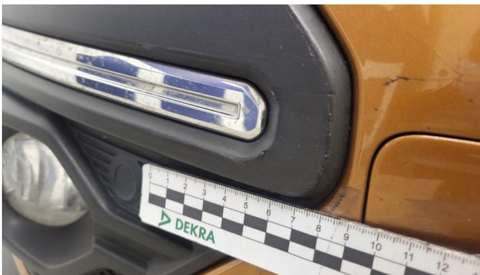
Photo 47. Kratka/zaślepka halogenu P - Rysa/odprysk 1
