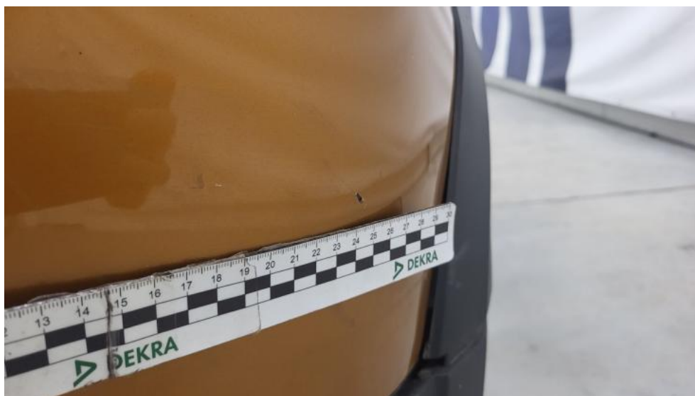
Photo 89. Zderzak tylny() - Rysa/odprysk 3
