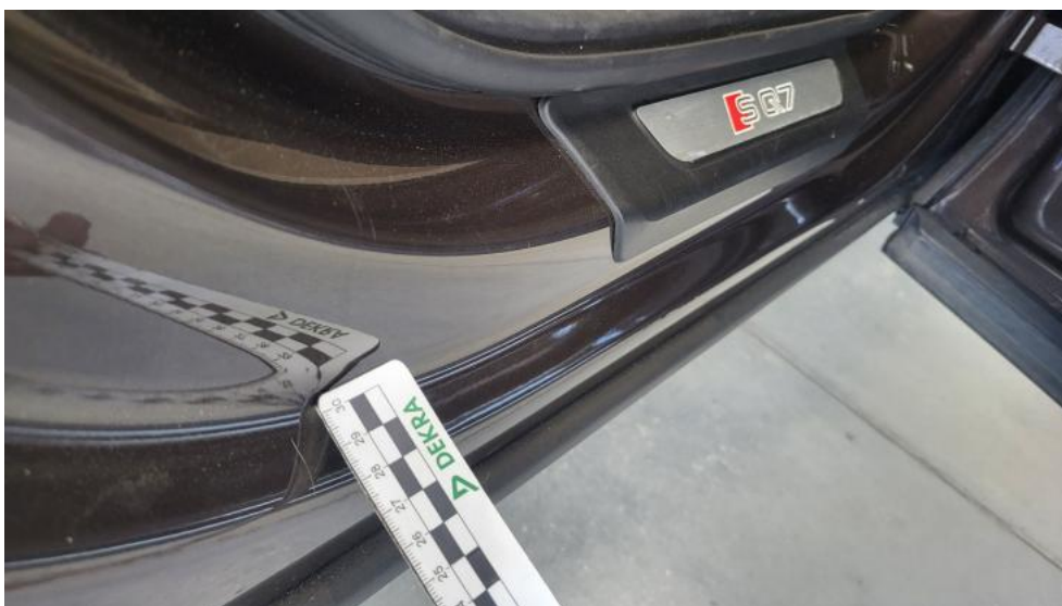
Fot. 60. Próg P - Rysa/odprysk 2
