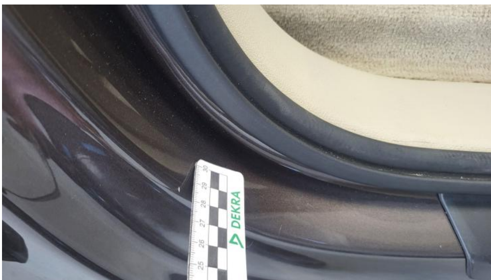
Fot. 59. Próg P - Rysa/odprysk 1
