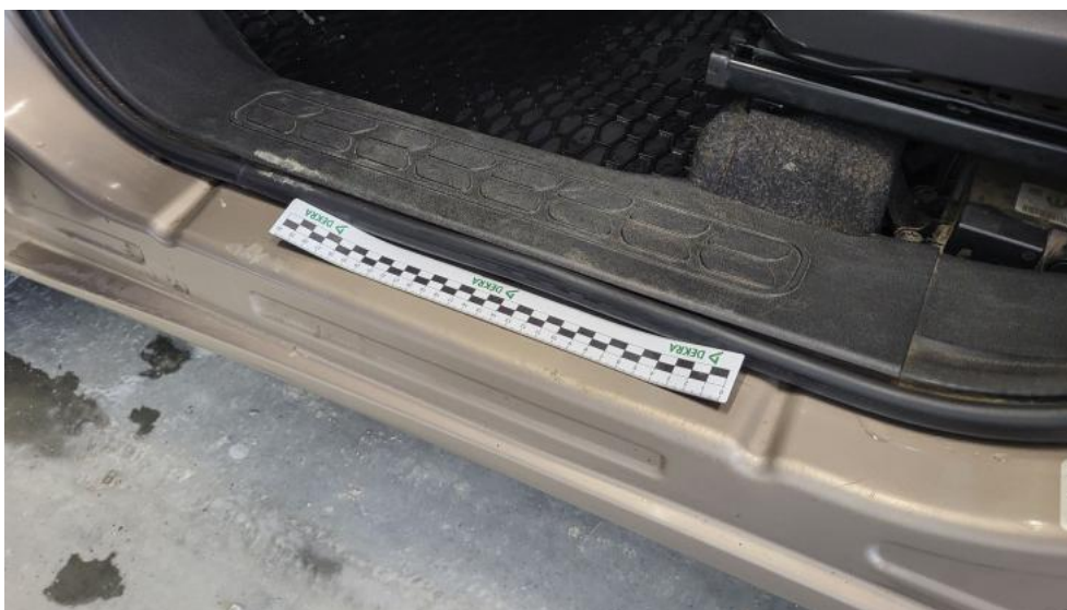
Fot. 67. Próg L - Rysa/odprysk 2
