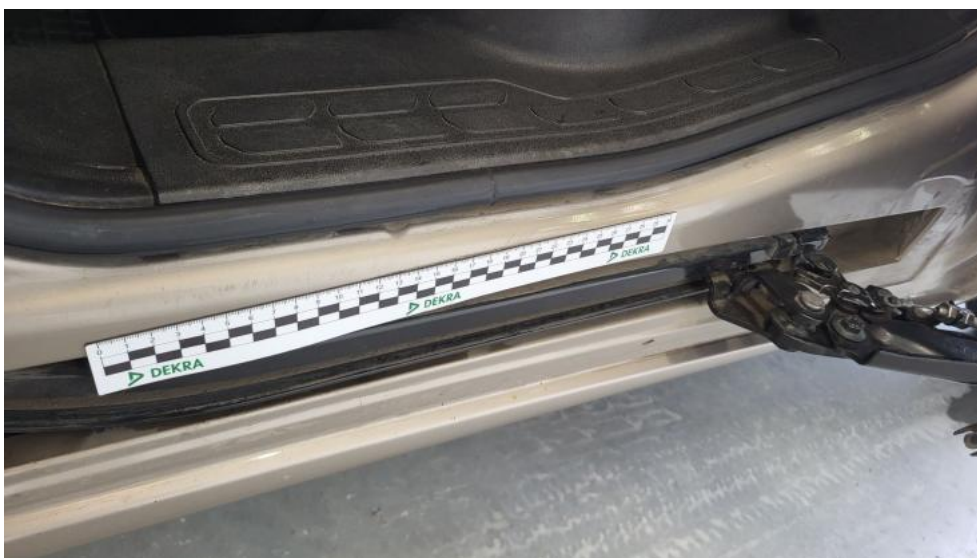
Fot. 66. Próg L - Rysa/odprysk 1
