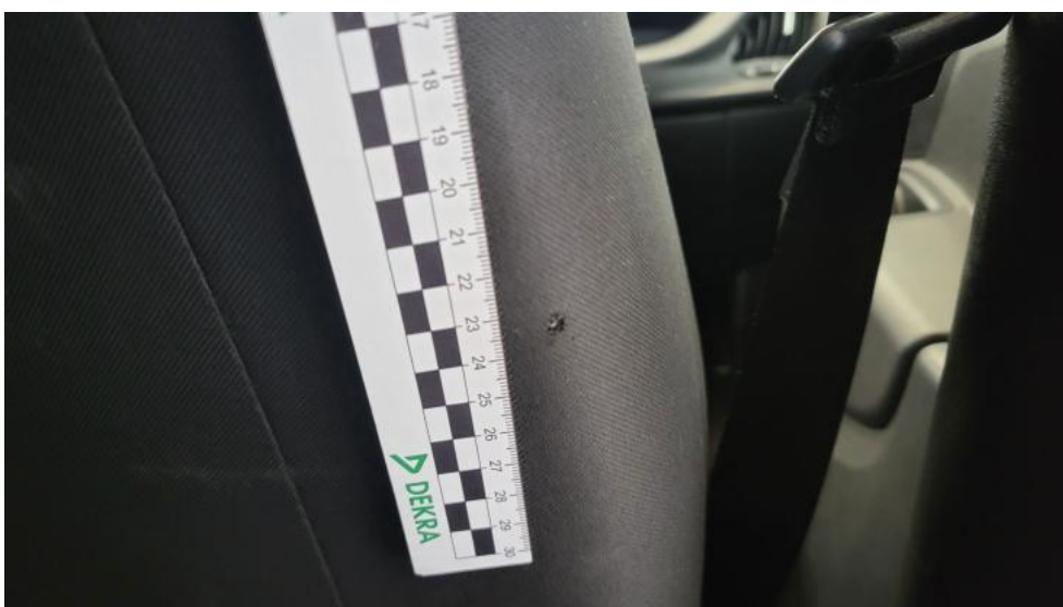
Fot. 72. Fotel prz. praw. - Pęknięcie/rozerwanie 1
