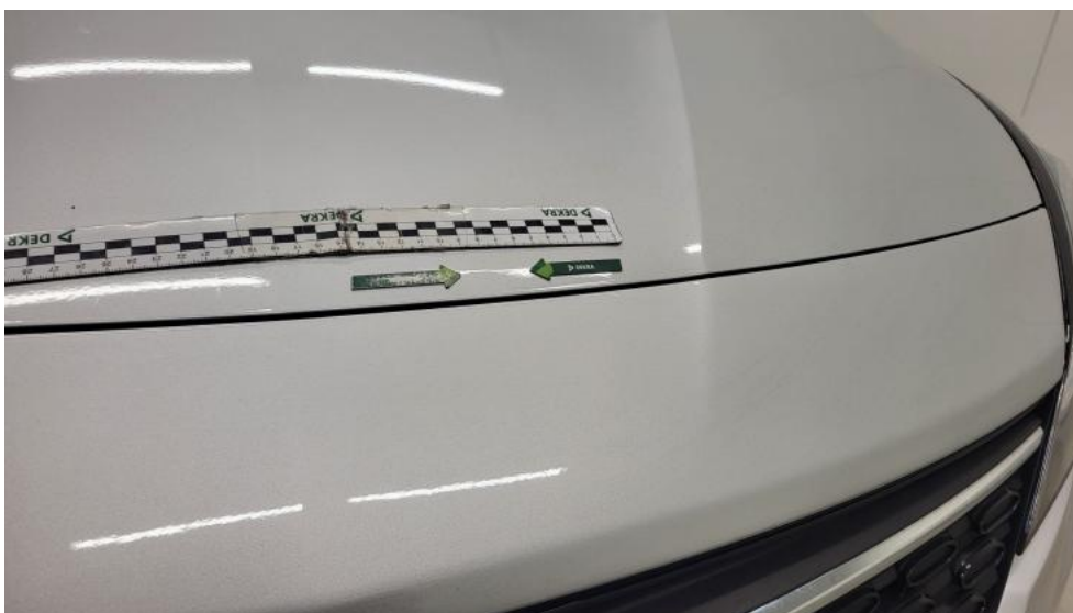
Fot. 38. Pokrywa komory silnika - Wgniecenie/odkształcenie 1
