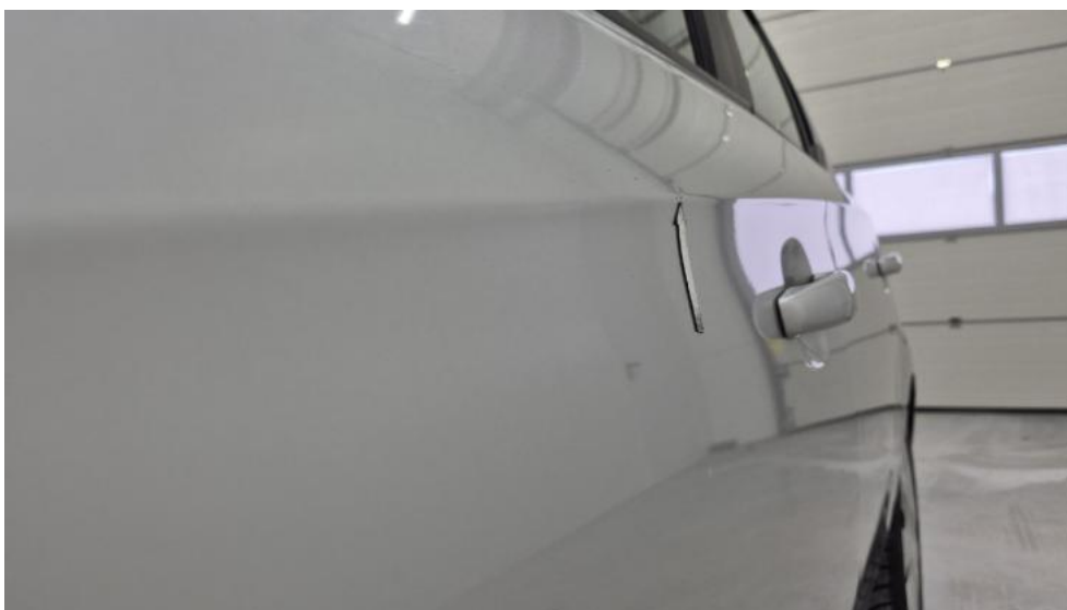
Fot. 53. Drzwi przed L - Wgniecenie/odkształcenie 1
