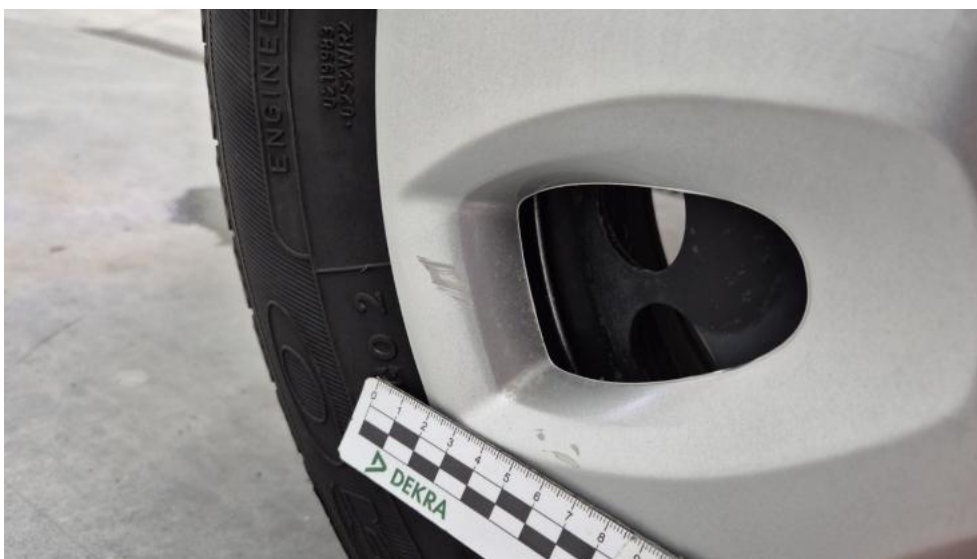
Fot. 45. Kołpak tylny P - Rysa/odprysk 1
