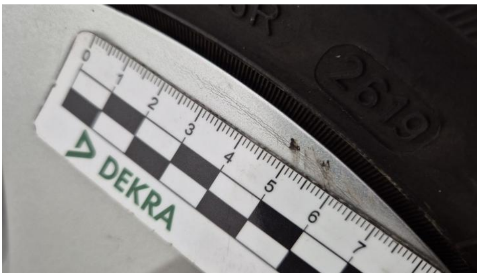
Fot. 37. Kołpak przedni P - Pęknięcie/rozerwanie 1
