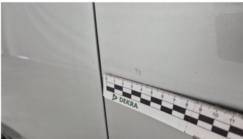
Fot. 39. Drzwi przednie P - Rysa/odprysk 1
