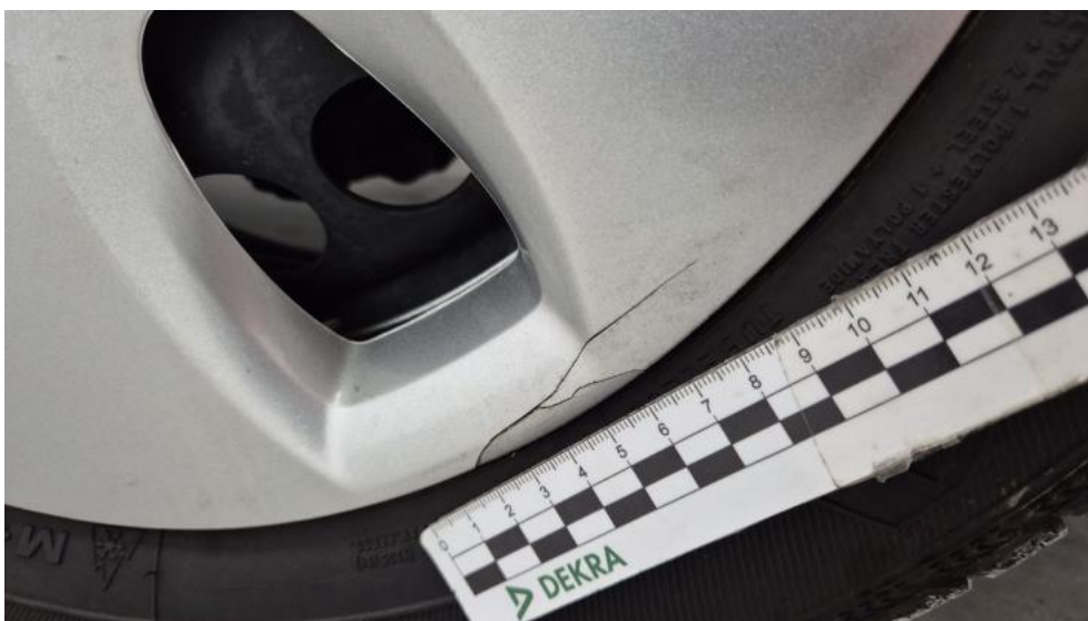
Fot. 38. Kołpak przedni P - Pęknięcie/rozerwanie 2
