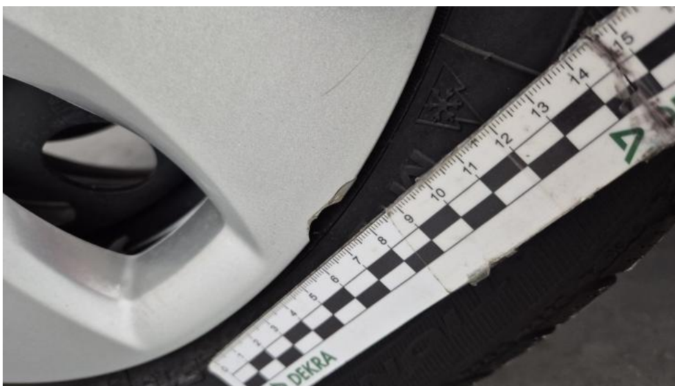
Fot. 46. Kołpak tylny P - Pęknięcie/rozerwanie 1
