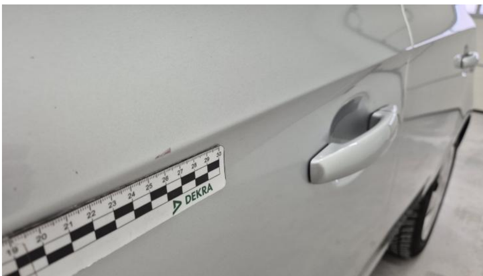
Fot. 52. Drzwi przed L - Rysa/odprysk 2
