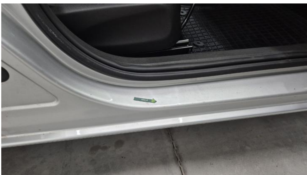
Fot. 42. Próg P - Wgniecenie/odkształcenie 1
