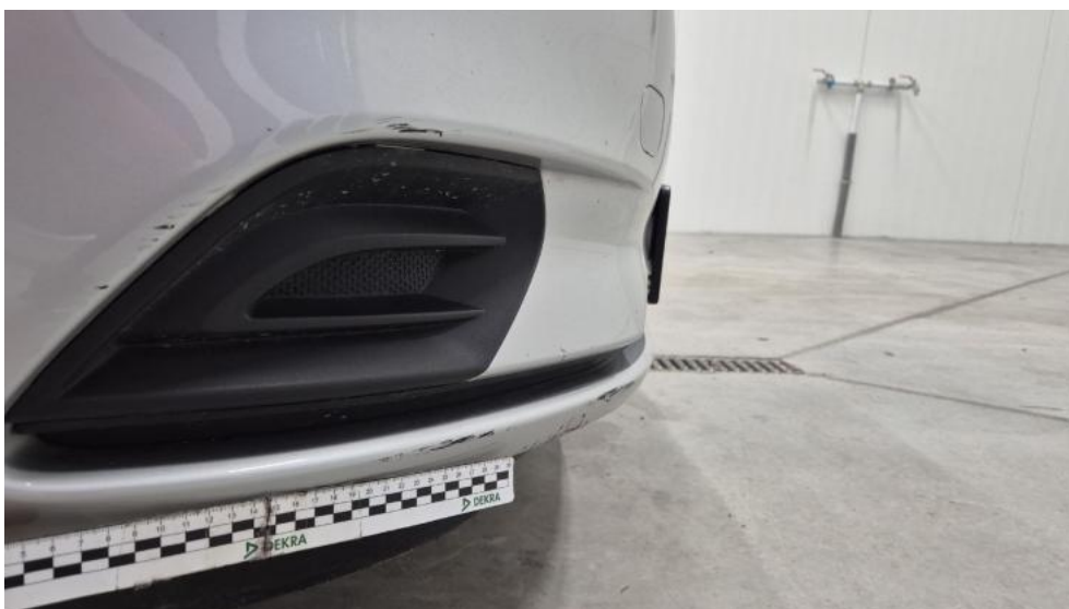
Fot. 34. Zderzak - Rysa/odprysk 1
