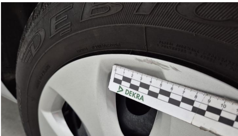
Fot. 50. Kołpak tylny L - Rysa/odprysk 1
