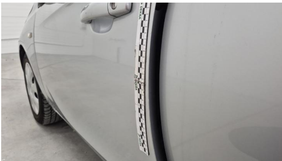
Fot. 51. Drzwi przed L - Rysa/odprysk 1
