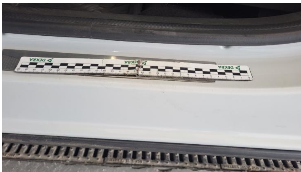
Fot. 51. Próg L - Rysa/odprysk 1
