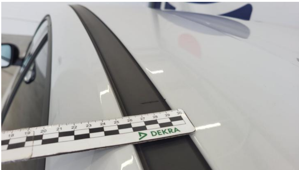
Fot. 47. Listwy dachu lew. - Rysa/odprysk 1
