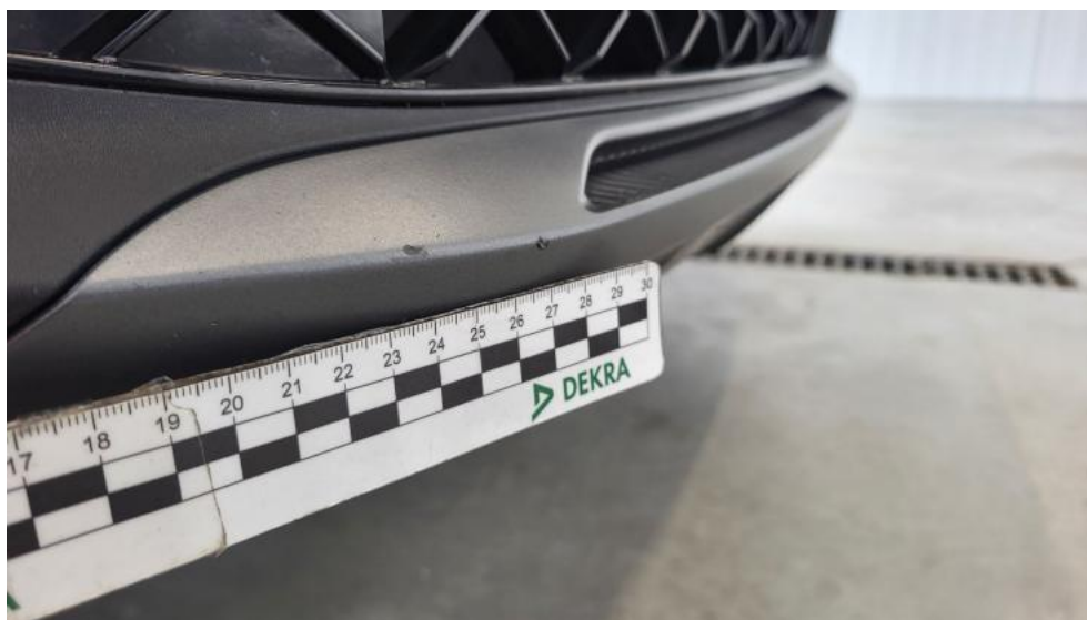
Fot. 41. Spoiler zderzaka przedniego - Rysa/odprysk 1
