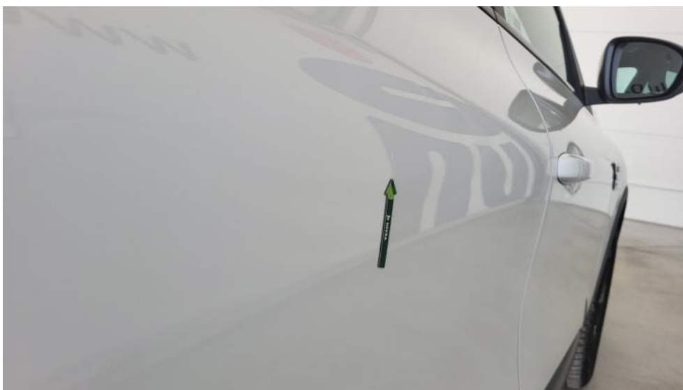
Fot. 43. Drzwi tylne P - Wgniecenie/odkształcenie 1
