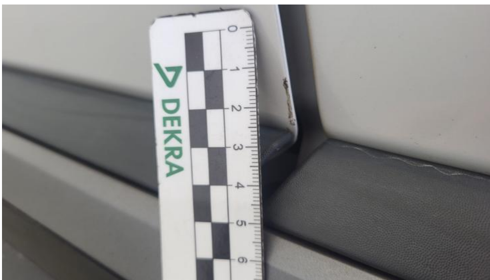
Fot. 49. Drzwi przed L - Rysa/odprysk 2
