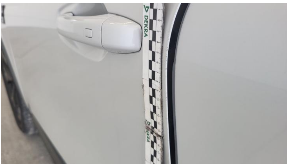
Fot. 48. Drzwi przed L - Rysa/odprysk 1
