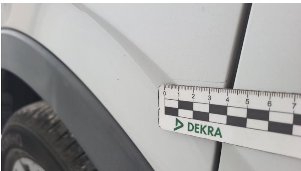
Fot. 44. Błotnik tylny P / Ściana boczna P - Rysa/odprysk 1
