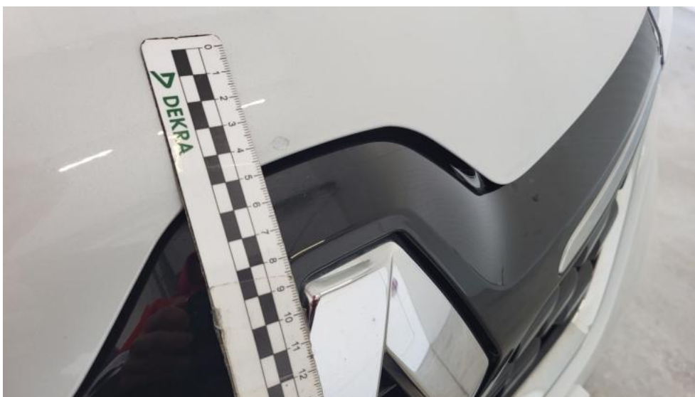
Fot. 40. Pokrywa komory silnika - Rysa/odprysk 1
