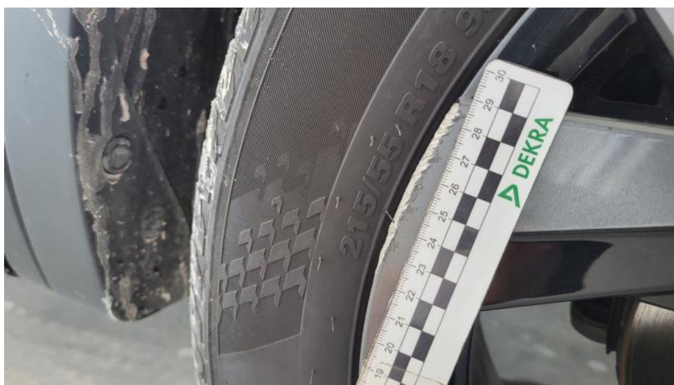
Fot. 42. Felga aluminiowa przednia P - Rysa/odprysk 1
