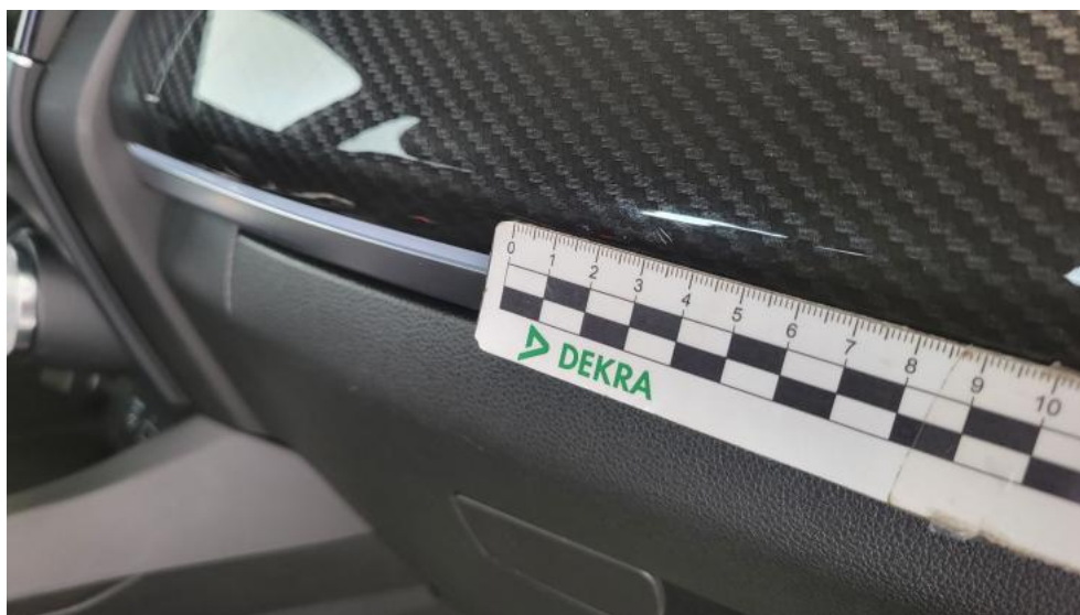
Fot. 52. Deska rozdzielcza - Rysa/odprysk 1
