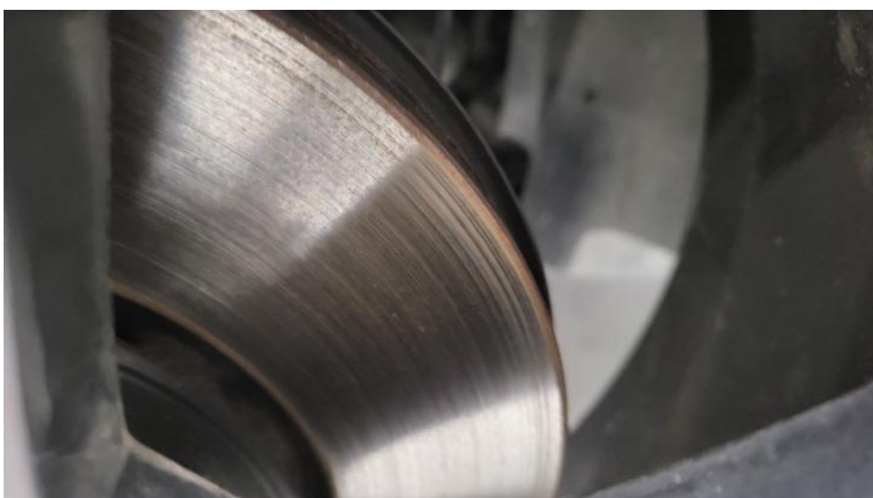
Fot. 18. Tarcza hamulcowa przednia lewa
