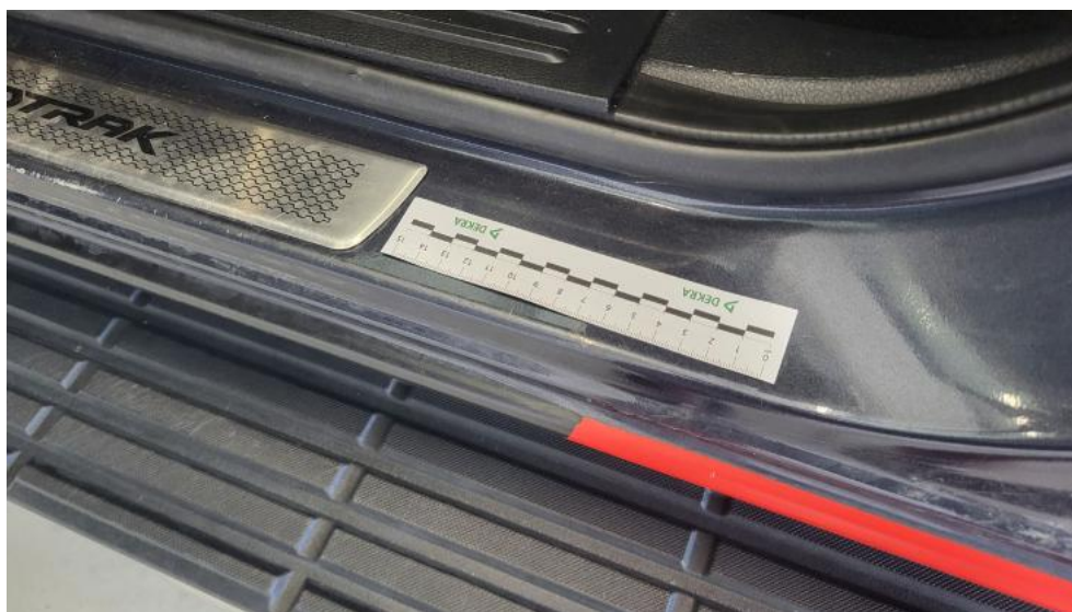
Fot. 55. Próg L - Rysa/odprysk 1
