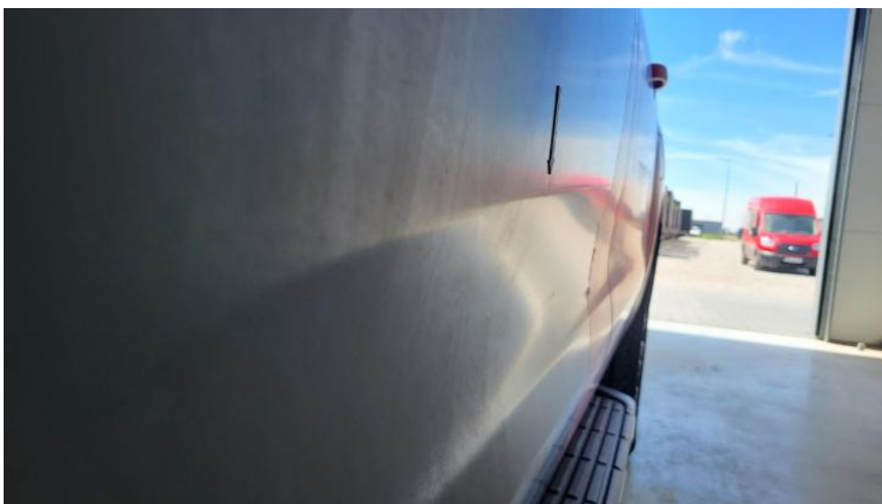
Fot. 54. Drzwi przed L - Wgniecenie/odkształcenie 1
