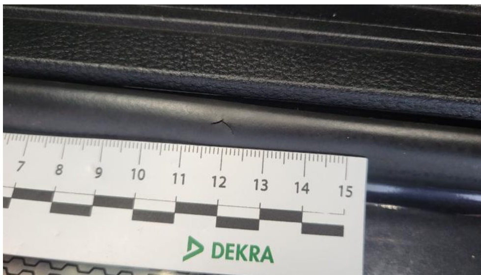
Fot. 59. Uszczelka drzwi przednich L - Pęknięcie/rozerwanie 1
