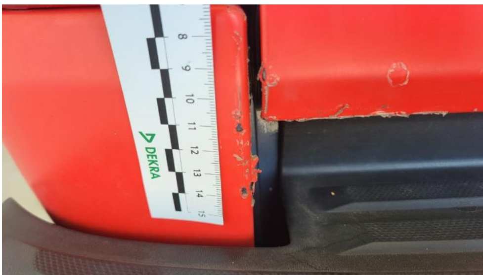
Fot. 52. Błotnik tylny L / Ściana boczna L - Rysa/odprysk 1
