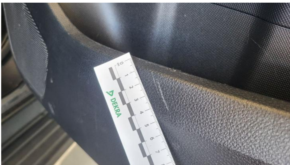
Fot. 58. Tapicerka drzwi tylnych P - Rysa/odprysk 1
