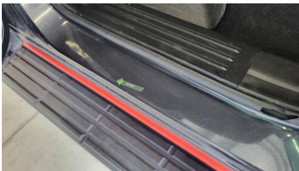
Fot. 56. Próg L - Wgniecenie/odkształcenie 1
