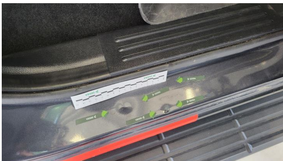
Fot. 44. Próg P - Wgniecenie/odkształcenie 1
