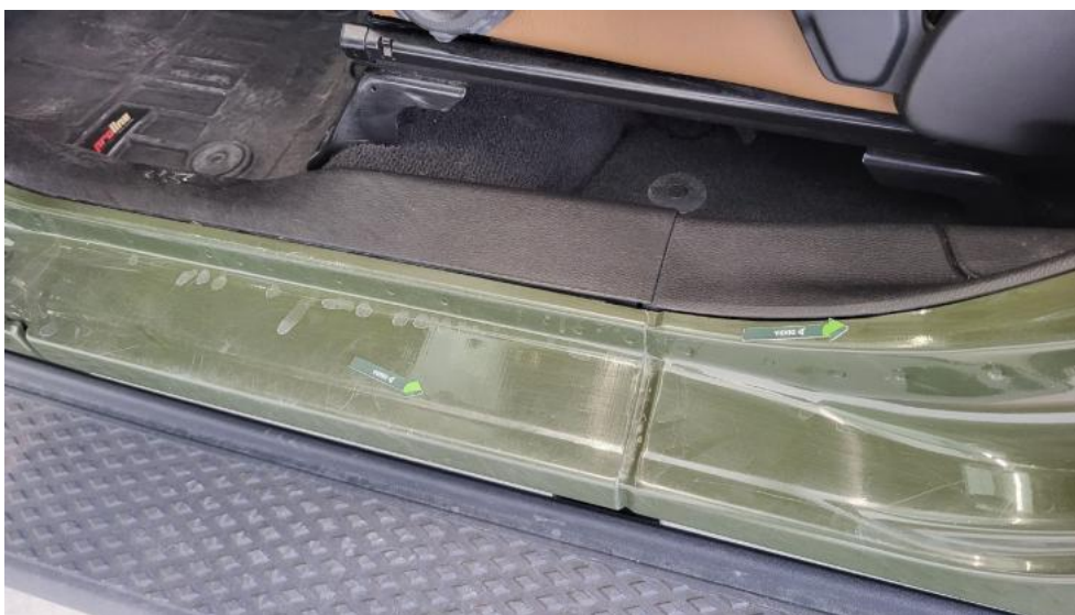
Fot. 67. Próg L - Wgniecenie/odkształcenie 1
