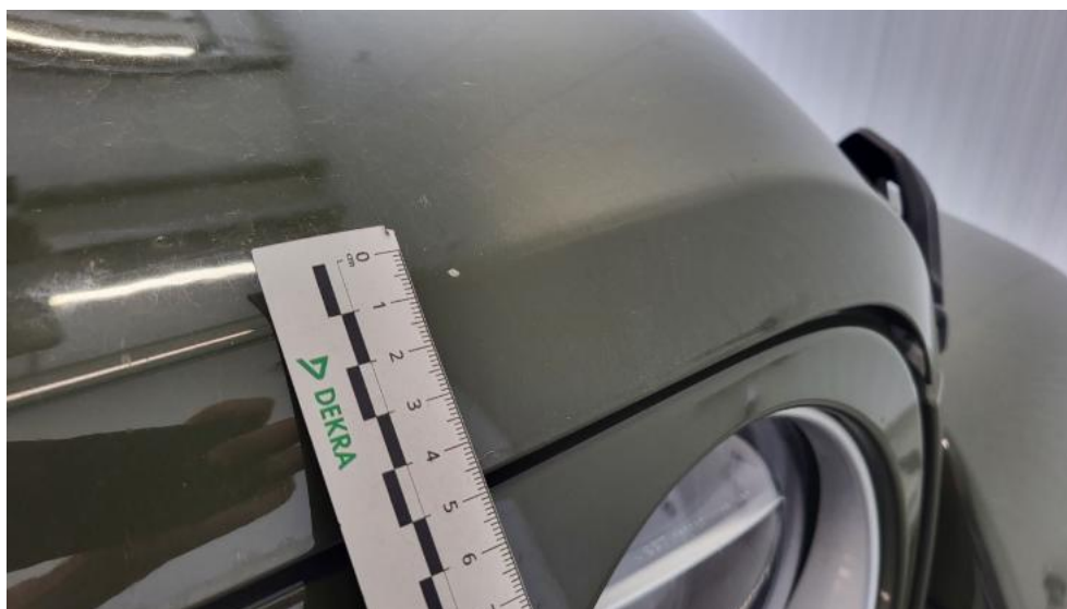
Fot. 41. Pokrywa komory silnika - Rysa/odprysk 1
