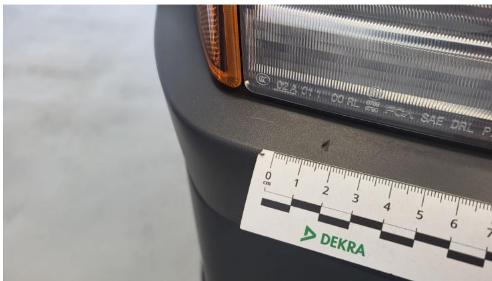
Fot. 45. Zderzak przedni cz P - Rysa/odprysk 1
