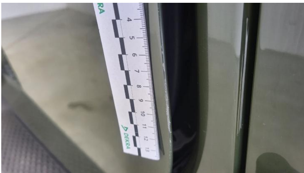
Fot. 62. Drzwi przed L - Rysa/odprysk 1
