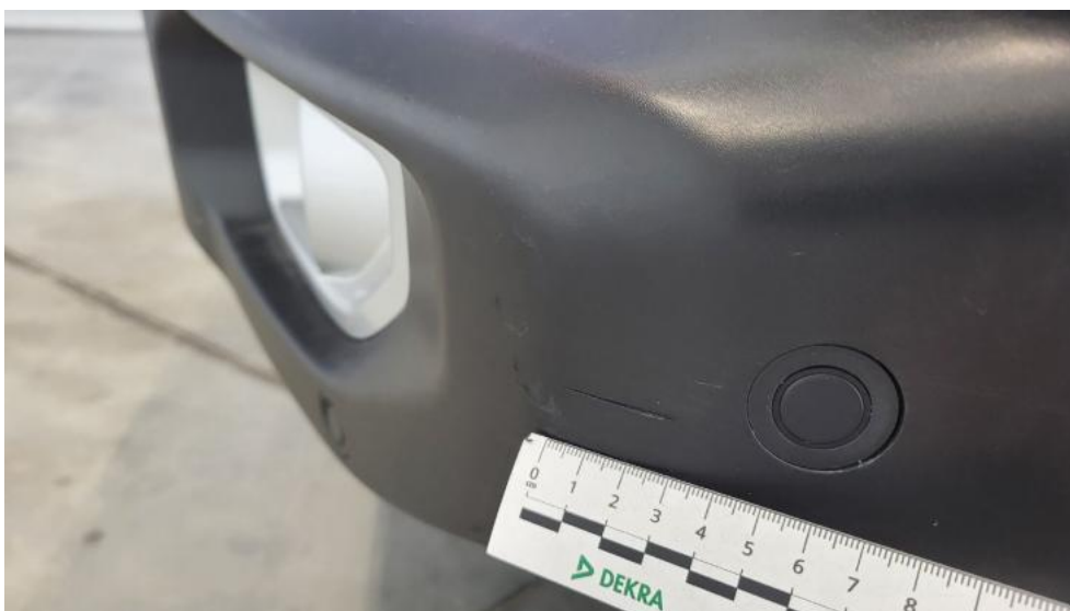
Fot. 44. Zderzak - Rysa/odprysk 1
