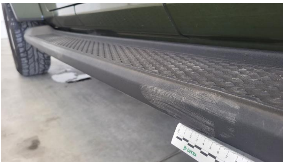
Fot. 66. Próg L - Rysa/odprysk 2
