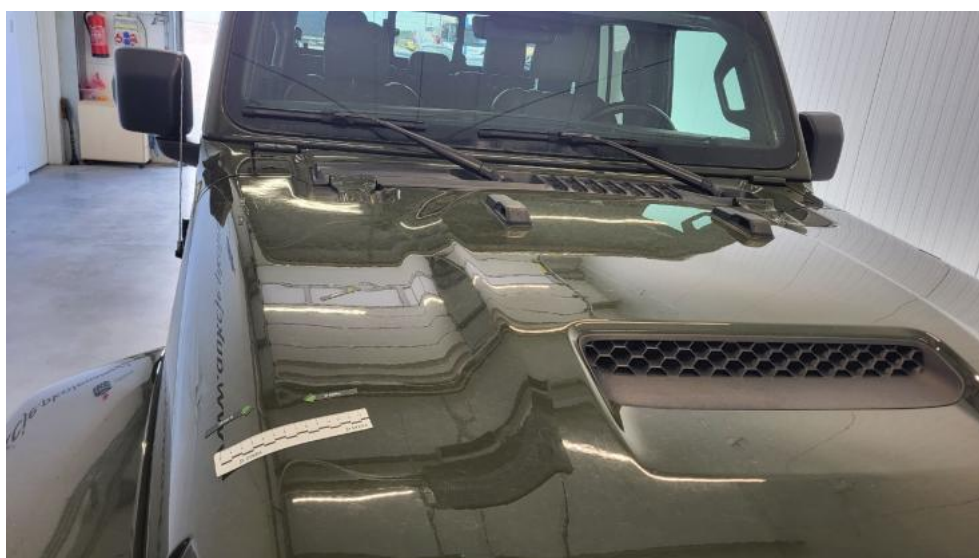
Fot. 42. Pokrywa komory silnika - Wgniecenie/odkształcenie 1
