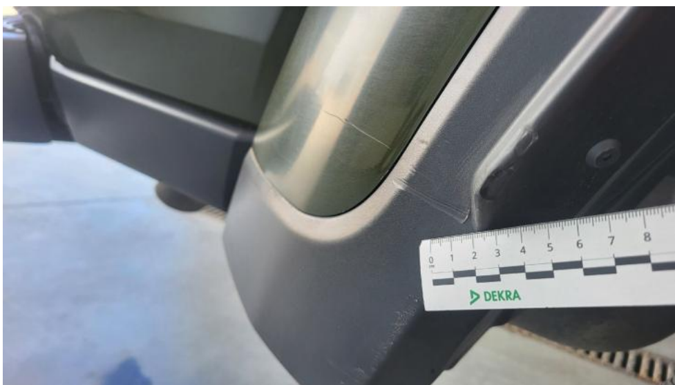
Fot. 56. Listwa krawędzi błotnika tył P - Wgniecenie/odkształcenie 1
