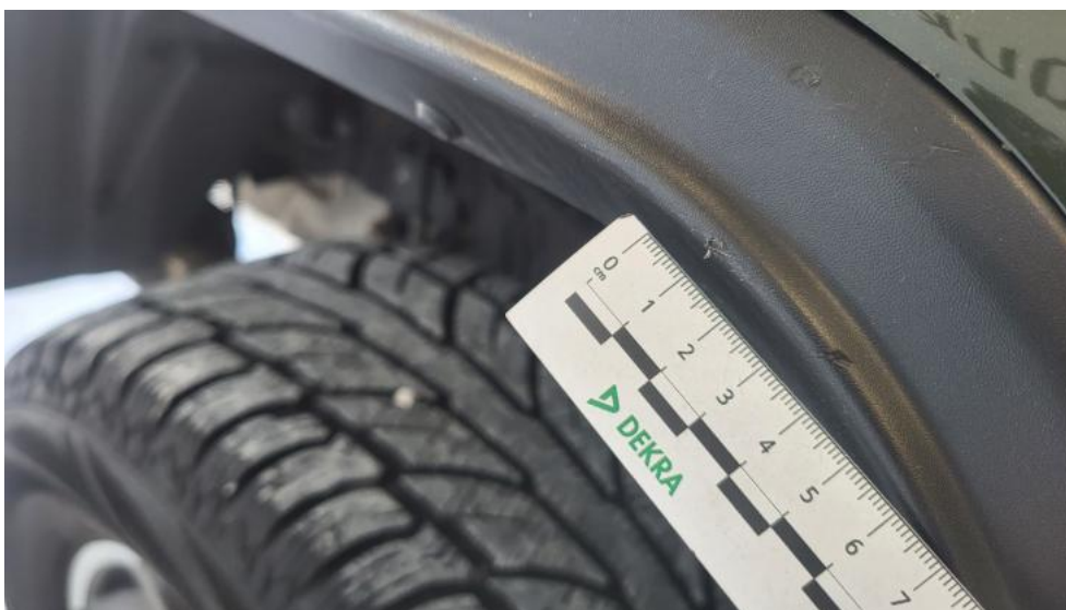
Fot. 55. Listwa krawędzi błotnika tył P - Rysa/odprysk 1
