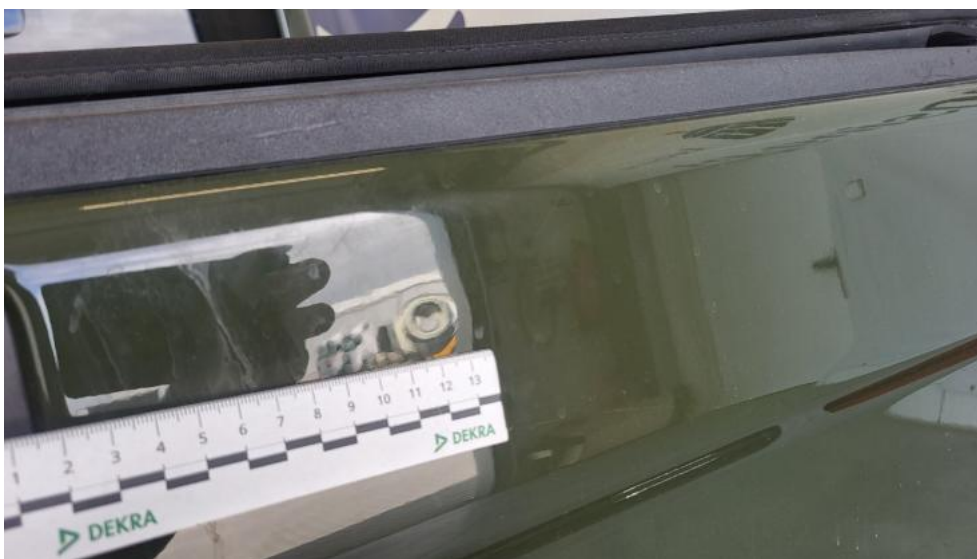
Fot. 57. Pokrywy bagażnika - Wgniecenie/odkształcenie 1
