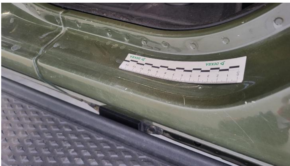
Fot. 65. Próg L - Rysa/odprysk 1
