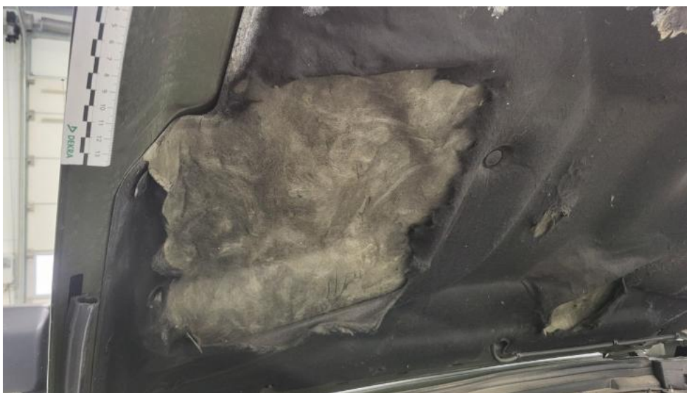
Fot. 43. Wykładzina pokrywy komory silnika - Pęknięcie/rozerwanie 1
