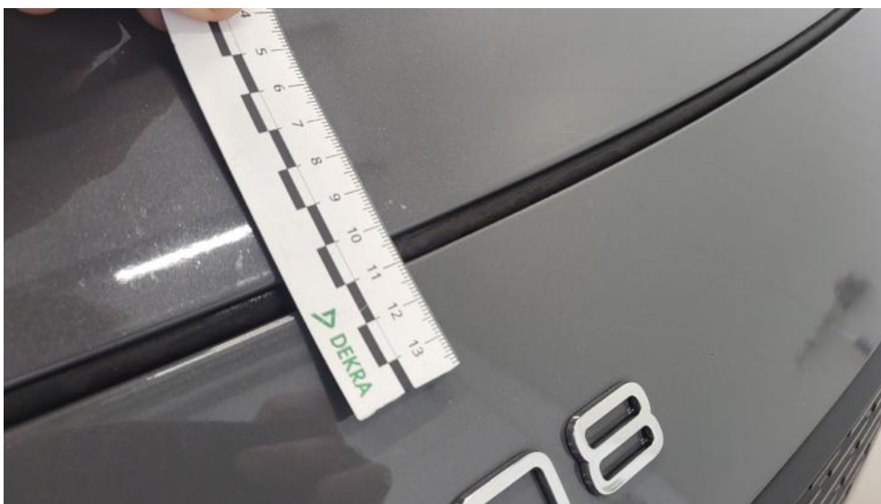
Photo 37. Pokrywa komory silnika - Rysa/odprysk 1
