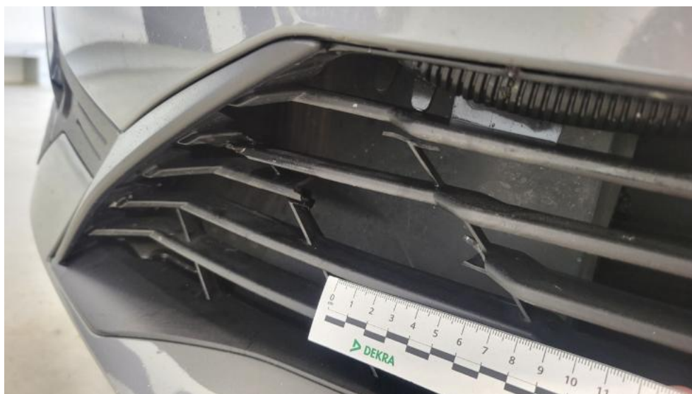
Photo 36. Krata zderzaka prz. - Pęknięcie/rozerwanie 1
