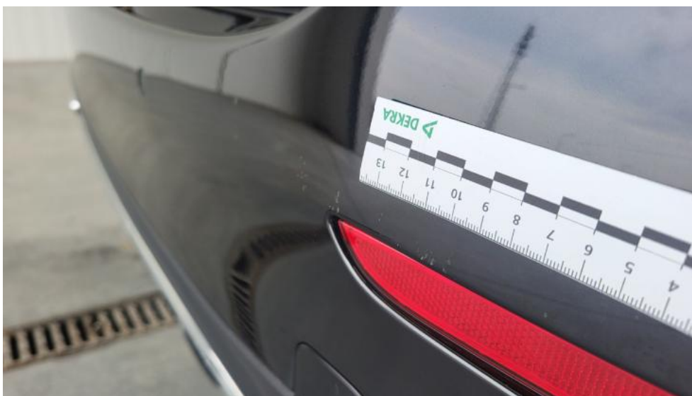
Fot. 57. Zderzak tylny - Rysa/odprysk 1
