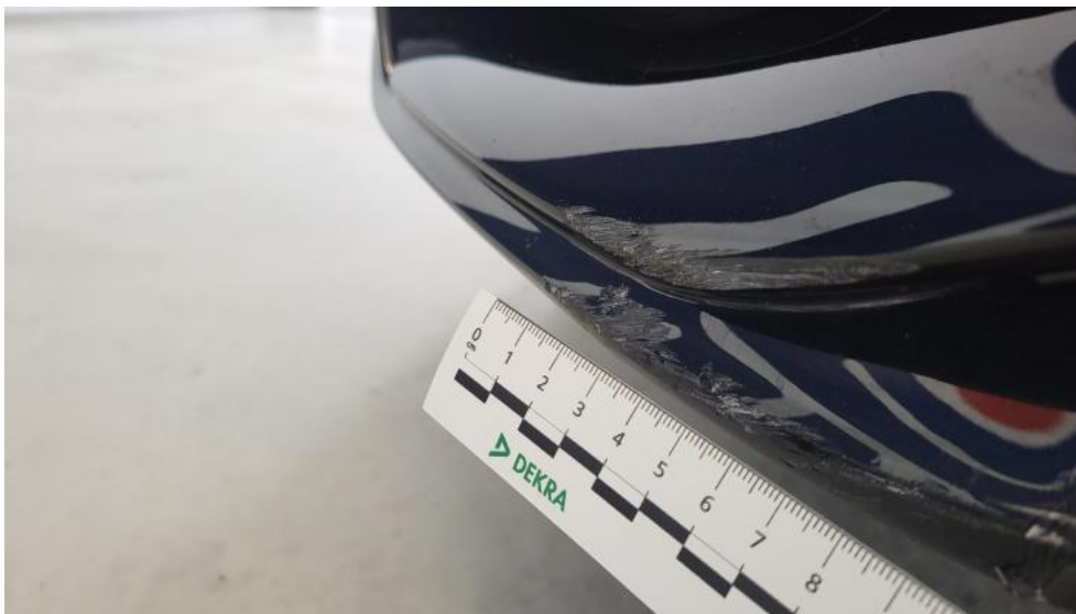
Fot. 53. Zderzak - Wgniecenie/odkształcenie 1
