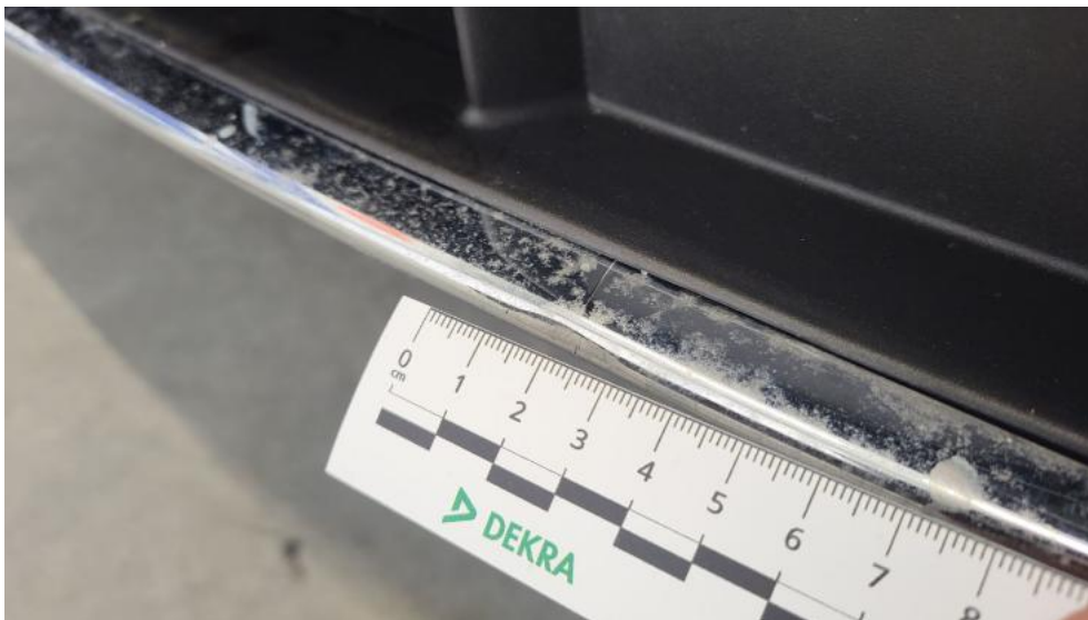
Fot. 49. Spoiler zderzaka przedniego - Wgniecenie/odkształcenie 1
