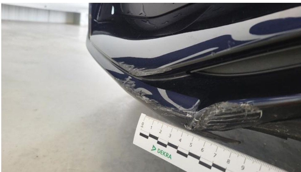
Fot. 52. Zderzak - Rysa/odprysk 1
