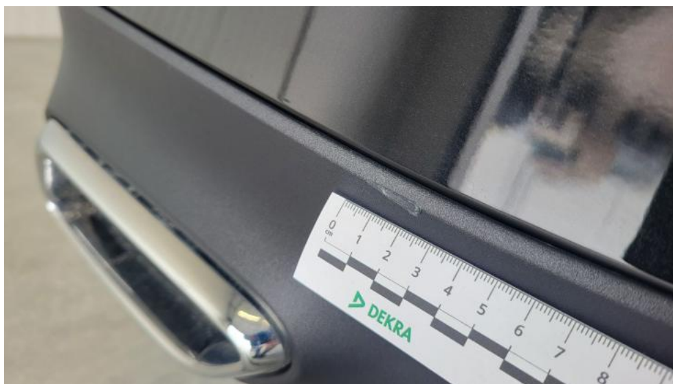
Fot. 59. Zderzak tylny cz dolna - Rysa/odprysk 1
