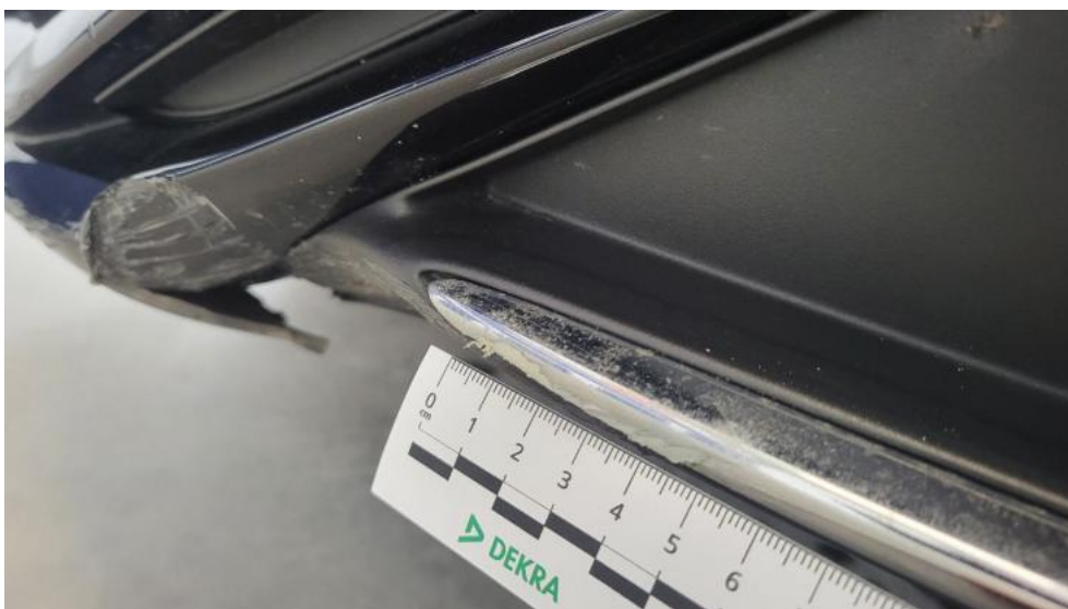
Fot. 50. Spoiler zderzaka przedniego - Wgniecenie/odkształcenie 2
