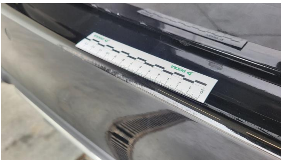
Fot. 58. Zderzak tylny - Rysa/odprysk 2
