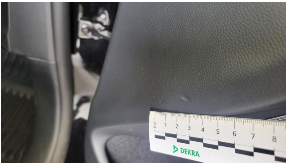
Fot. 65. Tapicerka drzwi przednich P - Wgniecenie/odkształcenie 1
