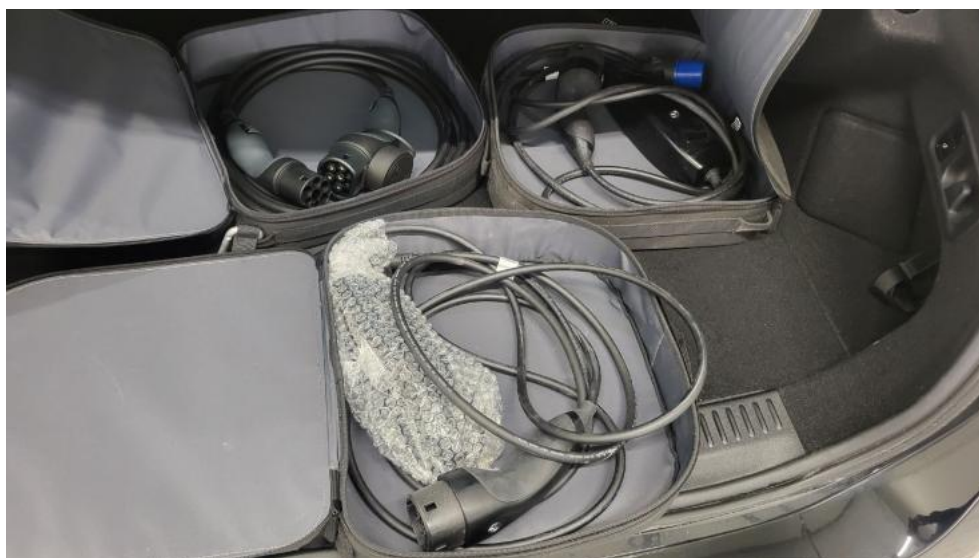
Fot. 36. Przewód ładowania baterii trakcyjnej
