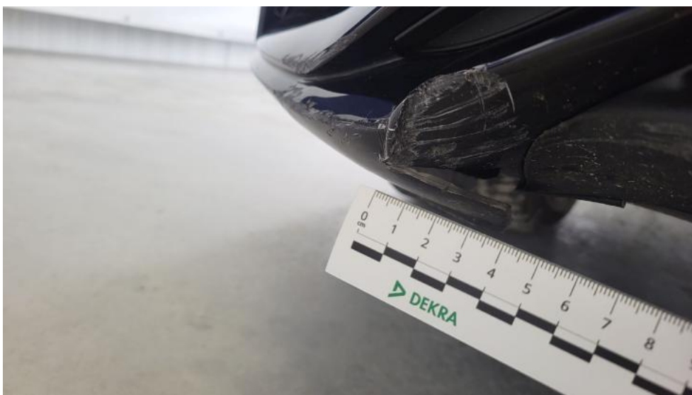
Fot. 54. Zderzak - Pęknięcie/rozerwanie 1
