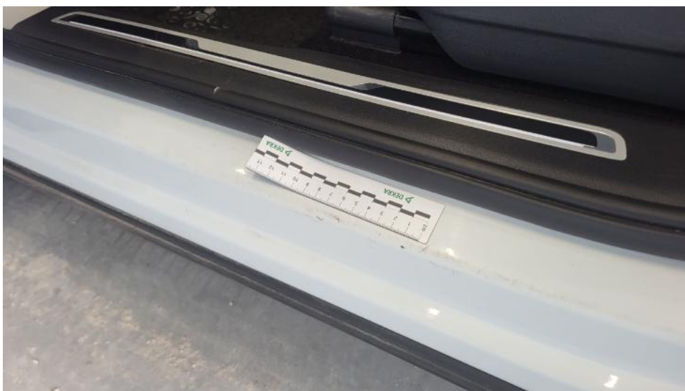
Photo 78. Próg L - Rysa/odprysk 2
