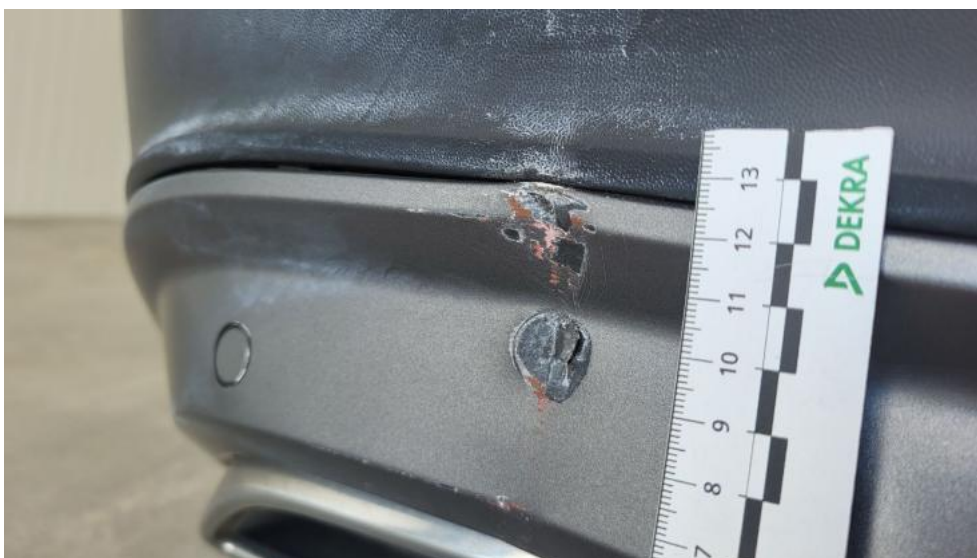
Photo 60. Spojler zderzaka tylnego - Pęknięcie/rozerwanie 1
