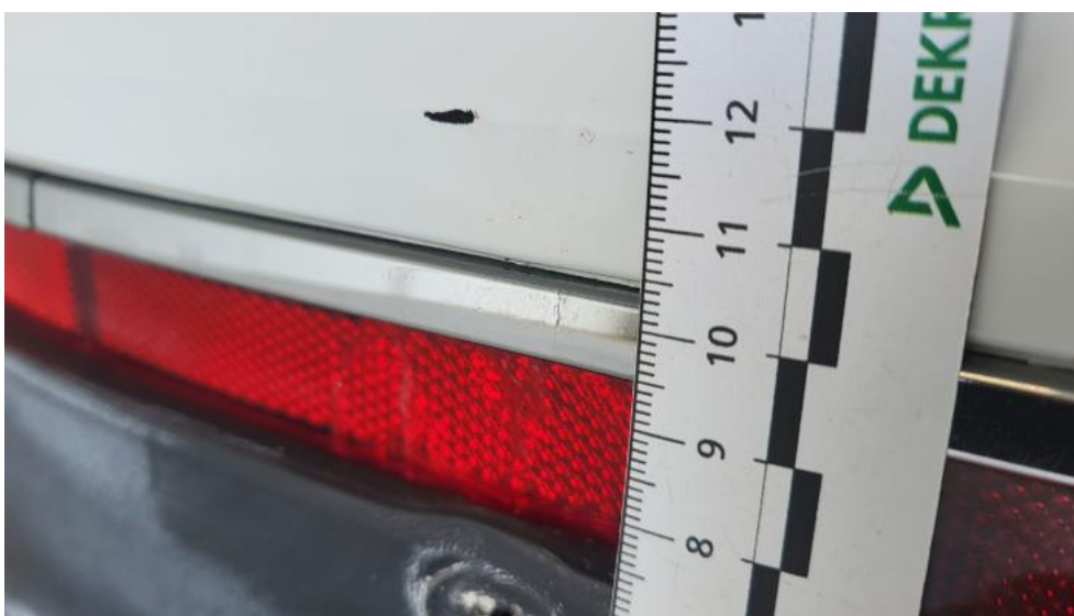
Photo 58. Listwa śr zderzaka tylnego - Pęknięcie/rozerwanie 1
