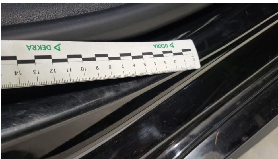
Fot. 59. Próg P - Rysa/odprysk 1
