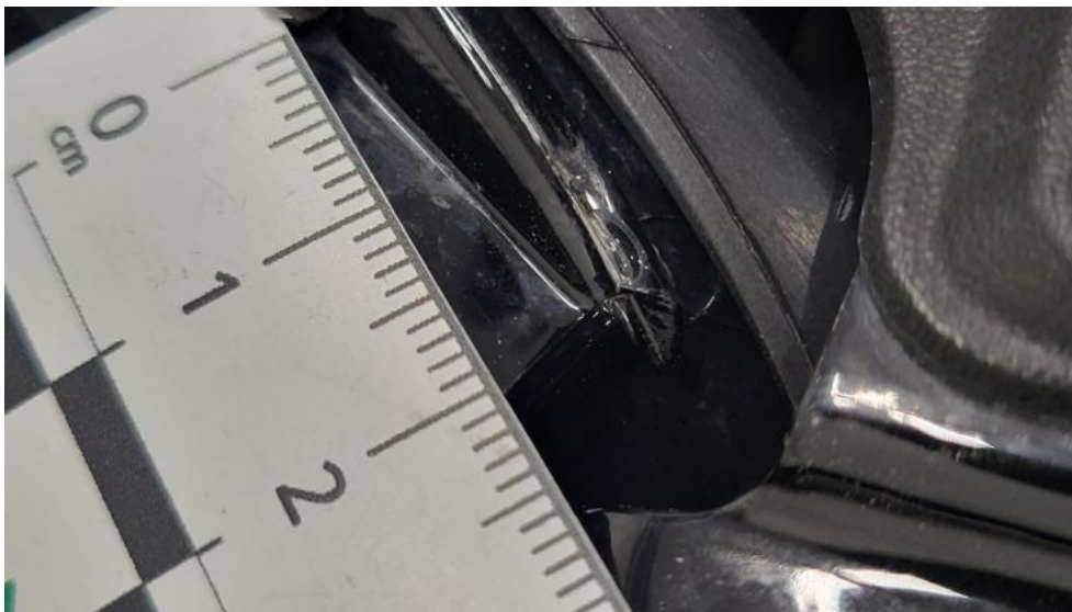
Fot. 85. Reflektor L - Pęknięcie/rozerwanie 1
