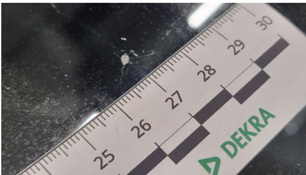
Fot. 48. Szyba czołowa - Pęknięcie/rozerwanie 1
