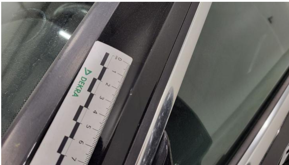
Fot. 79. Stupek przedni L - Rysa/odprysk 1
