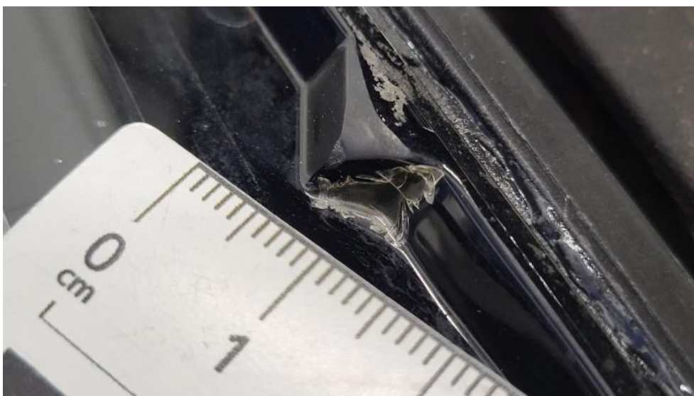
Fot. 52. Reflektor P - Pęknięcie/rozerwanie 1
