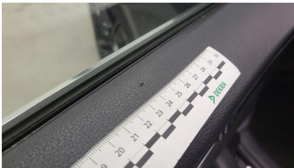
Fot. 91. Tapicerka drzwi przednich L - Rysa/odprysk 1
