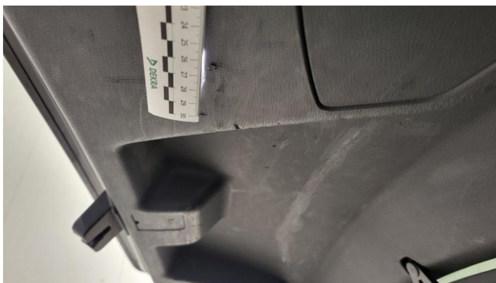
Fot. 98. Wykładzina pokrywy tylnej - Rysa/odprysk 1
