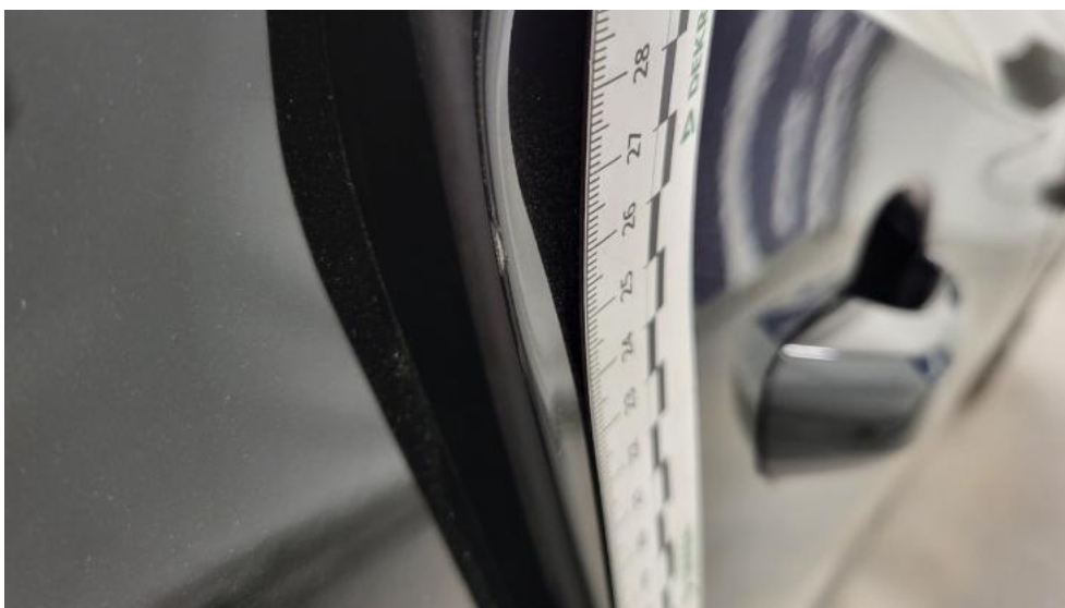
Fot. 56. Drzwi tylne P - Rysa/odprysk 1
