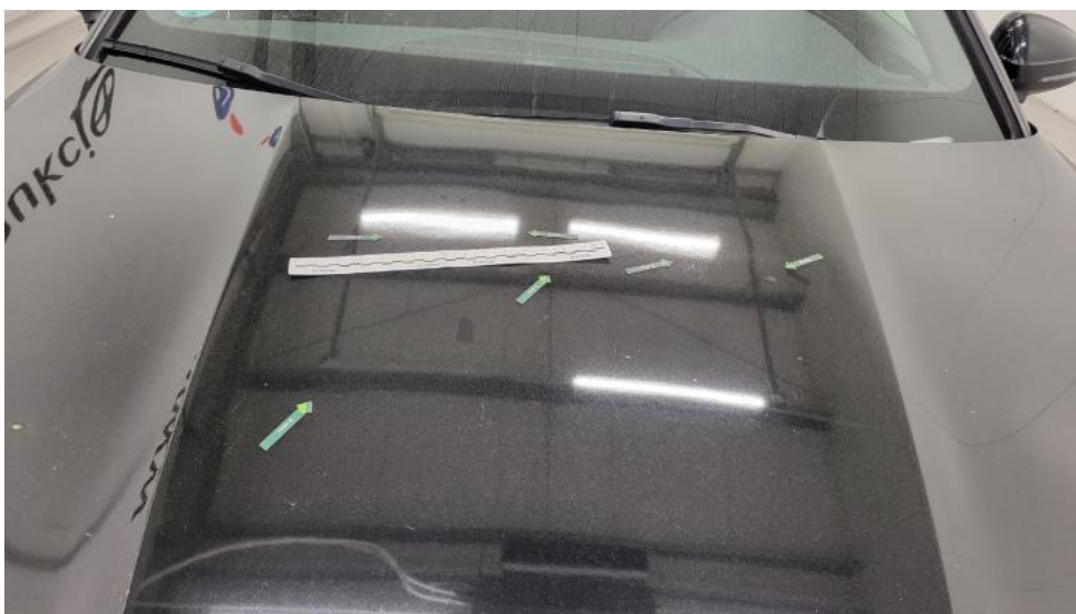
Fot. 46. Pokrywa komory silnika - Wgniecenie/odkształcenie 1
