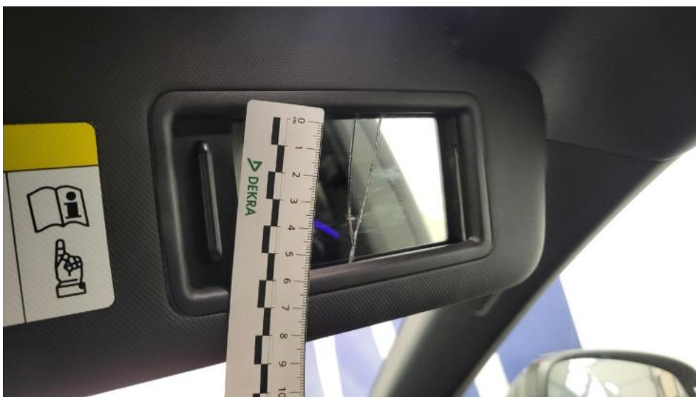
Fot. 93. Osłona p/słoneczna prawa - Pęknięcie/rozerwanie 1
