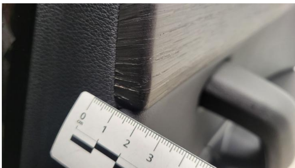
Fot. 92. Tapicerka drzwi tylnych P - Pęknięcie/rozerwanie 1
