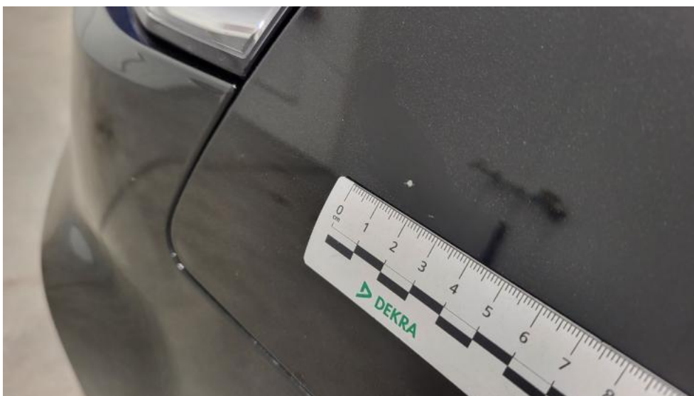
Fot. 80. Błotnik przedni L - Rysa/odprysk 1
