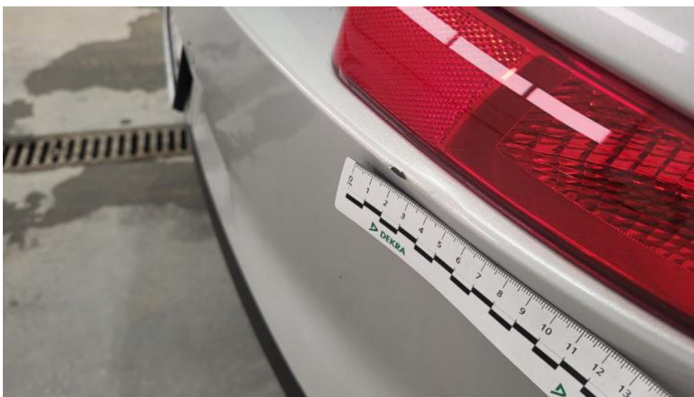
Fot. 59. Zderzak tylny - Wgniecenie/odkształcenie 1
