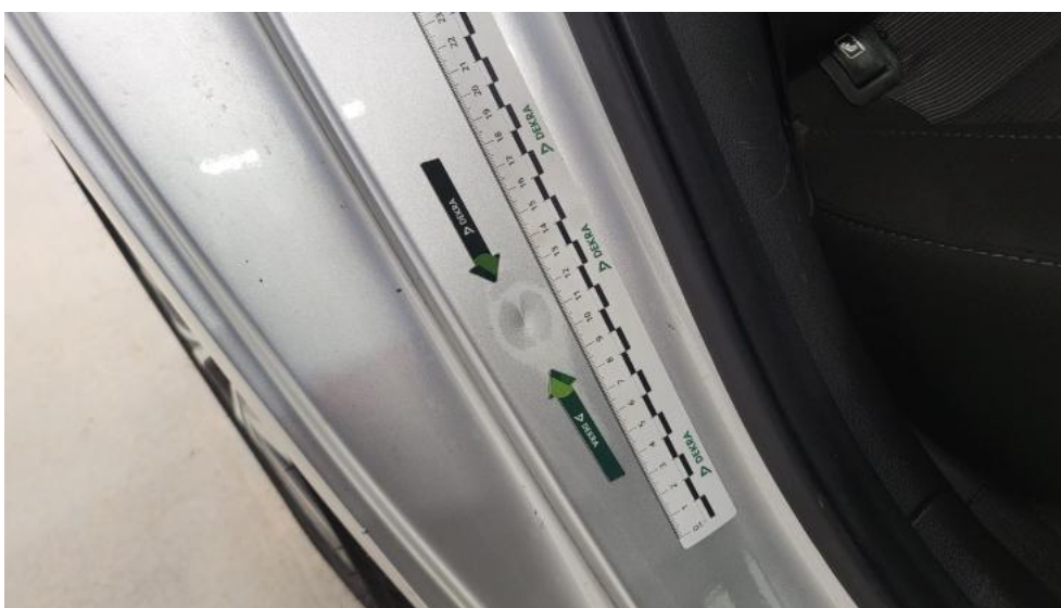
Fot. 54. Błotnik tylny P / Ściana boczna P - Wgniecenie/odkształcenie 1
