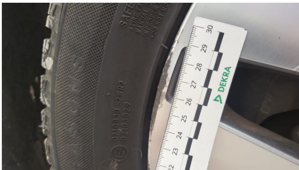
Fot. 73. Felga Aluminiowa przednia L - Rysa/odprysk 1
