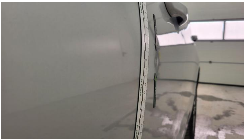
Fot. 63. Drzwi przed L - Wgniecenie/odkształcenie 1
