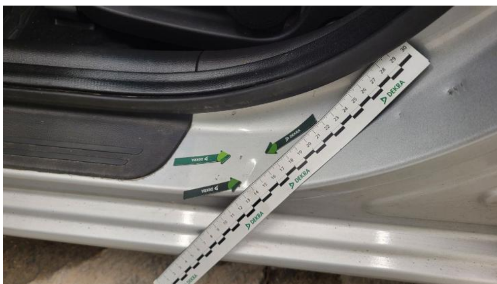
Fot. 68. Próg L - Wgniecenie/odkształcenie 1
