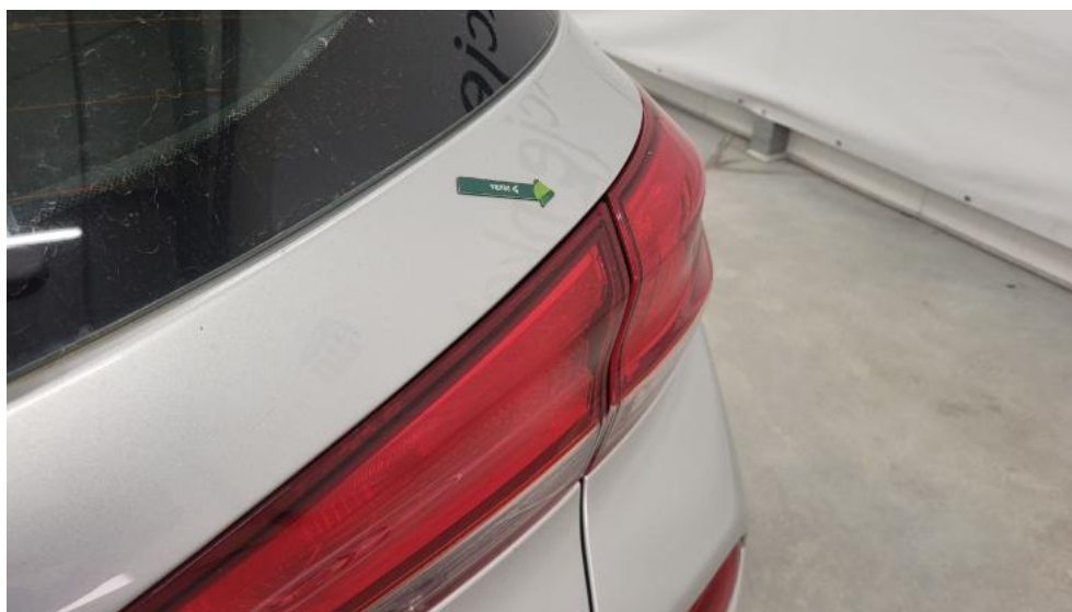
Fot. 57. Pokrywy bagażnika - Wgniecenie/odkształcenie 1
