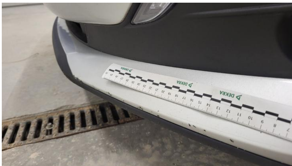
Fot. 44. Zderzak - Rysa/odprysk 2
