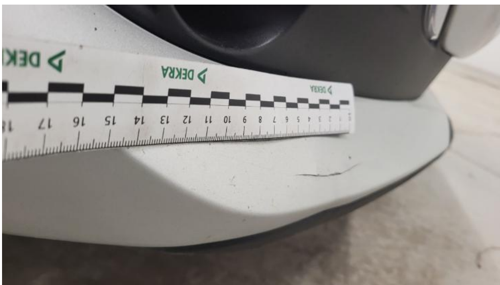
Fot. 46. Zderzak - Wgniecenie/odkształcenie 1
