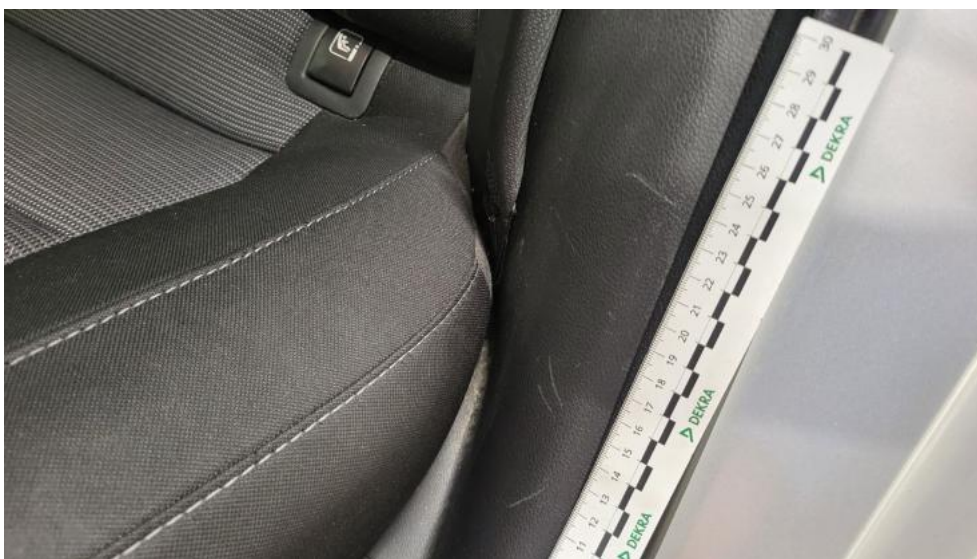
Fot. 85. Wykładzina(y) słupka tylnego L - Rysa/odprysk 1
