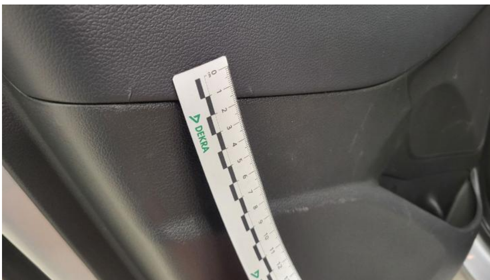
Fot. 81. Tapicerka drzwi tylnych L - Wgniecenie/odkształcenie 1
