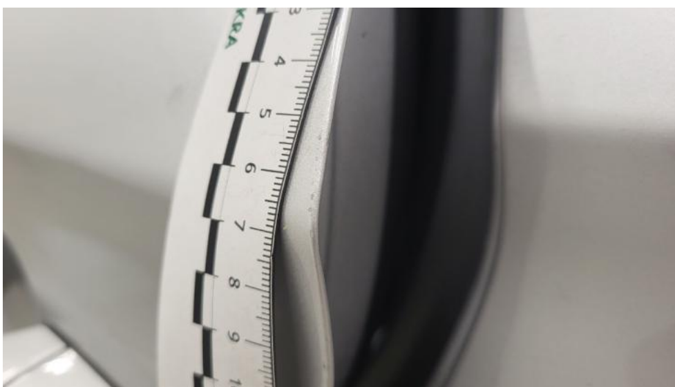
Fot. 64. Drzwi tylne L - Rysa/odprysk 1
