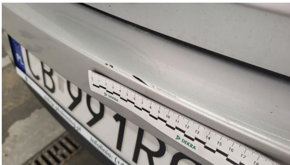
Fot. 58. Zderzak tylny - Rysa/odprysk 1
