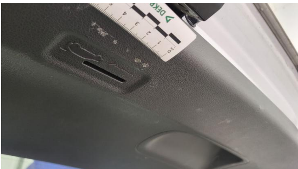
Fot. 88. Wykładzina pokrywy tylnej - Rysa/odprysk 1
