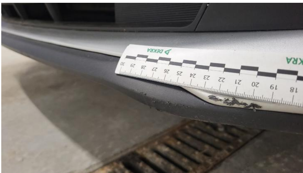
Fot. 41. Spoiler zderzaka przedniego - Rysa/odprysk 1
