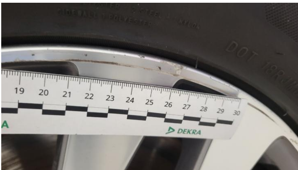
Fot. 48. Felga aluminiowa przednia P - Rysa/odprysk 1
