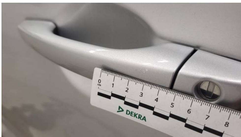
Fot. 66. Klamka drzwi prz L - Rysa/odprysk 1
