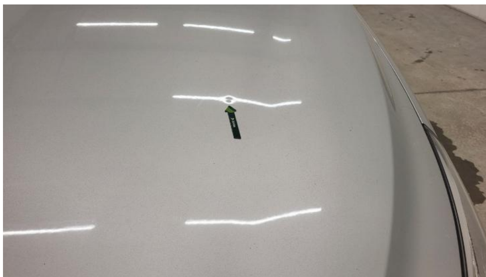
Fot. 39. Pokrywa komory silnika - Wgniecenie/odkształcenie 1
