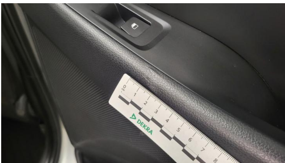
Fot. 82. Tapicerka drzwi tylnych P - Wgniecenie/odkształcenie 1
