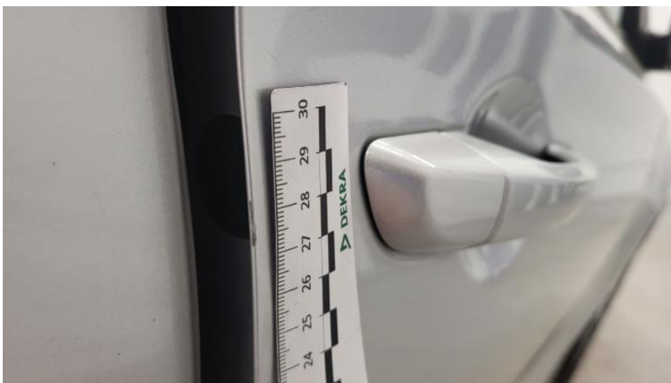
Fot. 50. Drzwi przednie P - Rysa/odprysk 2
