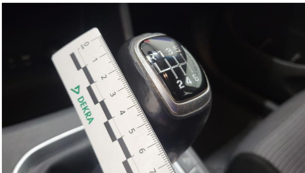
Fot. 74. Gałka dźwigni zmiany biegów - Rysa/odprysk 1
