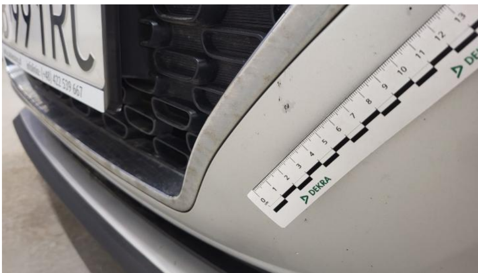
Fot. 45. Zderzak() - Rysa/odprysk 3
