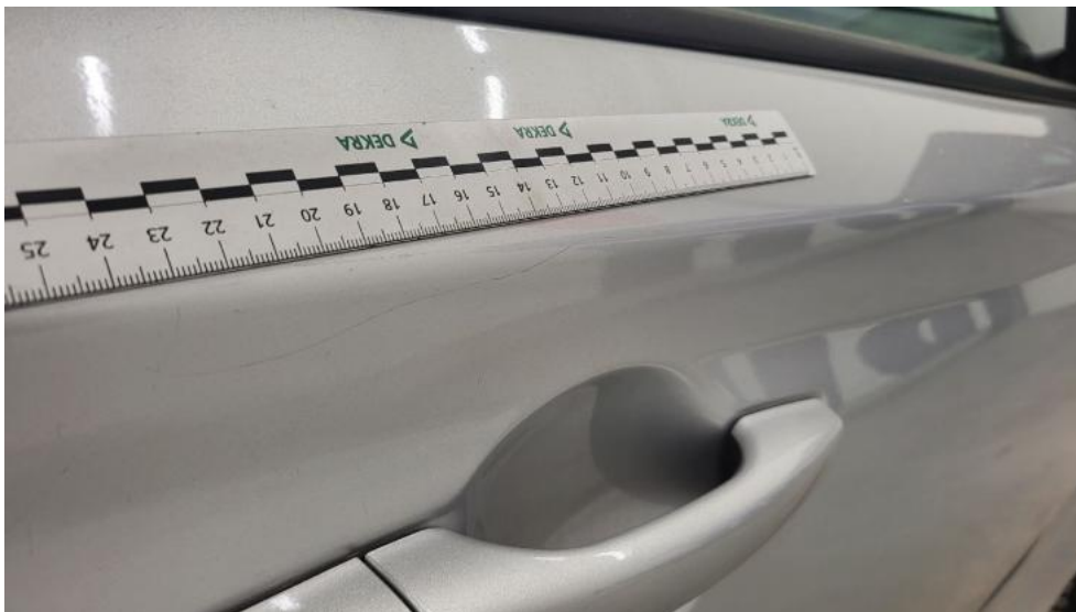
Fot. 49. Drzwi przednie P - Rysa/odprysk 1
