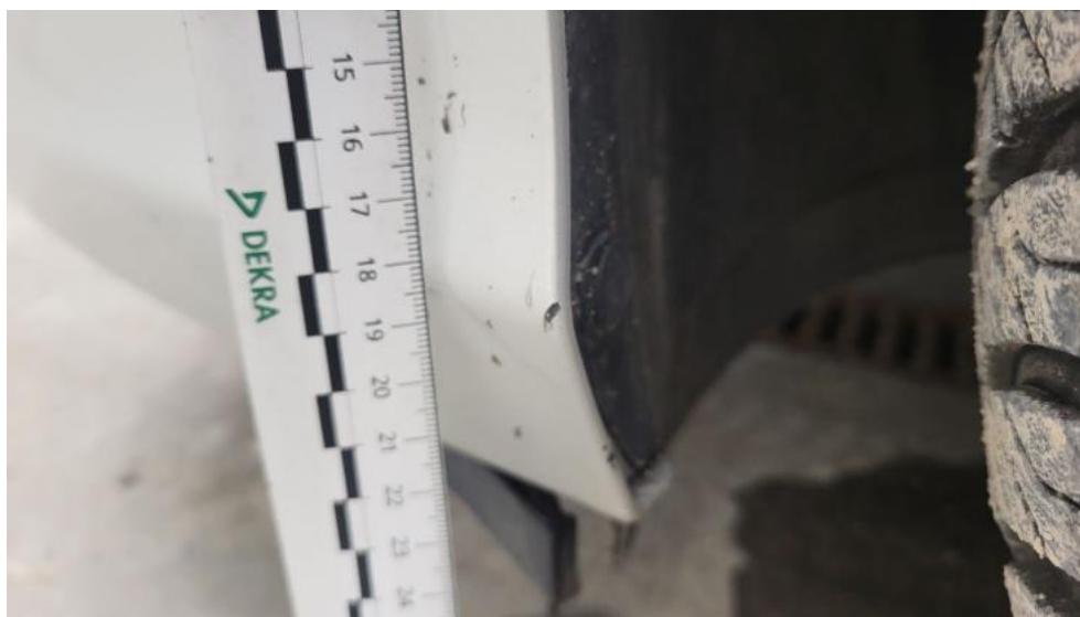
Fot. 43. Zderzak - Rysa/odprysk 1
