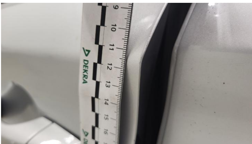
Fot. 62. Drzwi przed L - Rysa/odprysk 1
