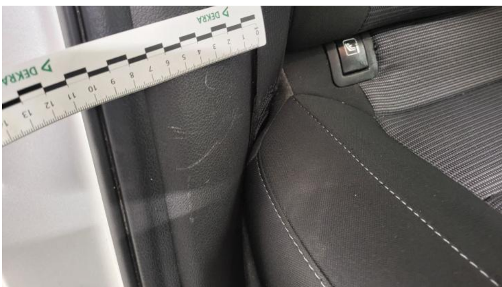
Fot. 86. Wykładzina(y) słupka tylnego P - Rysa/odprysk 1
