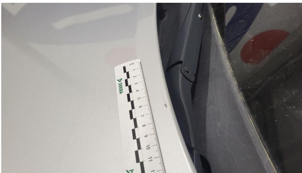
Fot. 38. Pokrywa komory silnika - Rysa/odprysk 2
