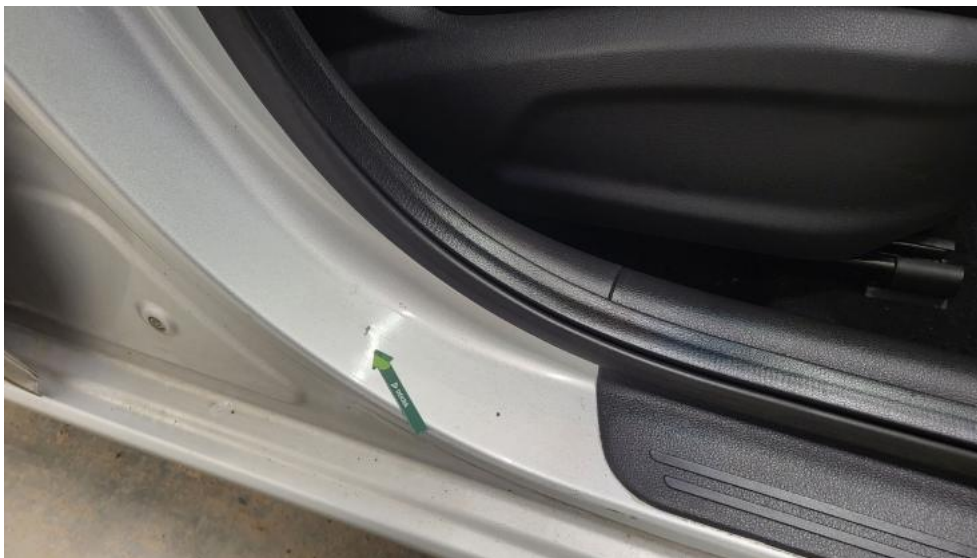
Fot. 51. Próg P - Wgniecenie/odkształcenie 1
