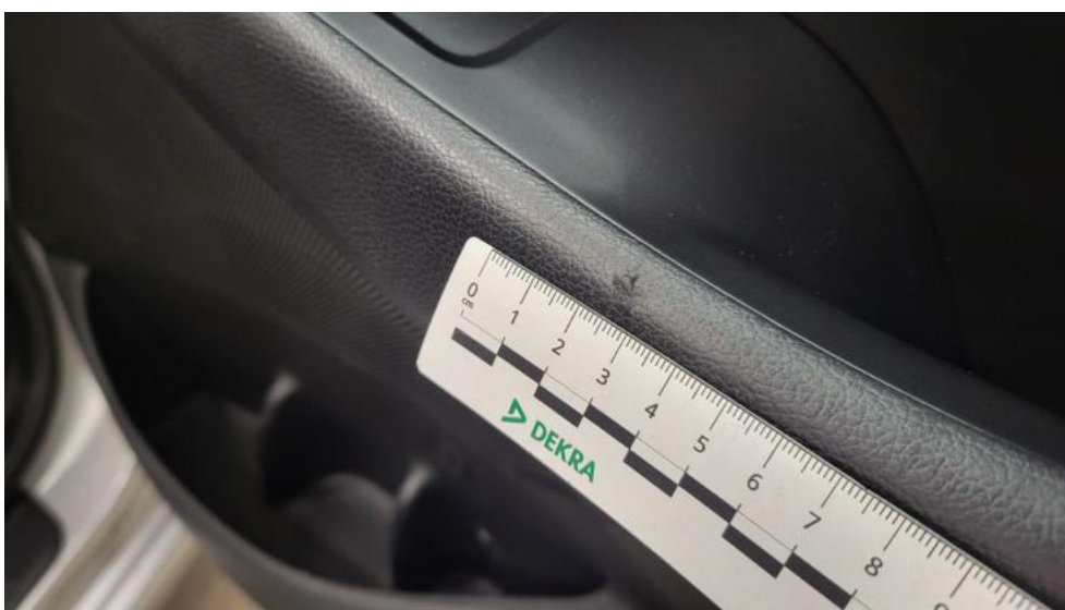
Fot. 80. Tapicerka drzwi przednich P - Wgniecenie/odkształcenie 1
