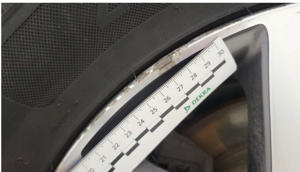
Fot. 55. Felga aluminiowa tylna P - Rysa/odprysk 1
