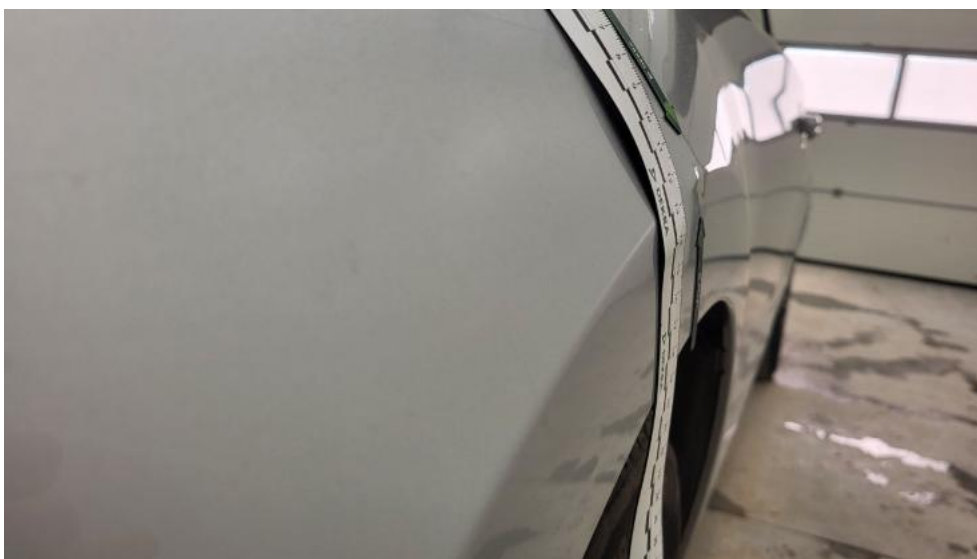
Fot. 71. Błotnik przedni L - Wgniecenie/odkształcenie 1
