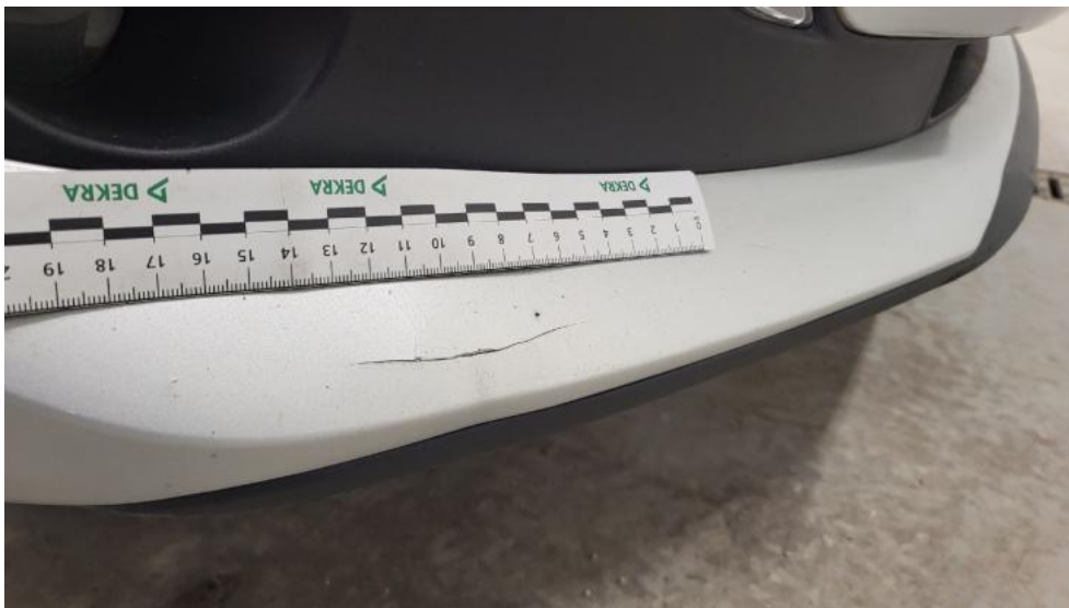
Fot. 47. Zderzak - Pęknięcie/rozerwanie 1
