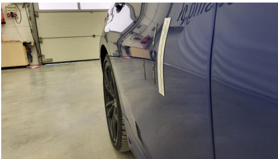
Photo 55. Drzwi tylne P - Wgniecenie/odkształcenie 1
