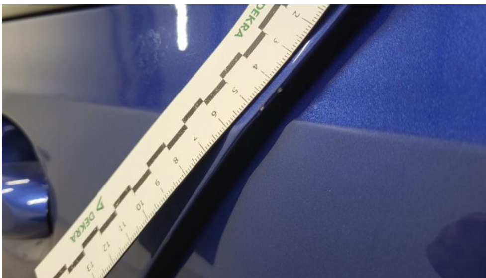
Photo 65. Drzwi tylne L - Rysa/odprysk 1
