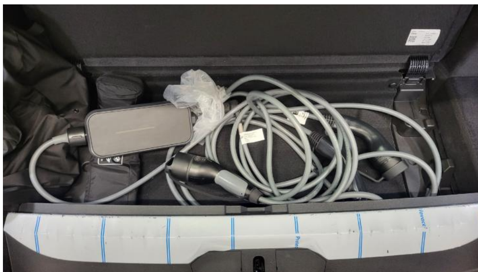
Photo 36. Przewód ładowania baterii trakcyjnej
