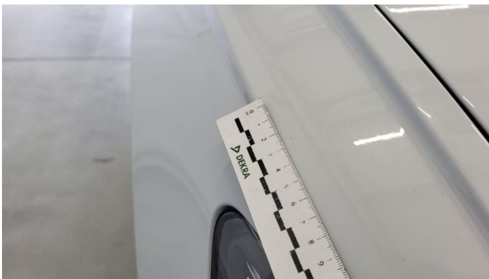
Photo 42. Błotnik przedni P - Rysa/odprysk 1
