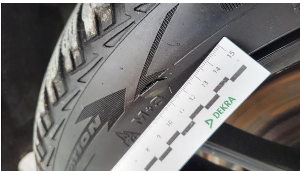
Photo 46. Opona tylna P - Pęknięcie/rozerwanie 1
