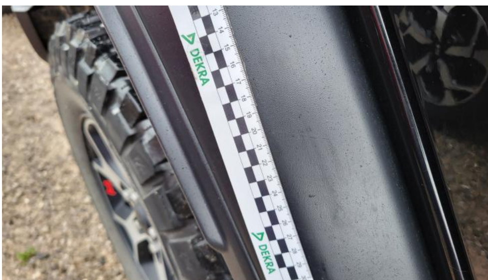
Fot. 46. Nadkole tylne P - Rysa/odprysk 1
