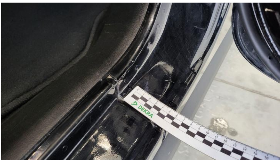
Fot. 45. Próg P - Rysa/odprysk 1
