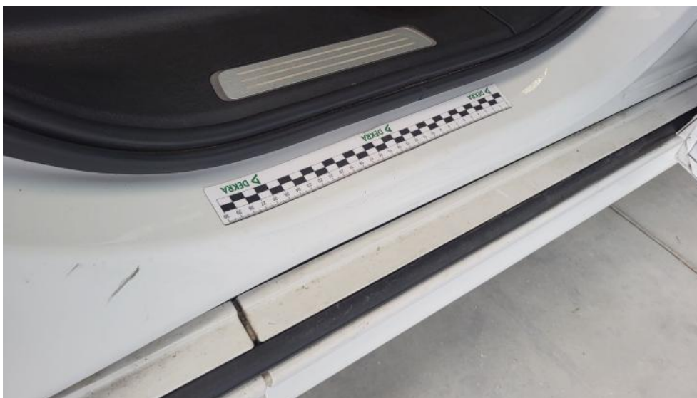
Fot. 61. Próg P - Rysa/odprysk 2
