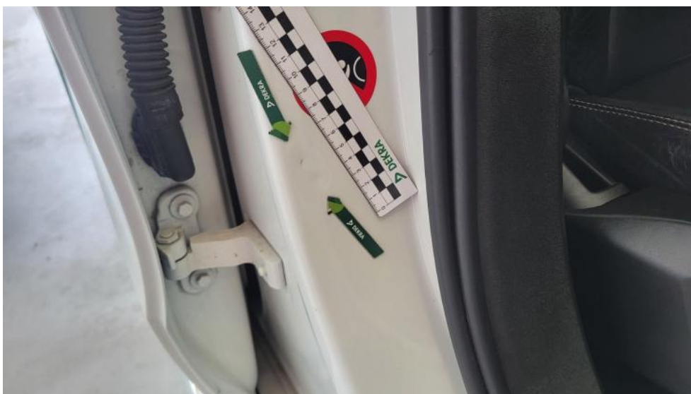
Fot. 62. Słupek środkowy P - Wgniecenie/odkształcenie 1
