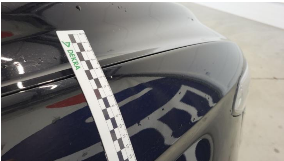
Fot. 44. Błotnik przedni P - Rysa/odprysk 1
