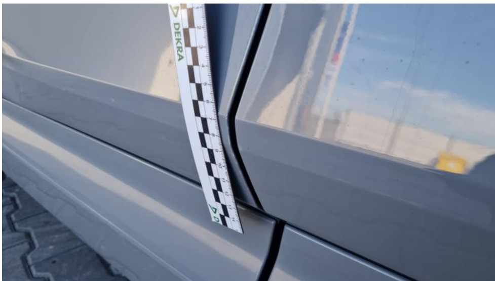
Fot. 49. Drzwi przed L - Rysa/odprysk 1
