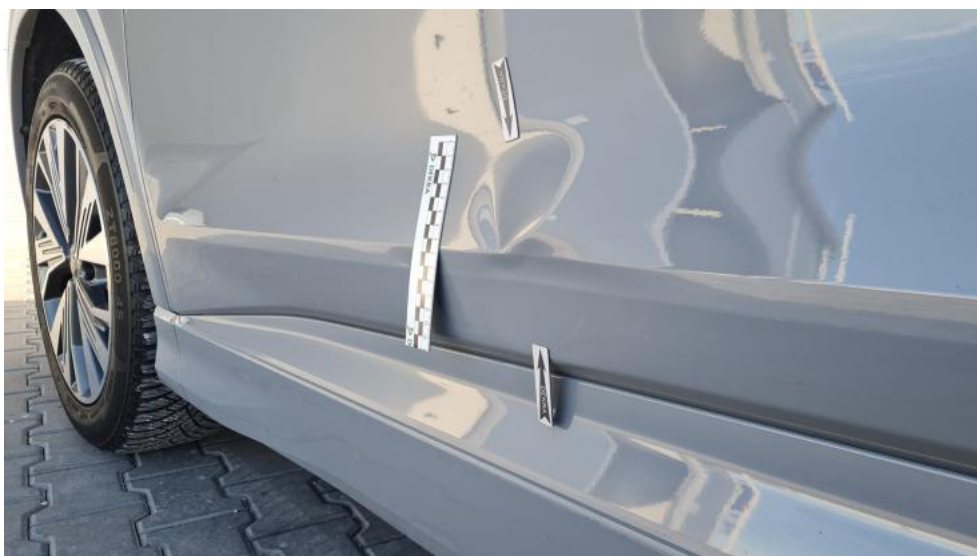
Fot. 50. Drzwi przed L - Wgniecenie/odkształcenie 1
