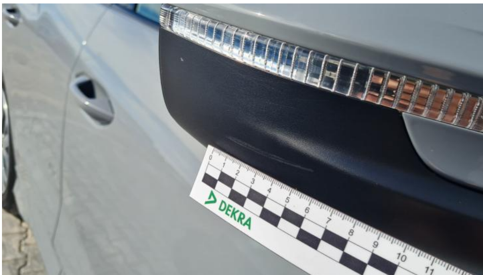
Fot. 43. Lusterko zew P - Rysa/odprysk 1
