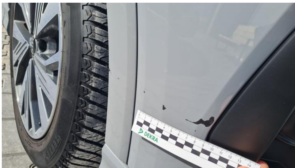
Fot. 40. Zderzak - Rysa/odprysk 1
