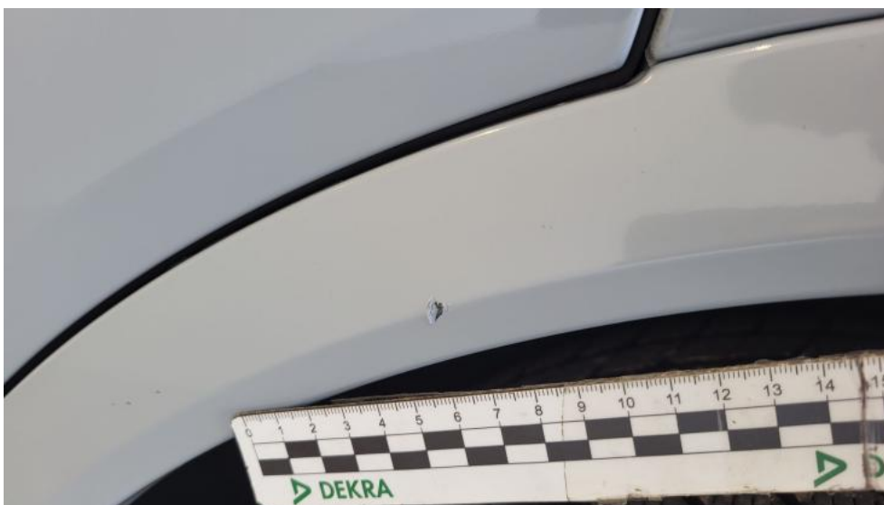
Photo 66. Listwa krawędzi błotnika tył L - Rysa/odprysk 1
