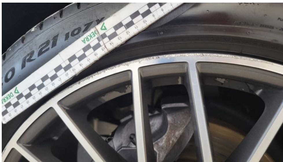
Photo 51. Felga aluminiowa przednia P - Rysa/odprysk 2
