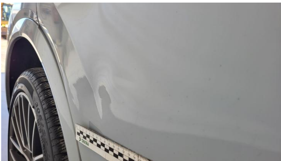
Photo 57. Drzwi tylne P - Wgniecenie/odkształcenie 2
