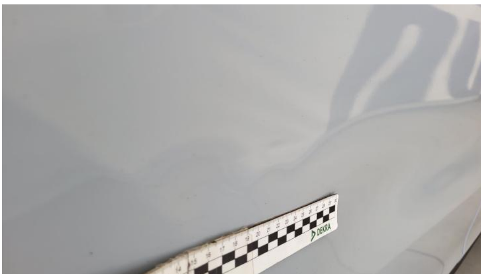
Photo 58. Drzwi tylne P() - Wgniecenie/odkształcenie 3
