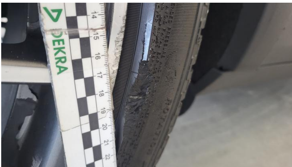
Photo 63. Opona tylna P - Pęknięcie/rozerwanie 2
