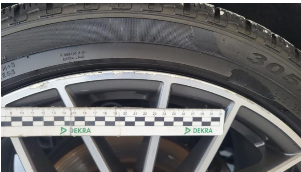
Photo 60. Felga aluminiowa tylna P - Rysa/odprysk 1
