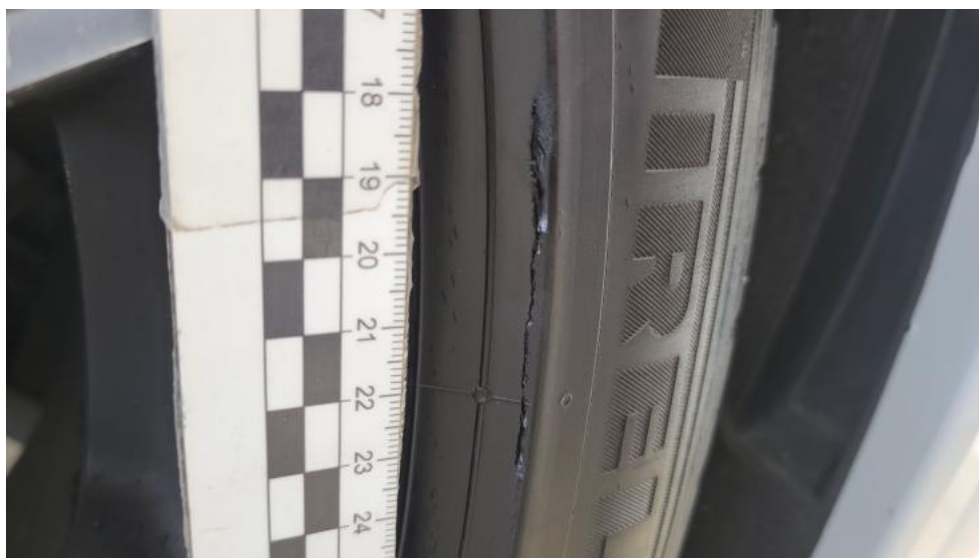
Photo 52. Opona przednia P - Pęknięcie/rozerwanie 1
