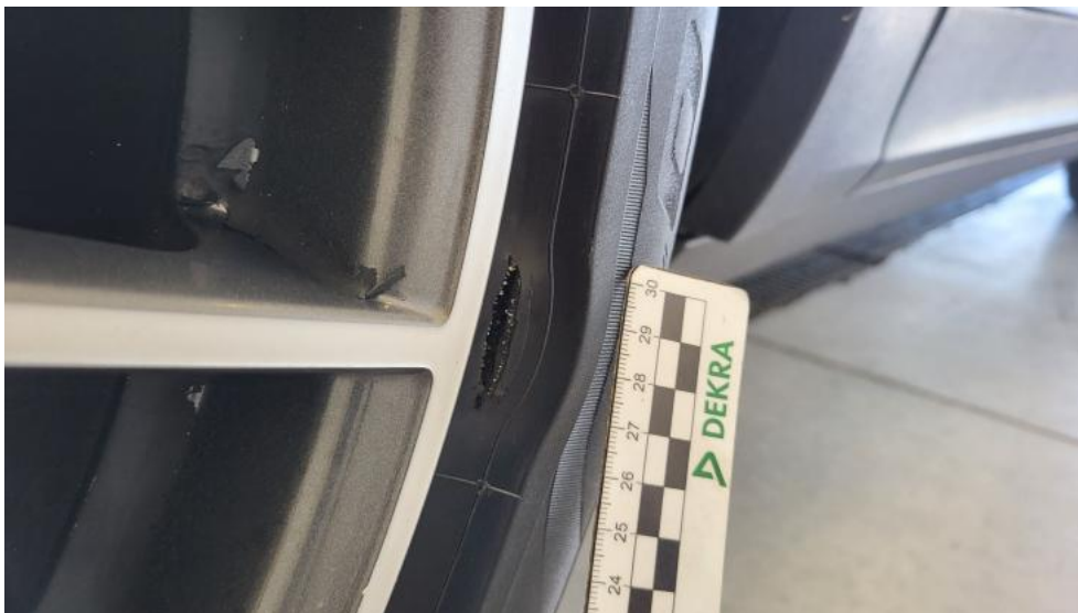
Photo 75. Opona przednia L - Wgniecenie/odkształcenie 1
