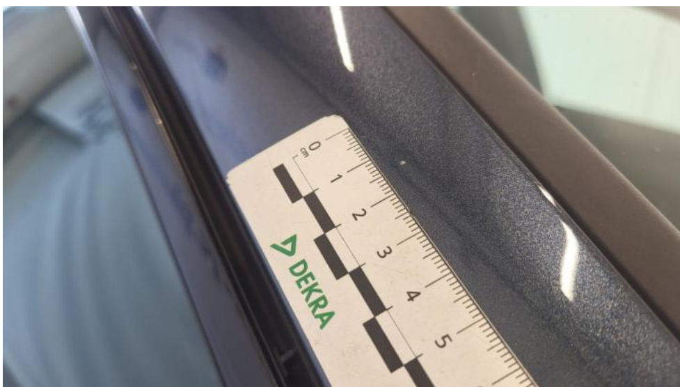
Photo 62. Słupek przedni P - Rysa/odprysk 1
