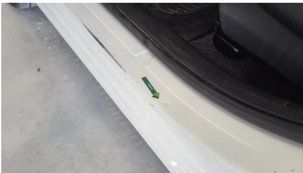
Fot. 62. Próg L - Wgniecenie/odkształcenie 1
