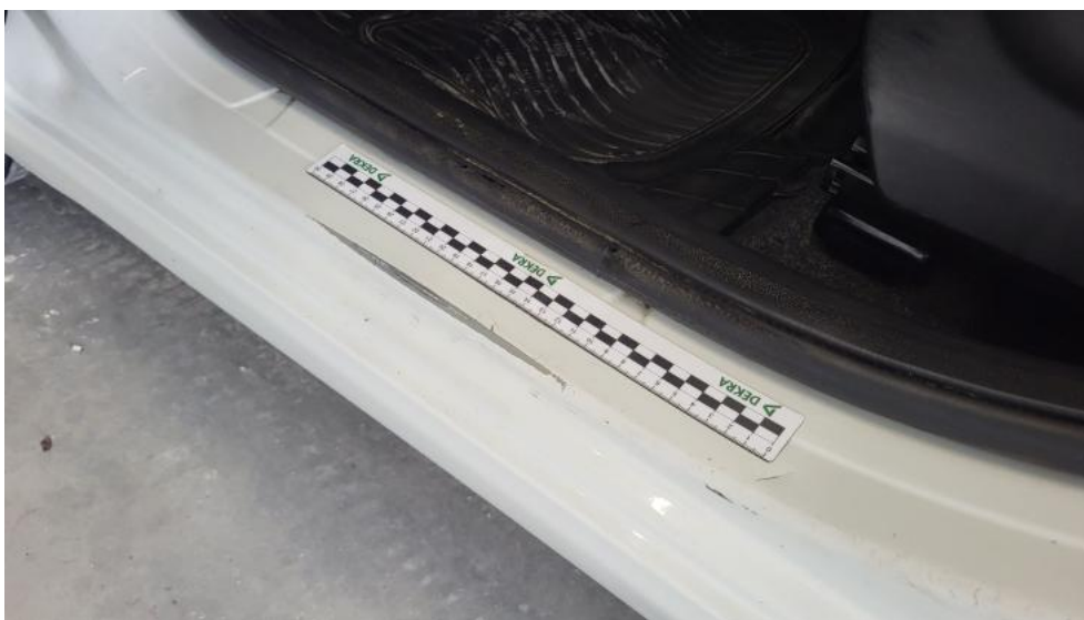
Fot. 61. Próg L - Rysa/odprysk 2
