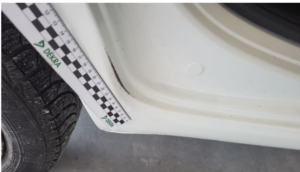
Fot. 41. Próg P - Rysa/odprysk 1
