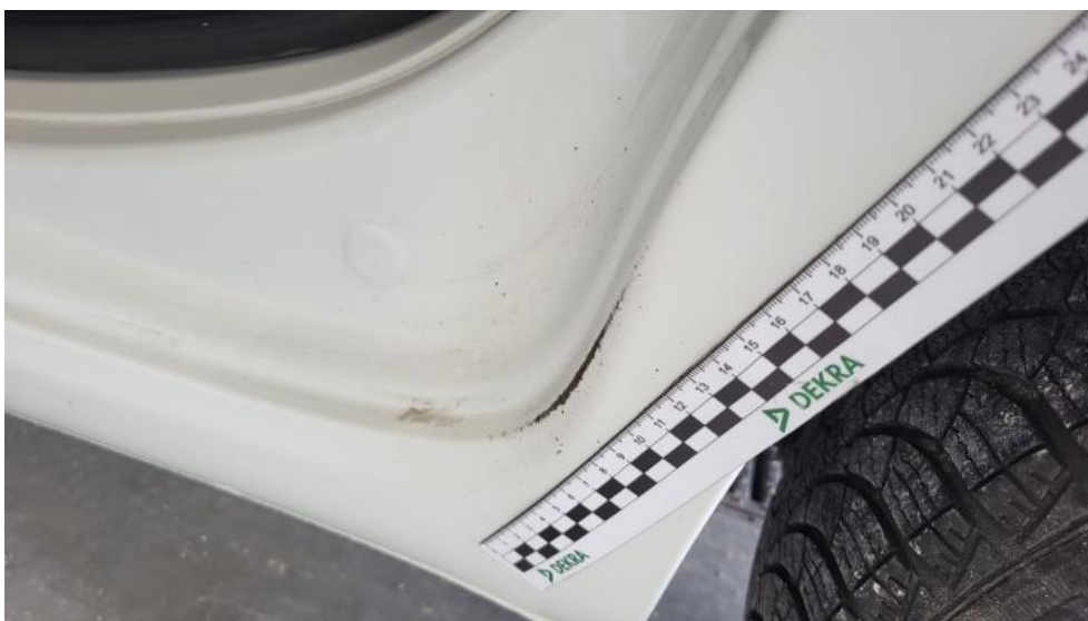
Fot. 60. Próg L - Rysa/odprysk 1
