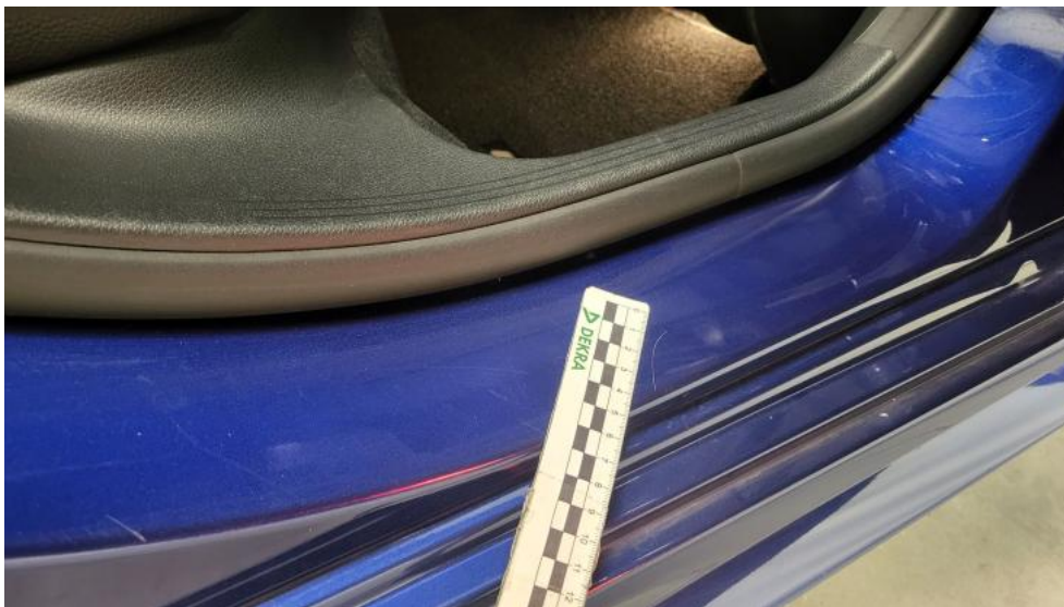
Photo 63. Próg P - Rysa/odprysk 1
