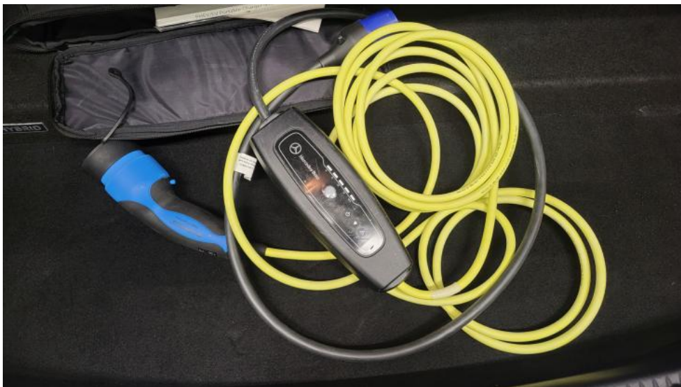
Photo 35. Przewód ładowania baterii trakcyjnej
