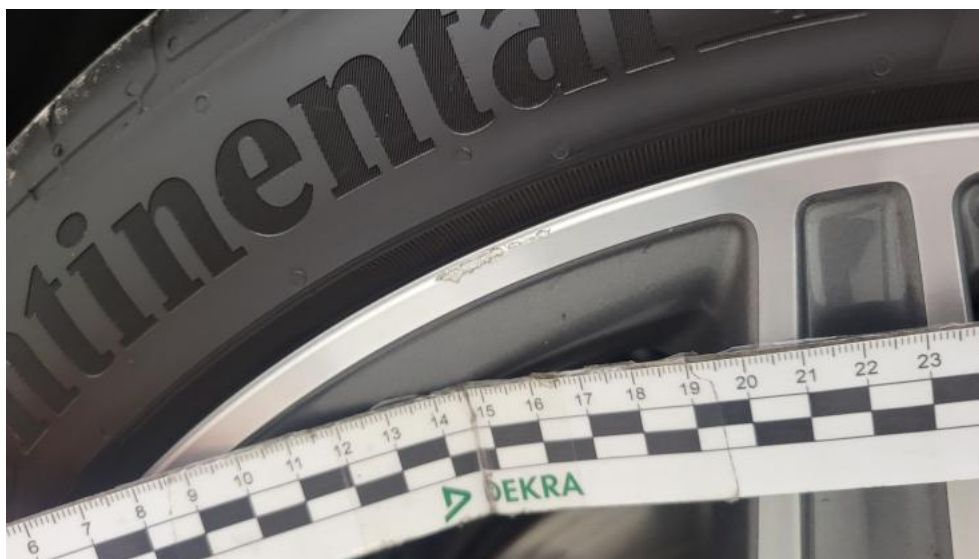
Photo 67. Felga aluminiowa tylna L - Rysa/odprysk 1
