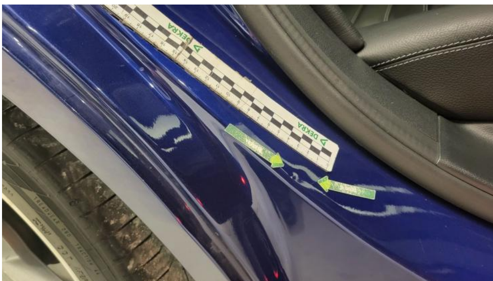
Photo 64. Błotnik tylny P / Ściana boczna P - Wgniecenie/odkształcenie 1
