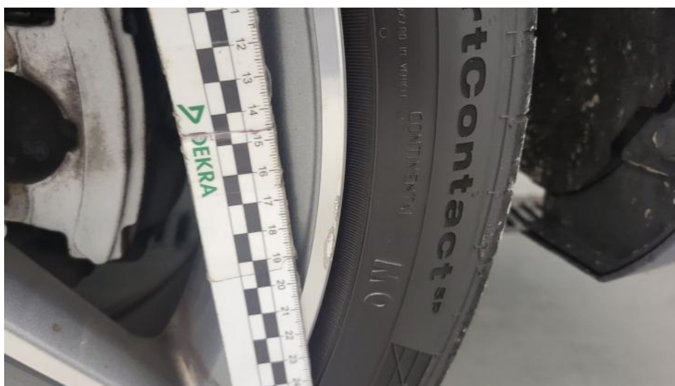
Photo 68. Felga aluminiowa tylna L - Rysa/odprysk 2
