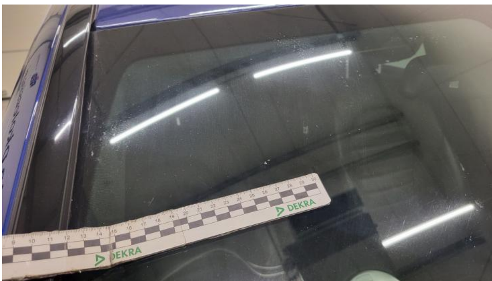
Photo 61. Szyba czółowa() - Rysa/odprysk 3
