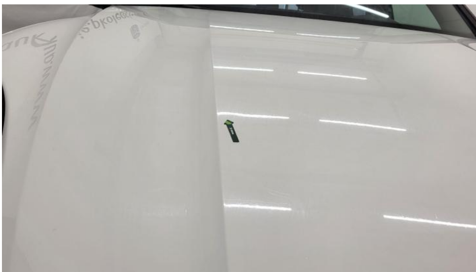
Fot. 45. Pokrywa komory silnika - Wgniecenie/odkształcenie 1
