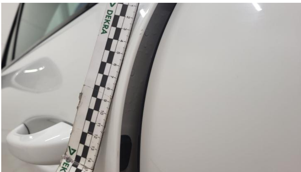
Fot. 64. Drzwi przed L - Rysa/odprysk 2
