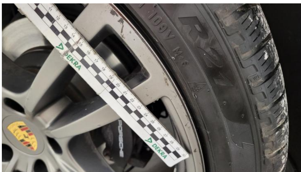
Fot. 58. Felga aluminiowa tylna P - Rysa/odprysk 2
