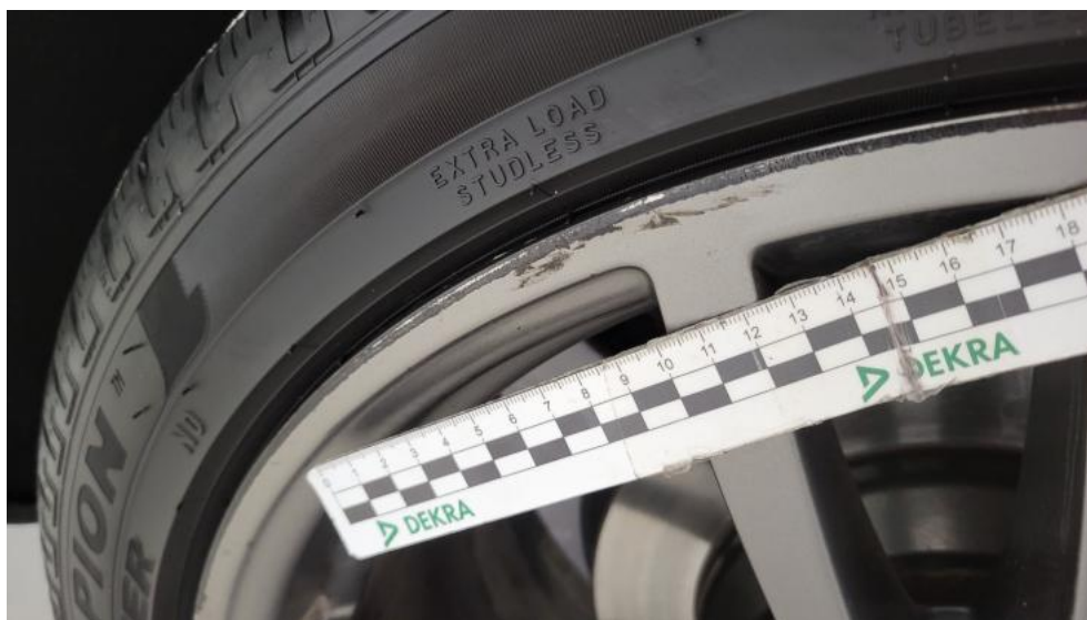
Fot. 57. Felga aluminiowa tylna P - Rysa/odprysk 1
