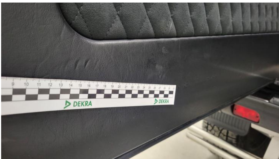
Fot. 94. Wykładzina pokrywy tylnej() - Wgniecenie/odkształcenie 3
