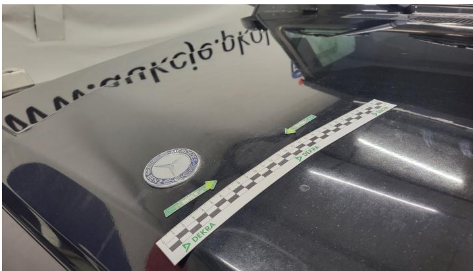
Fot. 67. Pokrywa komory silnika - Wgniecenie/odkształcenie 2
