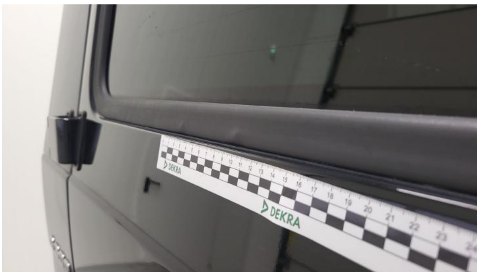
Fot. 74. Uszczelka szyby tylnej - Wgniecenie/odkształcenie 1
