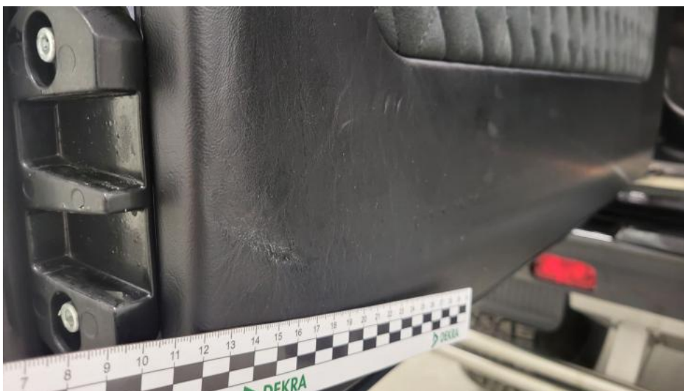
Fot. 93. Wykładzina pokrywy tylnej - Wgniecenie/odkształcenie 2
