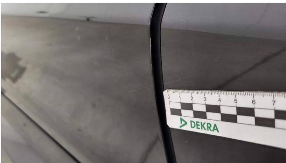
Photo 68. Drzwi tylne L - Rysa/odprysk 2
