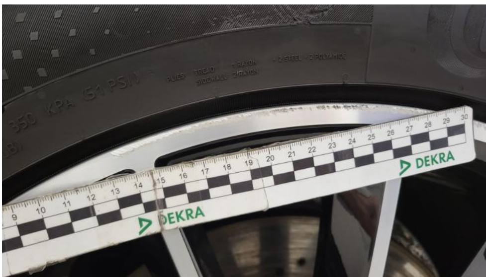
Photo 54. Felga aluminiowa przednia P - Rysa/odprysk 1
