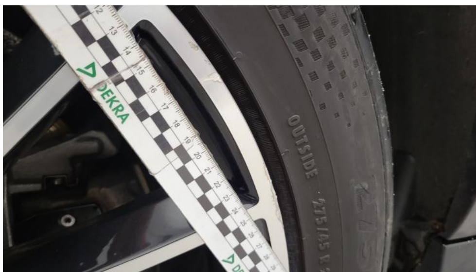
Photo 72. Felga Aluminiowa przednia L - Rysa/odprysk 1
