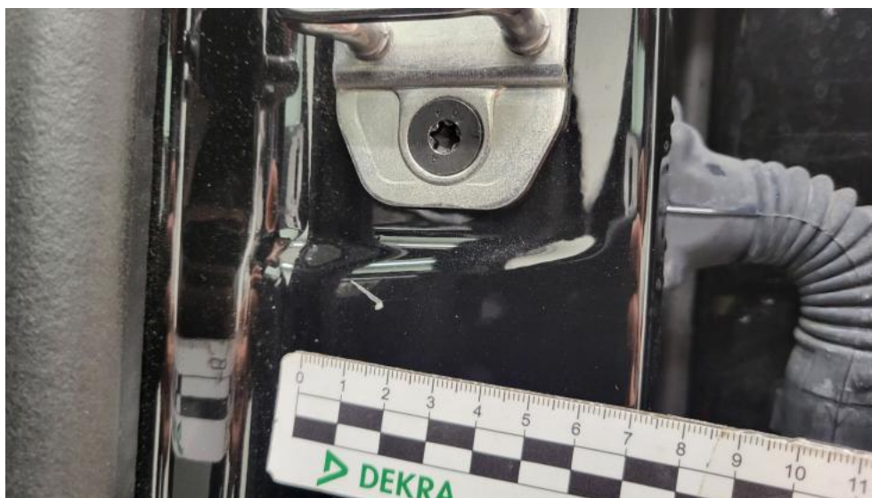
Photo 71. Stupek środkowy L - Rysa/odprysk 1
