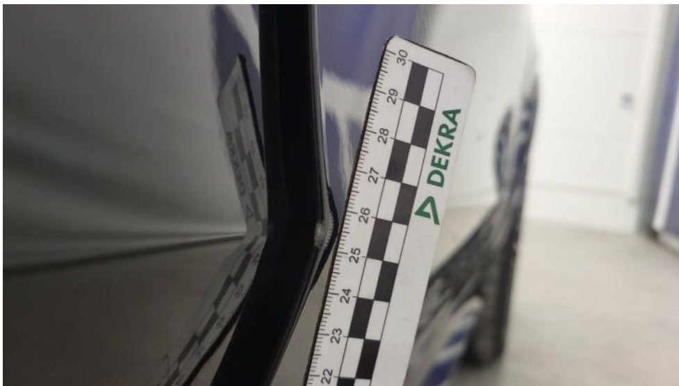
Photo 57. Drzwi przednie P - Rysa/odprysk 1
