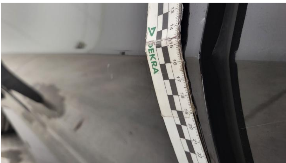
Photo 66. Drzwi przed L - Rysa/odprysk 1
