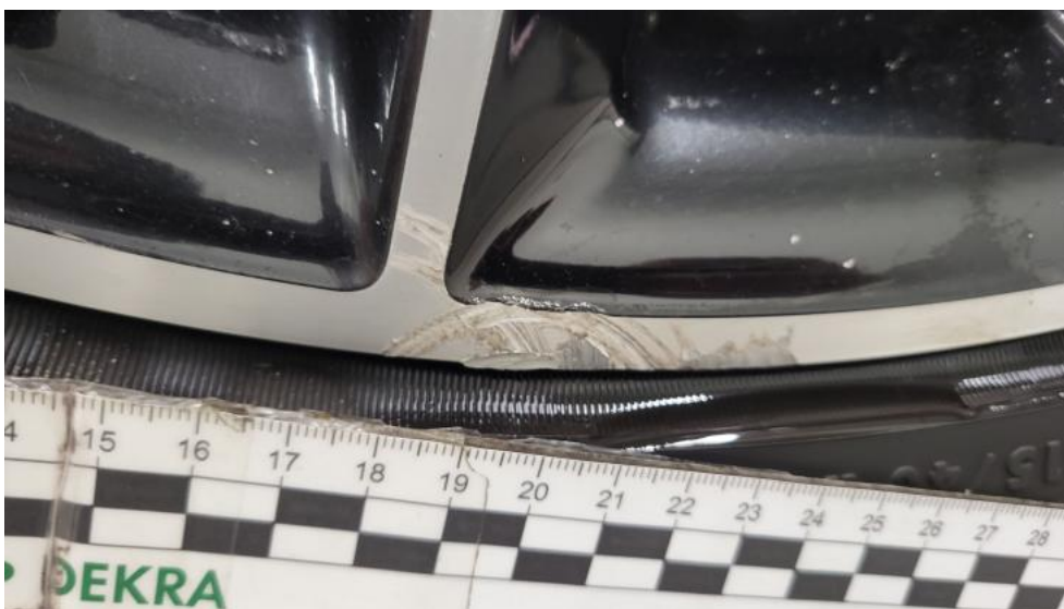
Photo 65. Felga aluminiowa tylna L - Rysa/odprysk 2
