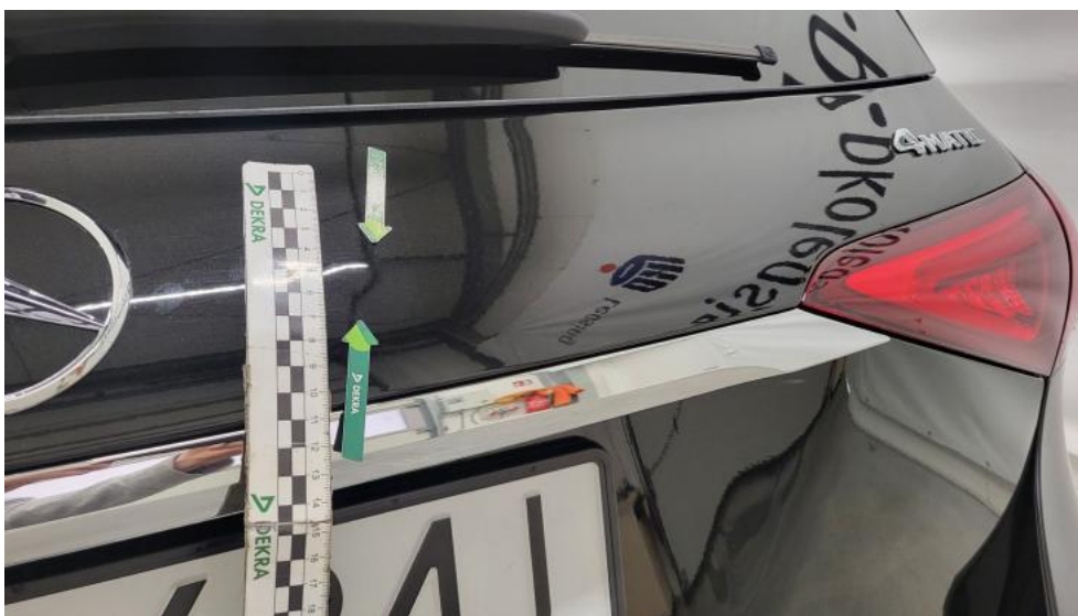
Photo 61. Pokrywy bagażnika - Wgniecenie/odkształcenie 1
