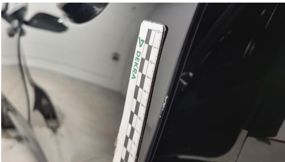
Photo 67. Drzwi tylne L - Rysa/odprysk 1
