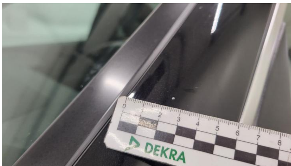
Photo 70. Słupek przedni L - Rysa/odprysk 1
