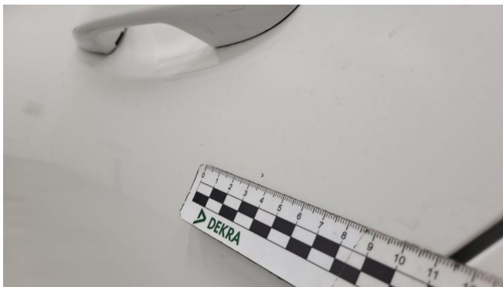
Fot. 53. Drzwi tylne L - Rysa/odprysk 2
