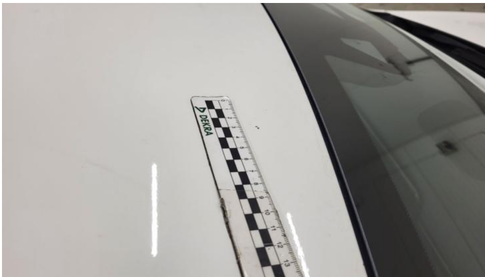
Fot. 47. Dach - Rysa/odprysk 1
