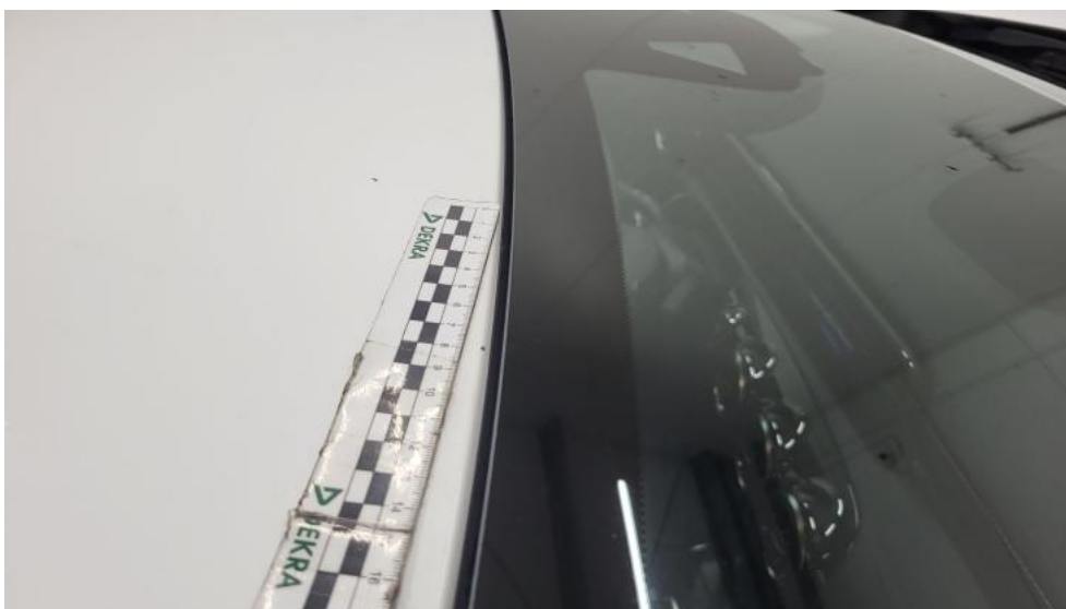
Fot. 48. Dach - Rysa/odprysk 2
