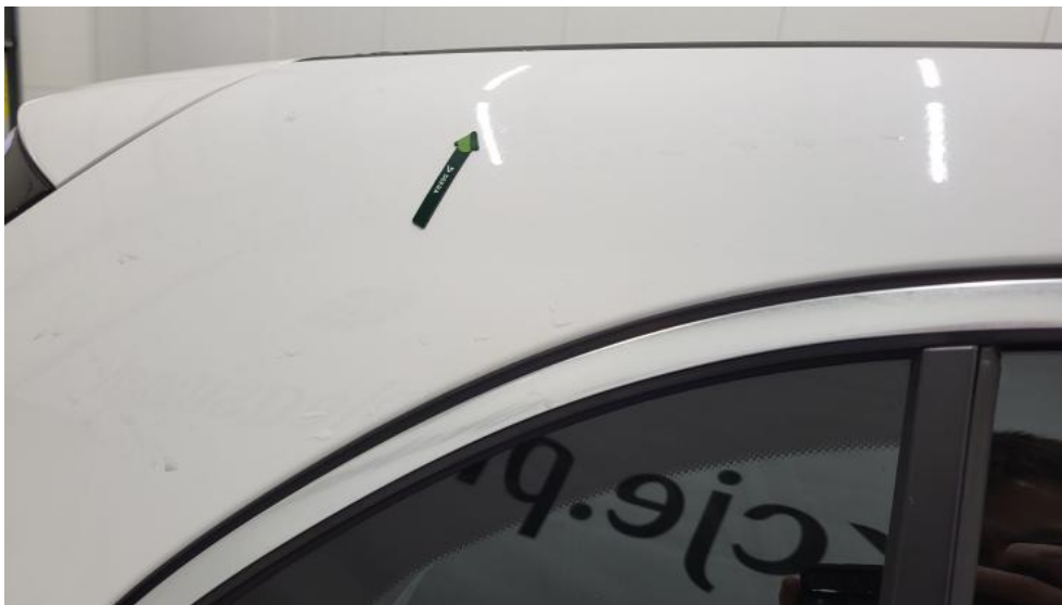
Fot. 43. Błotnik tylny P / Ściana boczna P - Wgniecenie/odkształcenie 2
