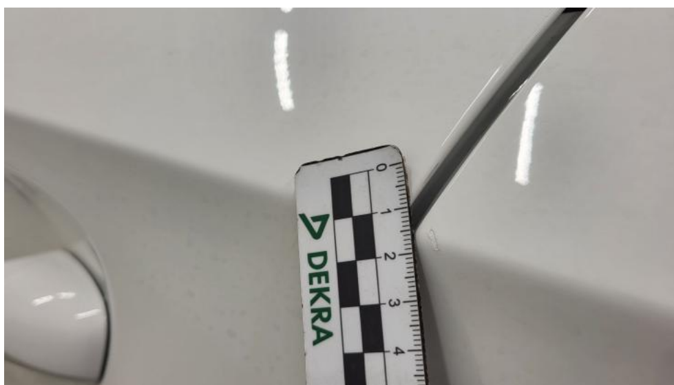
Fot. 54. Drzwi tylne L() - Rysa/odprysk 3
