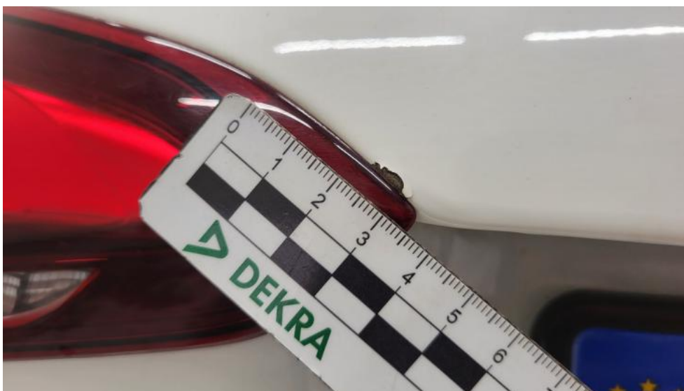
Fot. 45. Pokrywy bagażnika - Rysa/odprysk 1
