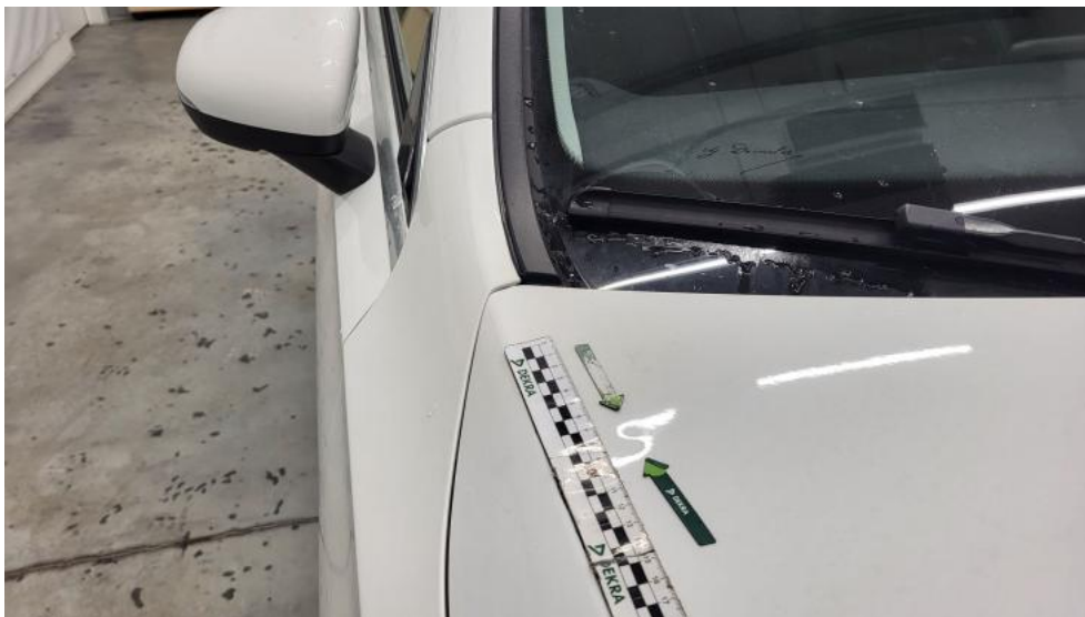
Fot. 37. Pokrywa komory silnika - Wgniecenie/odkształcenie 1
