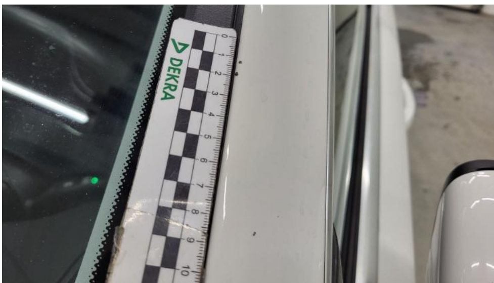
Fot. 55. Stupek przedni L - Rysa/odprysk 1
