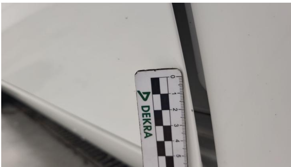
Fot. 51. Drzwi przed L - Rysa/odprysk 2
