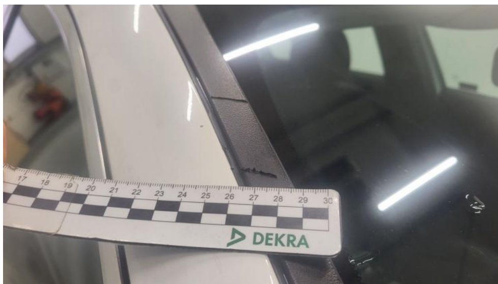
Fot. 39. Uszczelka/listwa szyby czołowej - Rysa/odprysk 1
