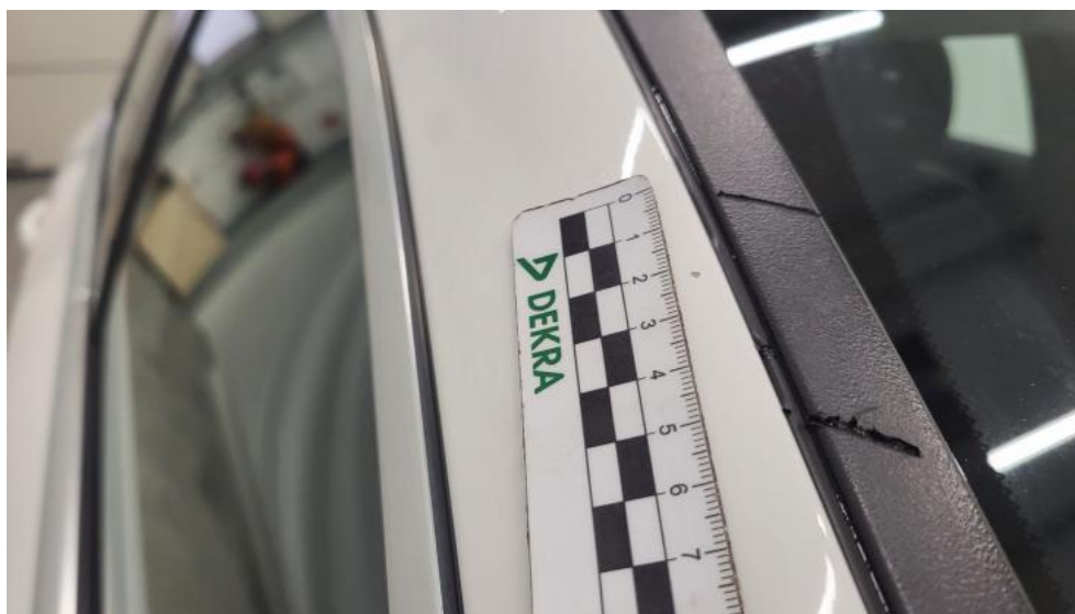
Fot. 41. Stupek przedni P - Rysa/odprysk 1
