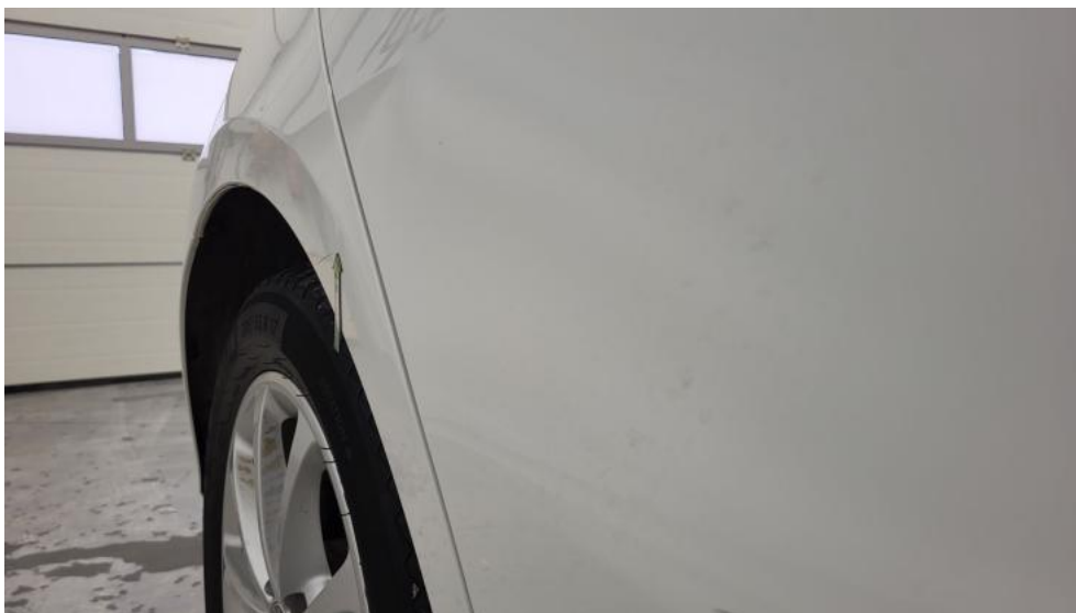
Fot. 44. Błotnik tylny P / Ściana boczna P() - Wgniecenie/odkształcenie 3
