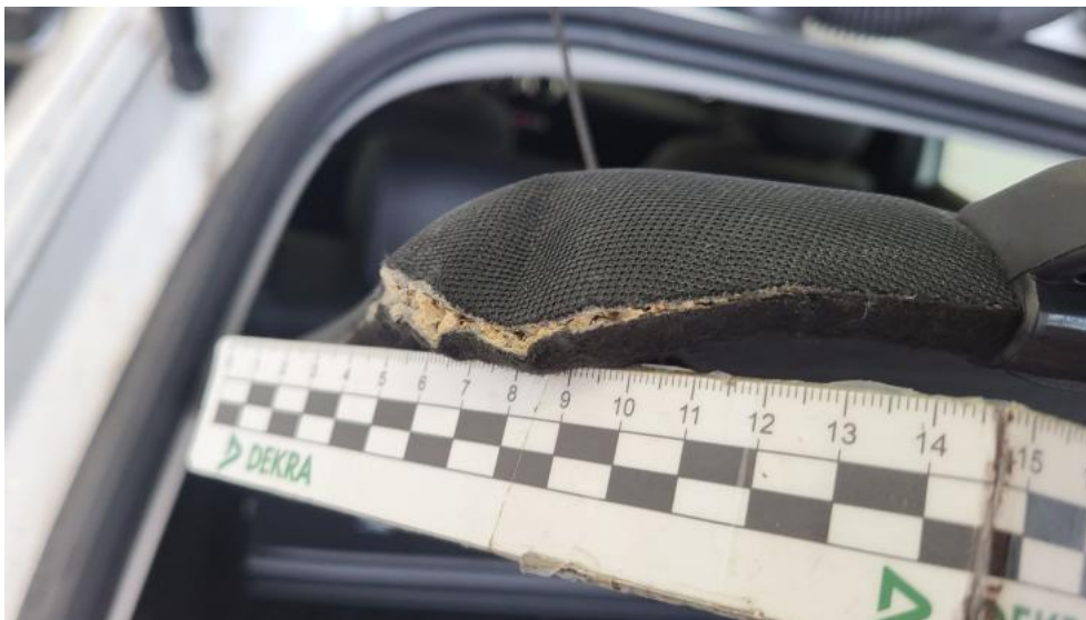
Fot. 61. Półka/roleta tylna - Pęknięcie/rozerwanie 1
