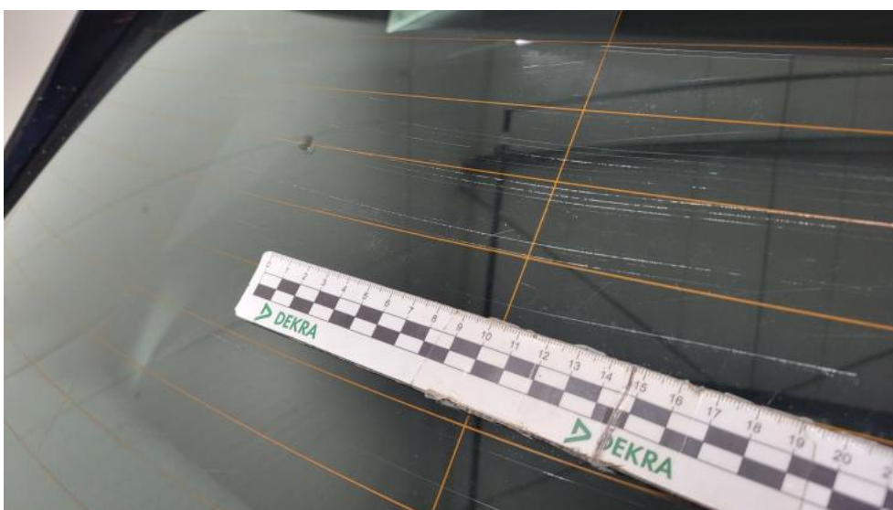
Fot. 46. Szyba tylna() - Rysa/odprysk 3
