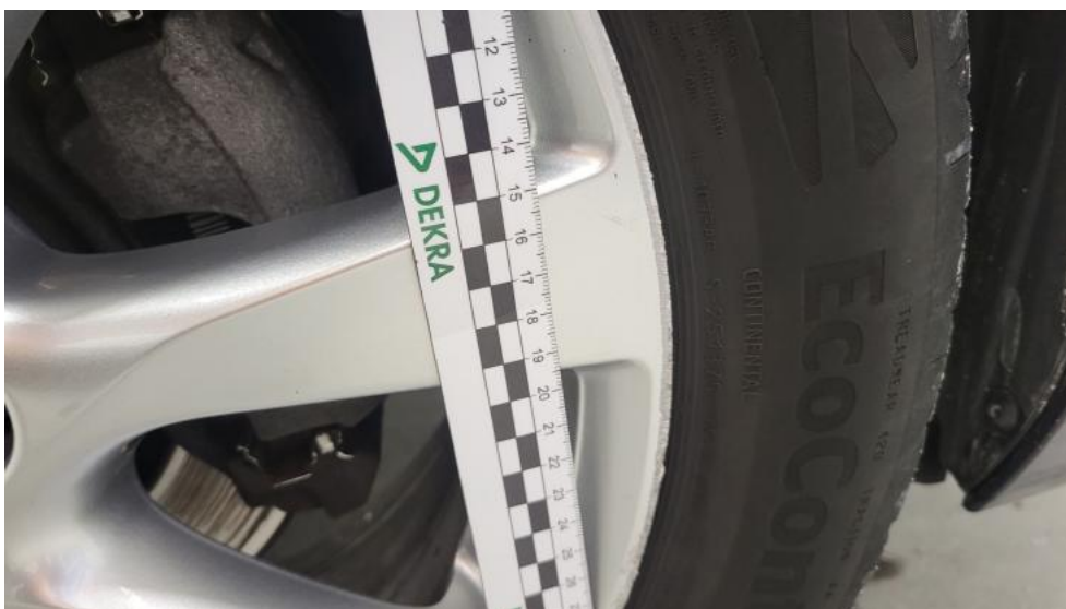
Photo 54. Felga aluminiowa przednia P - Rysa/odprysk 1
