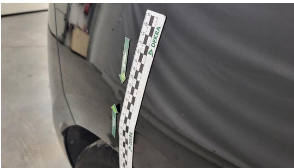
Photo 62. Błotnik tylny P / Ściana boczna P - Wgniecenie/odkształcenie 1
