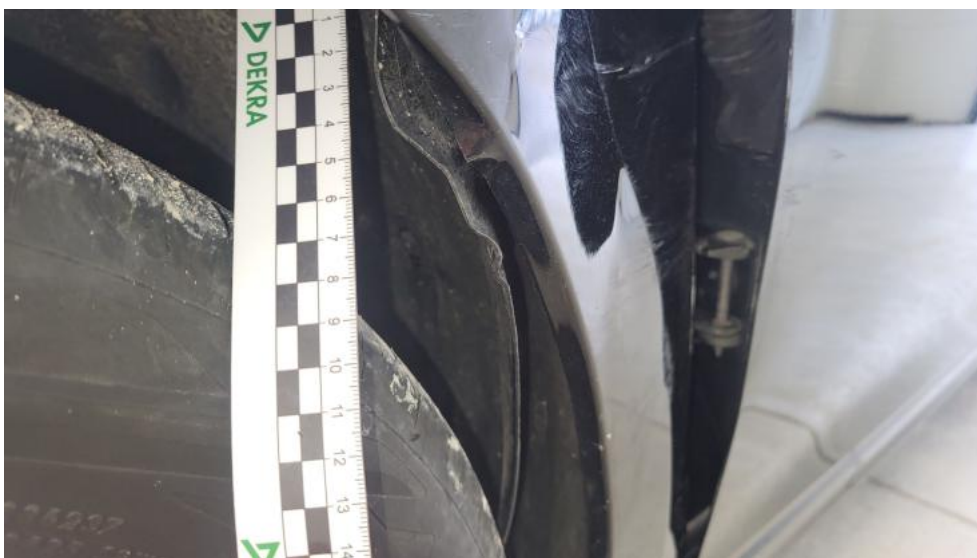
Photo 90. Nadkole przednie L - Pęknięcie/rozerwanie 2
