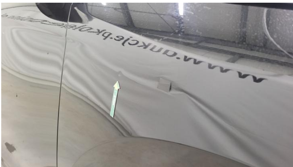
Photo 53. Błotnik przedni P - Wgniecenie/odkształcenie 1
