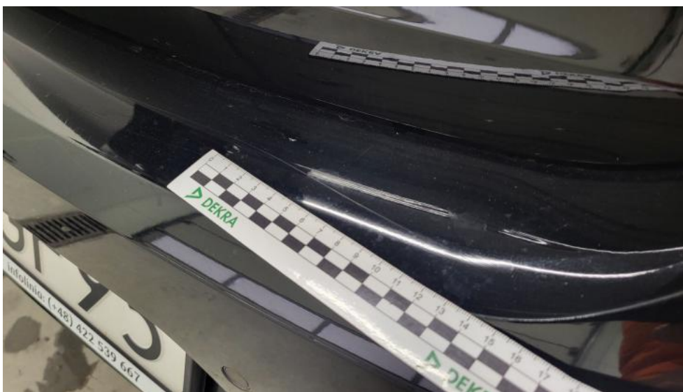
Photo 65. Zderzak tylny - Rysa/odprysk 1
