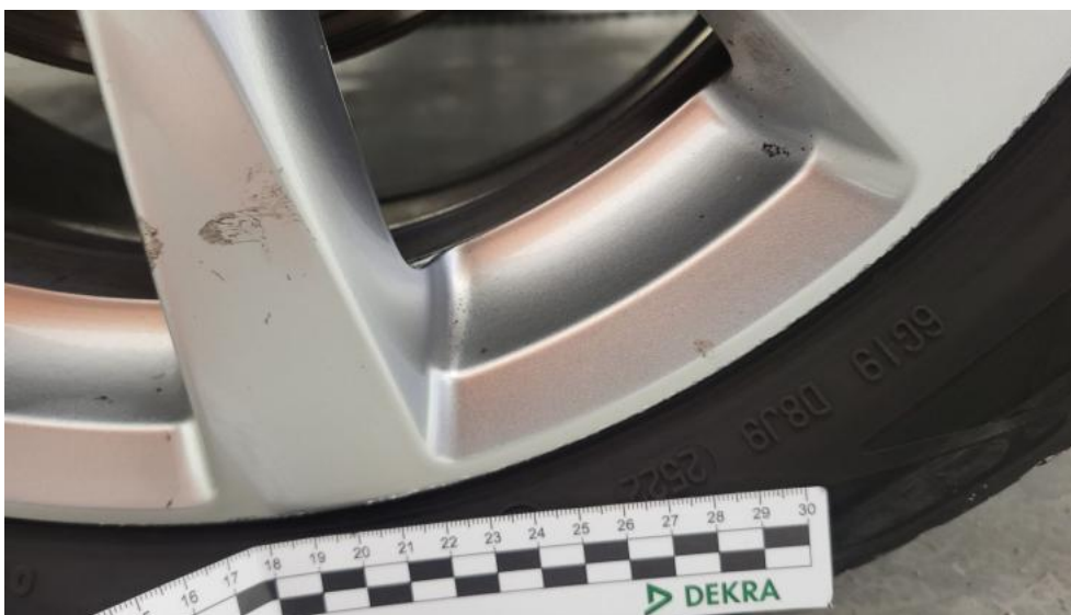
Photo 55. Felga aluminiowa przednia P - Rysa/odprysk 2
