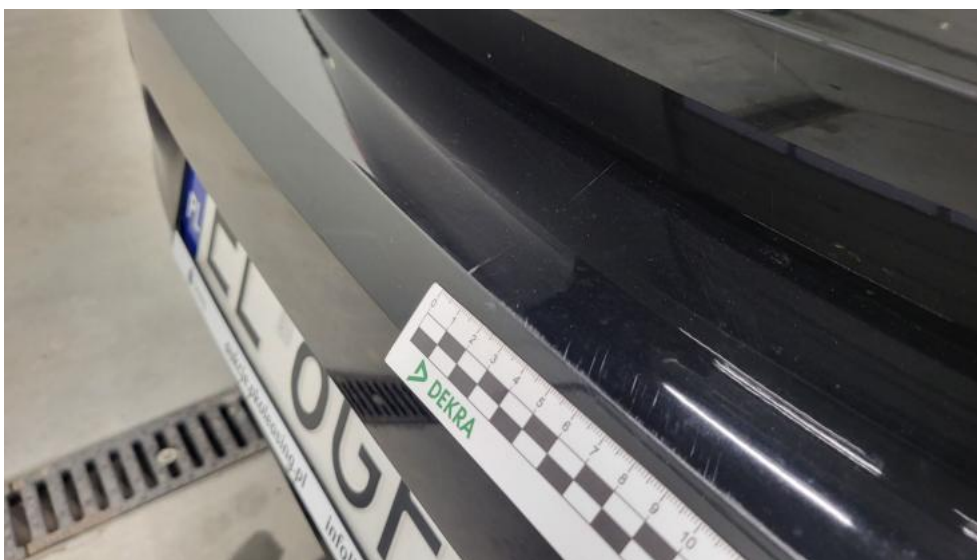
Photo 66. Zderzak tylny - Rysa/odprysk 2
