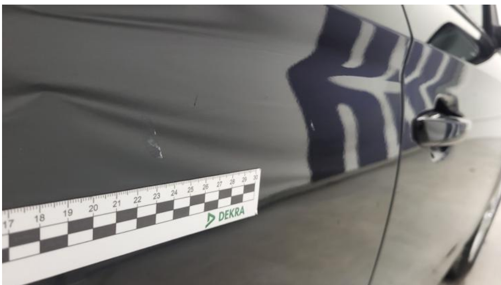
Photo 58. Drzwi tylne P - Rysa/odprysk 1
