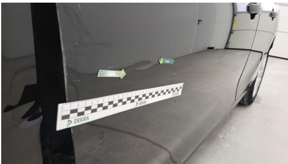
Photo 80. Drzwi przed L - Wgniecenie/odkształcenie 2
