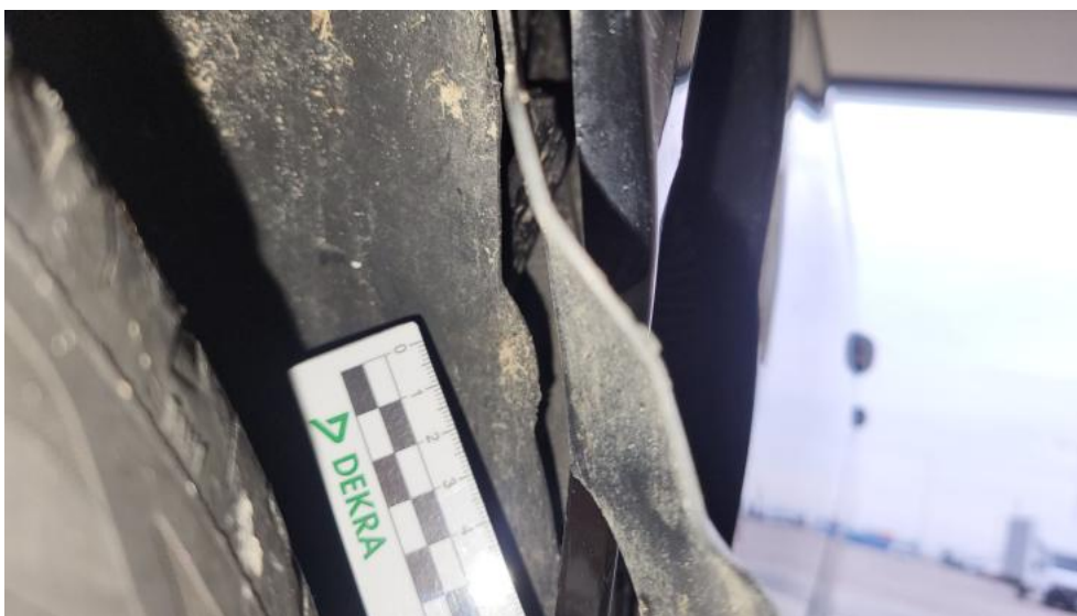
Photo 89. Nadkole przednie L - Pęknięcie/rozerwanie 1
