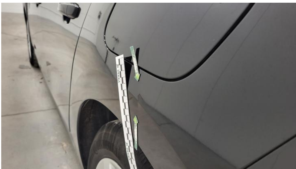
Photo 73. Błotnik tylny L / Ściana boczna L - Wgniecenie/odkształcenie 1
