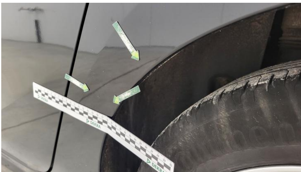
Photo 75. Błotnik tylny L / Ściana boczna L() - Wgniecenie/odkształcenie 3
