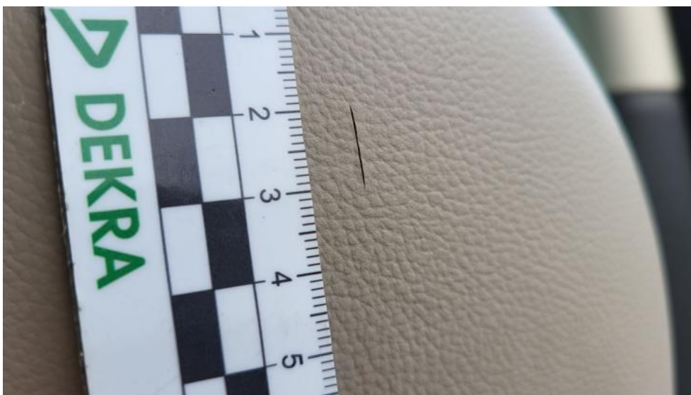
Fot. 61. Fotel prz. praw. - Pęknięcie/rozerwanie 2
