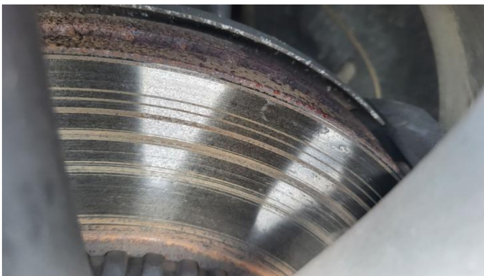
Fot. 18. Tarcza hamulcowa przednia lewa
