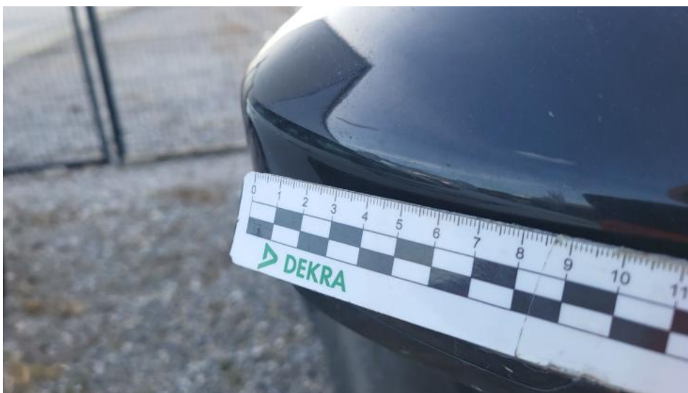
Fot. 51. Lusterko zew P - Rysa/odprysk 1
