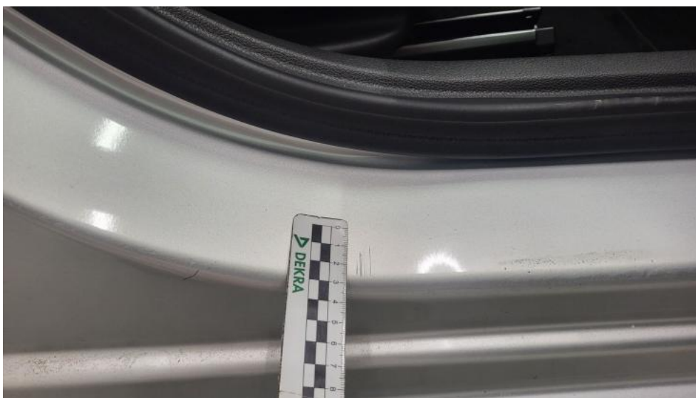
Fot. 41. Próg P - Rysa/odprysk 1
