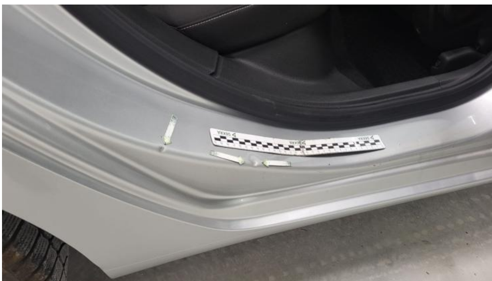
Fot. 42. Próg P - Wgniecenie/odkształcenie 1
