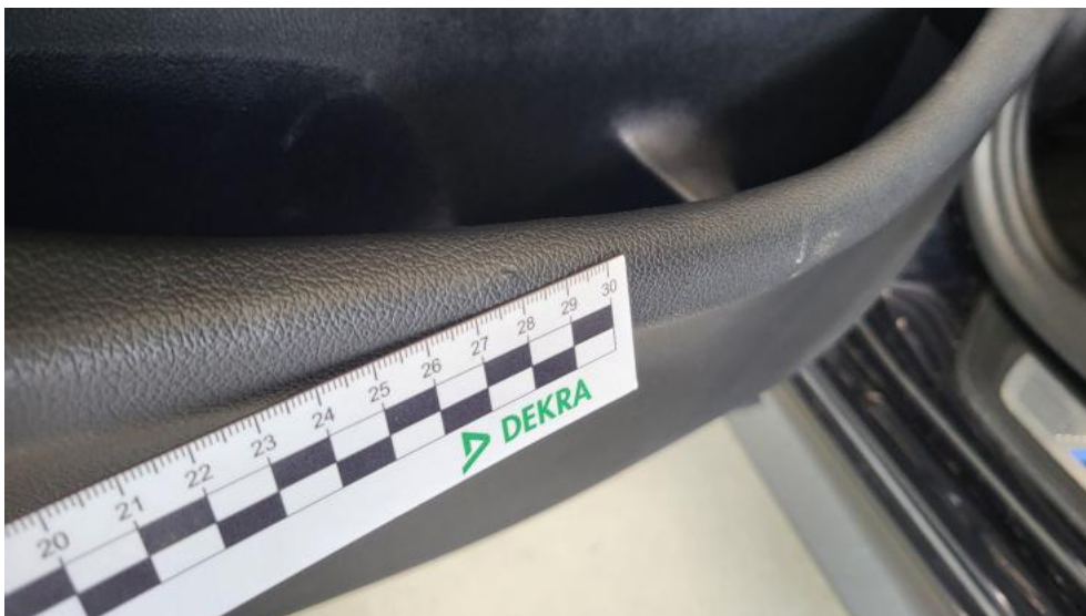
Photo 70. Tapicerka drzwi tylnych L - Rysa/odprysk 1
