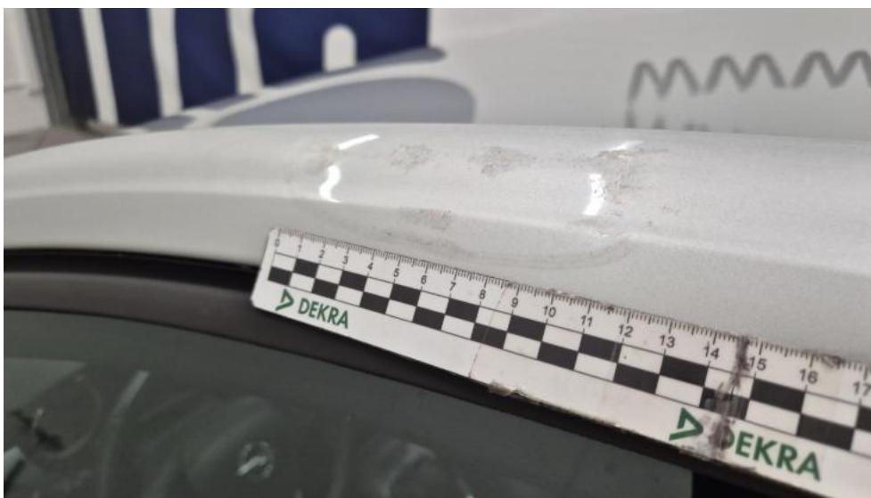
Fot. 53. Słupek przedni L - Rysa/odprysk 1
