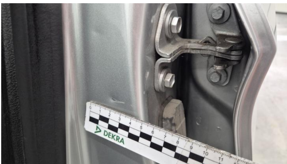
Fot. 54. Słupek środkowy L - Rysa/odprysk 1
