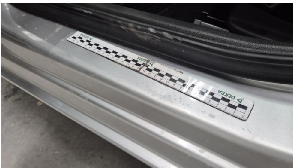
Fot. 51. Próg L - Rysa/odprysk 1
