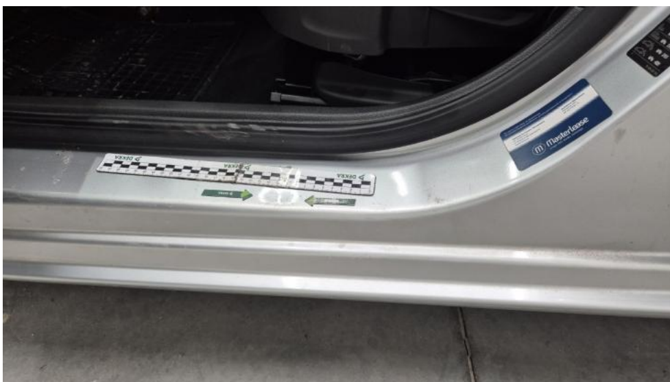
Fot. 52. Próg L - Wgniecenie/odkształcenie 1
