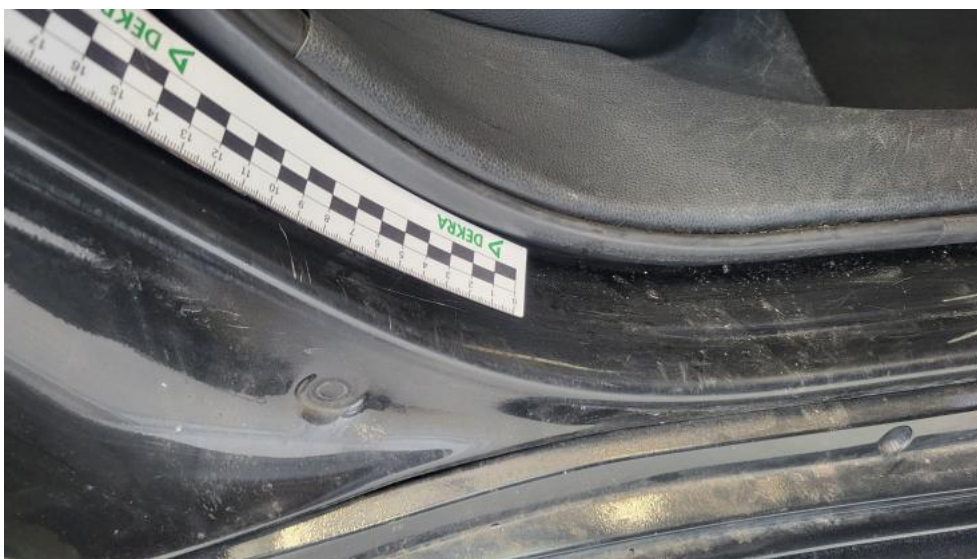
Fot. 59. Próg P - Rysa/odprysk 1
