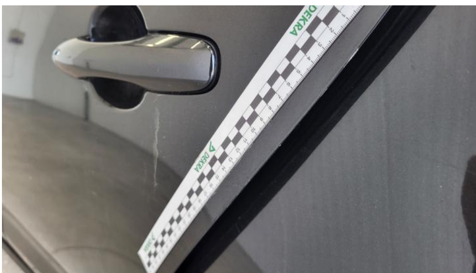
Fot. 80. Drzwi tylne L - Rysa/odprysk 1
