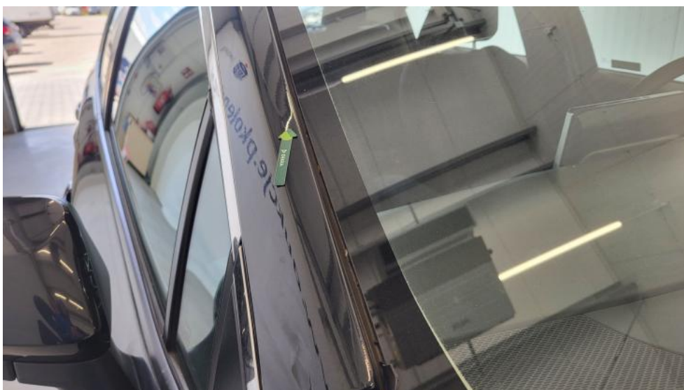
Fot. 60. Słupek przedni P - Wgniecenie/odkształcenie 1
