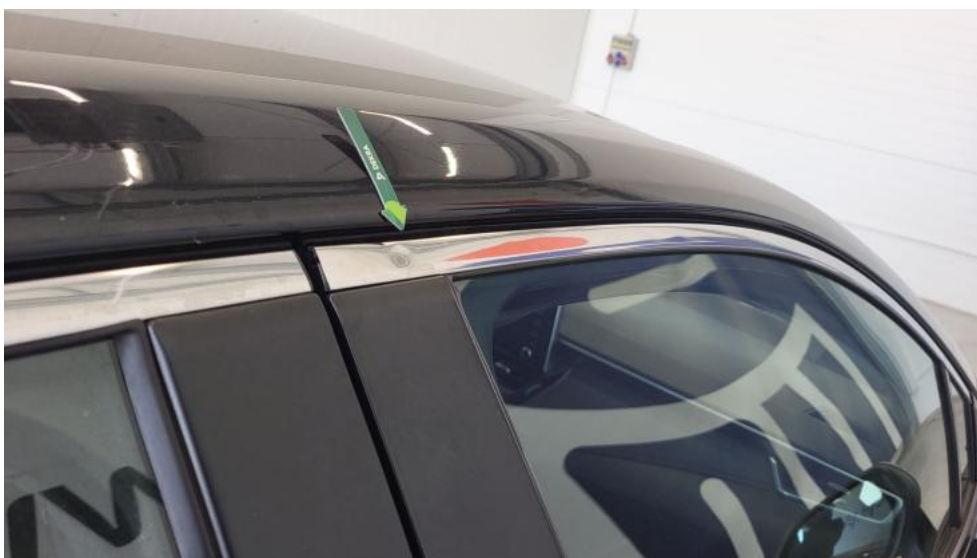
Fot. 56. Listwa drzwi przednich P - Wgniecenie/odkształcenie 1
