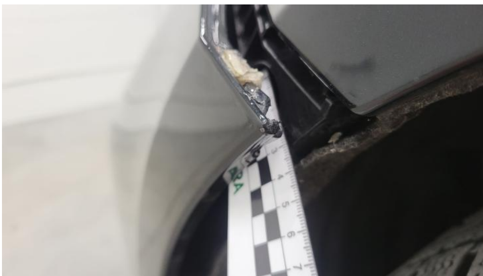
Fot. 45. Zderzak - Pęknięcie/rozerwanie 2
