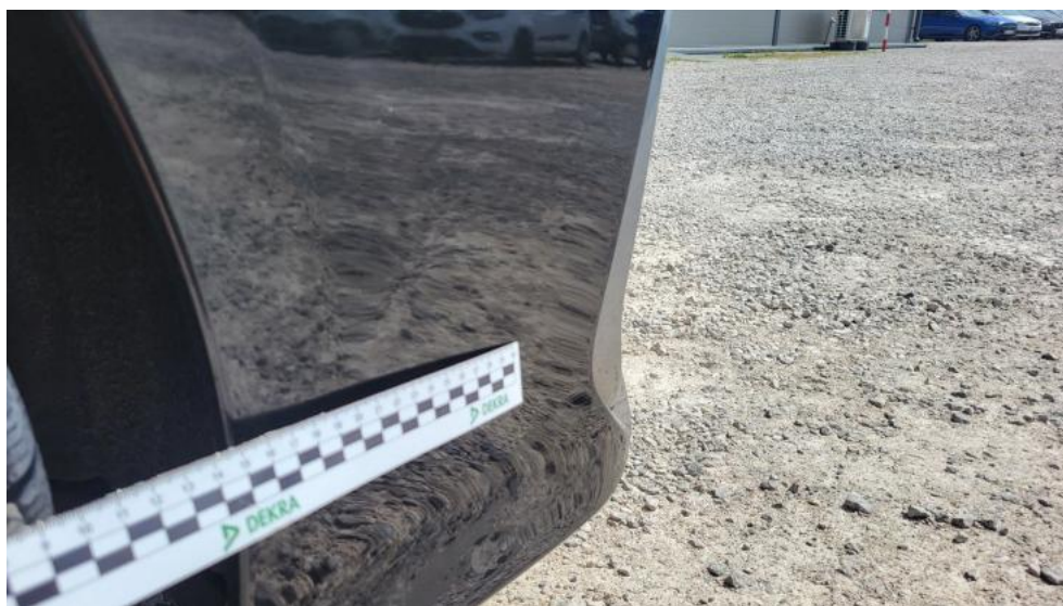
Fot. 43. Zderzak() - Wgniecenie/odkształcenie 3
