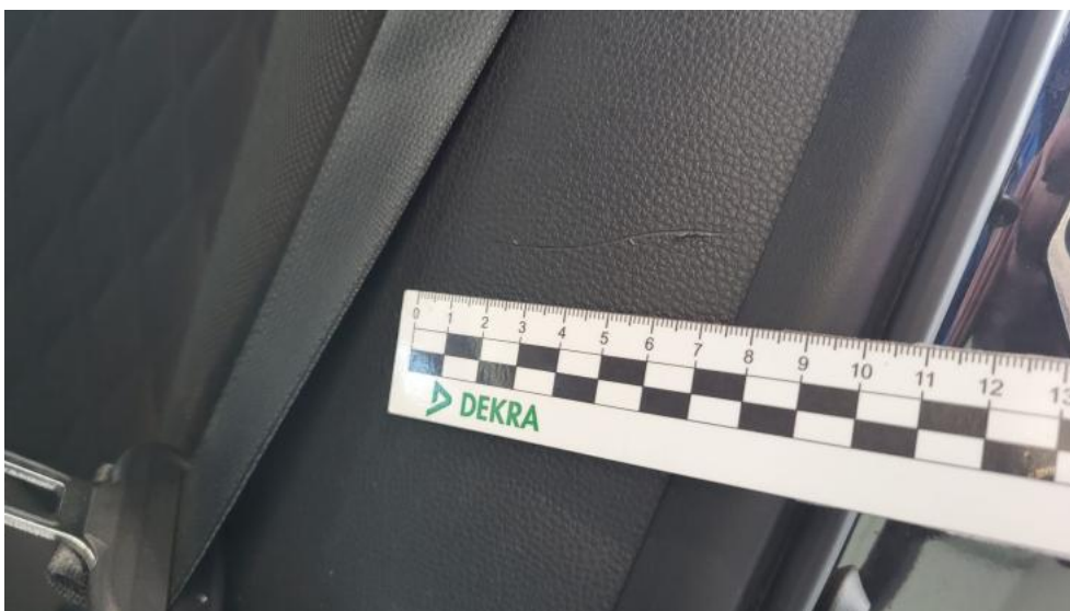
Fot. 106. Wykładzina(y) słupka tylnego L - Rysa/odprysk 1
