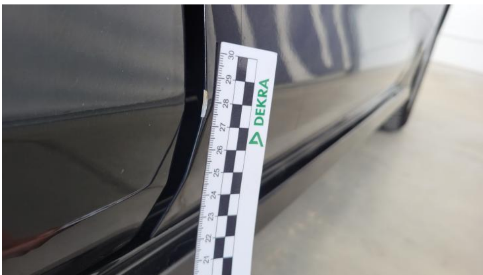
Fot. 50. Drzwi przednie P - Rysa/odprysk 1
