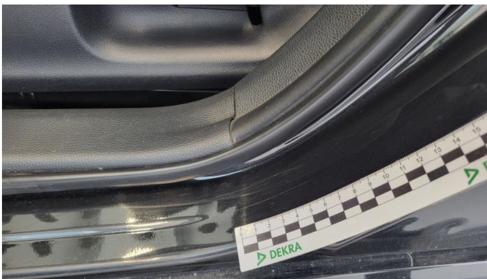
Fot. 85. Próg L - Rysa/odprysk 1
