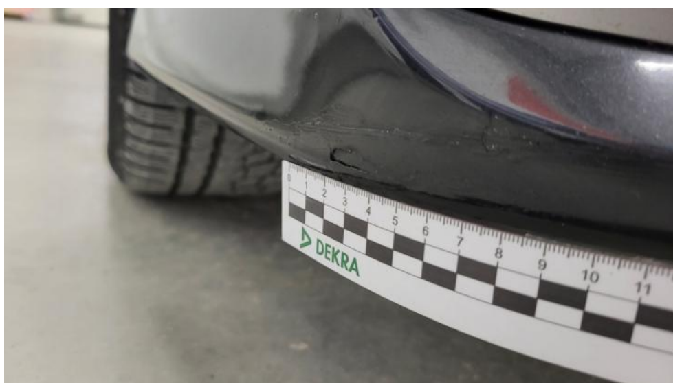
Fot. 44. Zderzak - Pęknięcie/rozerwanie 1
