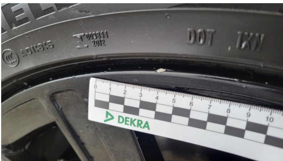
Photo 62. Felga aluminiowa przednia P - Rysa/odprysk 1
