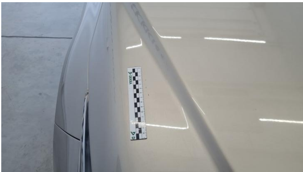
Photo 35. Pokrywa komory silnika - Rysa/odprysk 1
