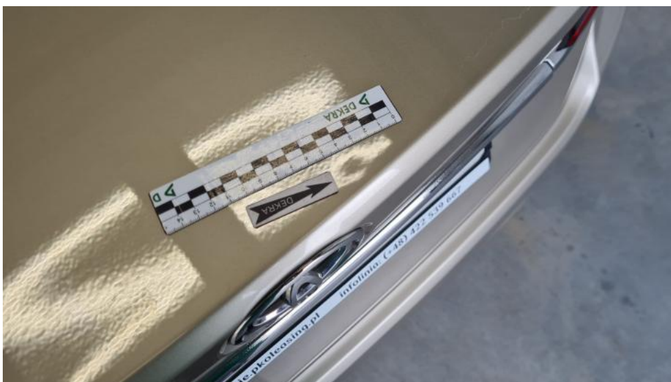
Photo 42. Pokrywy bagażnika - Wgniecenie/odkształcenie 1
