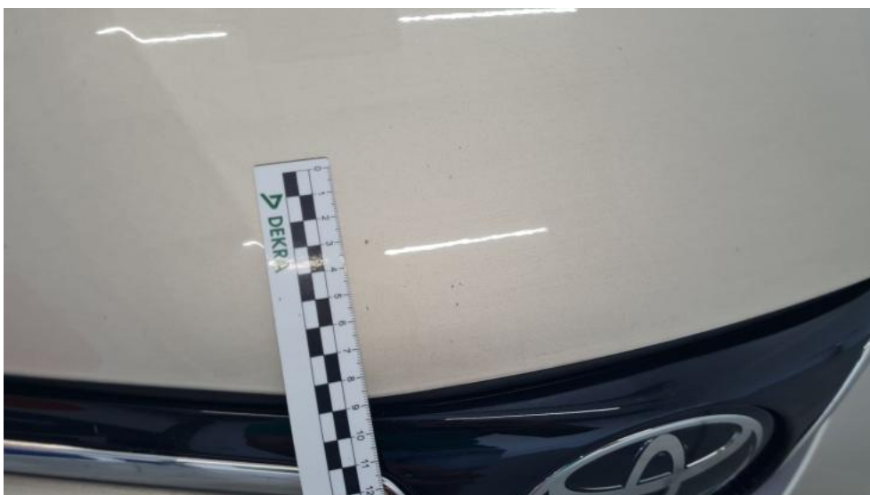
Photo 36. Pokrywa komory silnika - Rysa/odprysk 2
