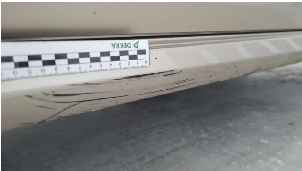
Photo 41. Próg P - Rysa/odprysk 2
