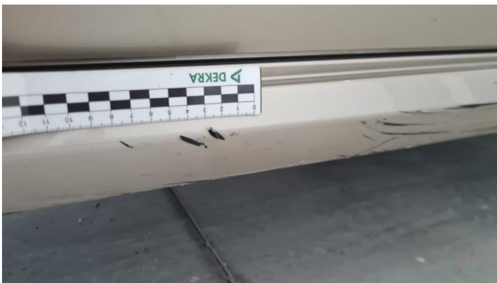
Photo 40. Próg P - Rysa/odprysk 1
