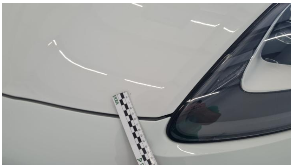
Photo 36. Pokrywa komory silnika - Rysa/odprysk 1
