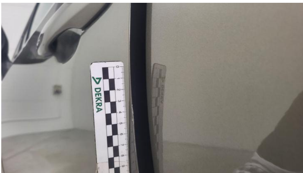
Photo 50. Drzwi przed L - Rysa/odprysk 1
