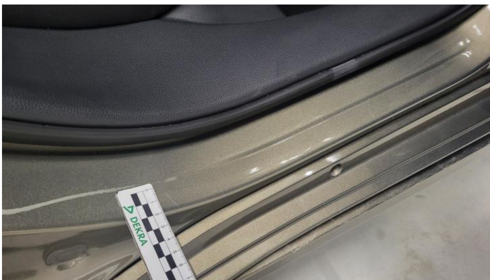
Photo 44. Próg P - Rysa/odprysk 1
