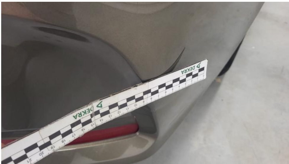
Photo 47. Zderzak tylny - Wgniecenie/odkształcenie 1
