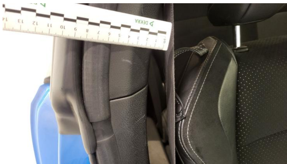
Fot. 91. Wykładzina(y) słupka środkowego P - Rysa/odprysk 1
