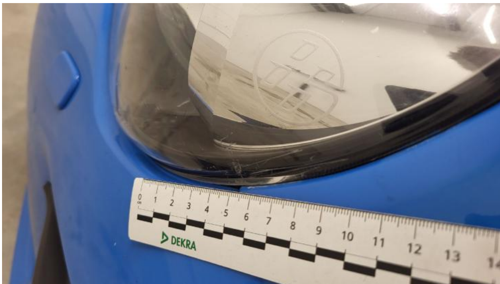
Fot. 83. Reflektor L - Rysa/odprysk 1
