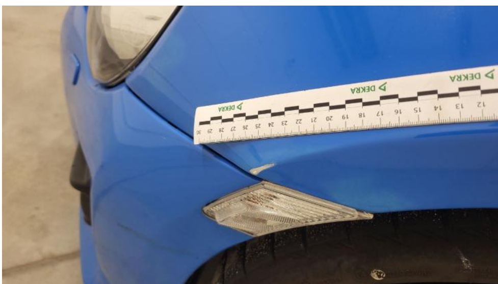
Fot. 80. Błotnik przedni L - Rysa/odprysk 1
