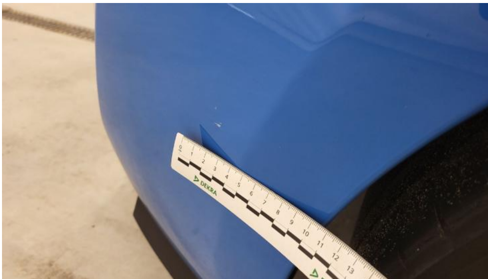
Fot. 67. Zderzak tylny - Rysa/odprysk 1
