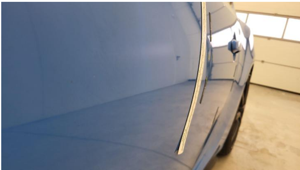
Fot. 77. Drzwi przed L - Wgniecenie/odkształcenie 1
