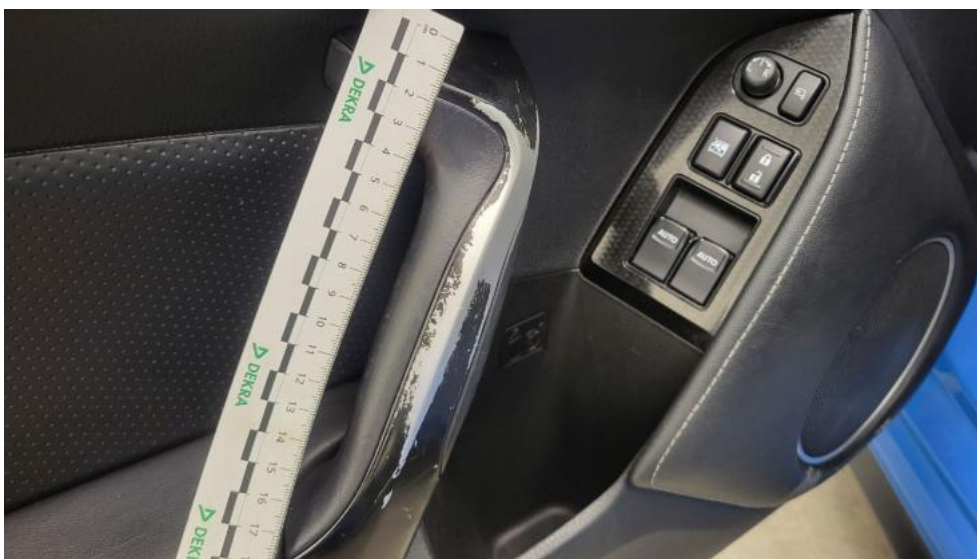
Fot. 89. Uchwyt drzwi prze L - Rysa/odprysk 1
