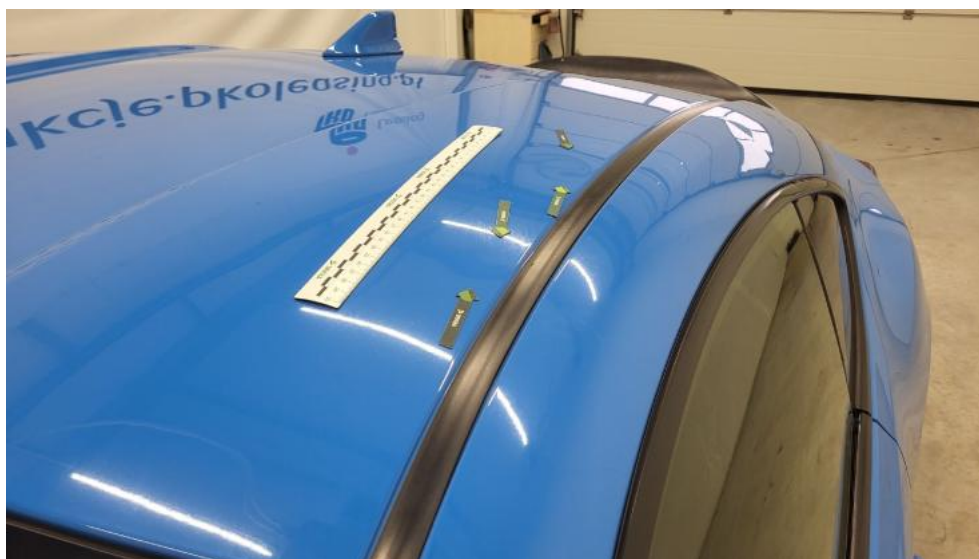
Fot. 71. Dach - Wgniecenie/odkształcenie 1
