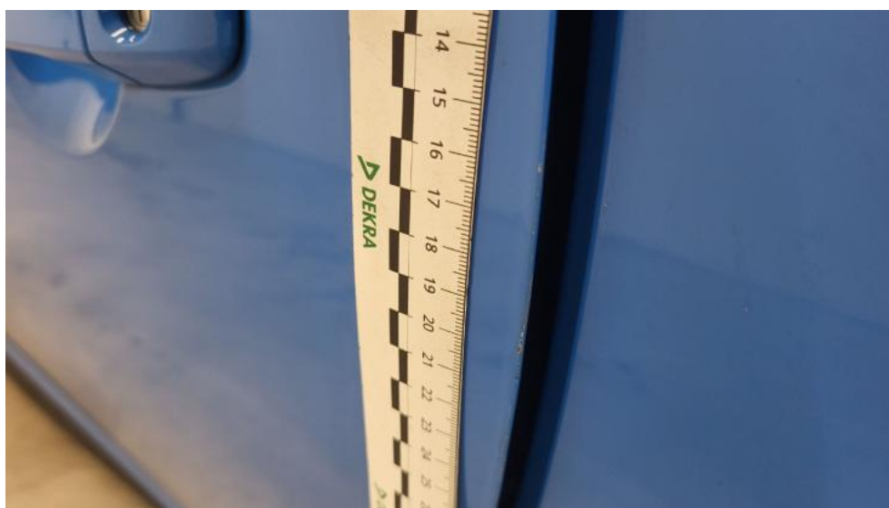
Fot. 76. Drzwi przed L - Rysa/odprysk 1
