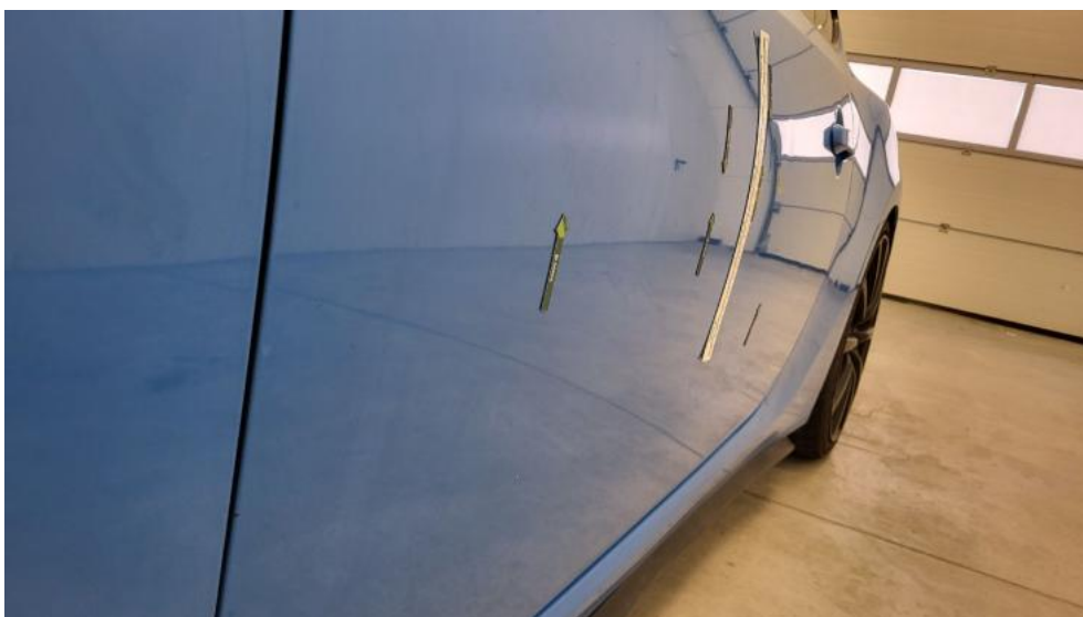
Fot. 78. Drzwi przed L - Wgniecenie/odkształcenie 2
