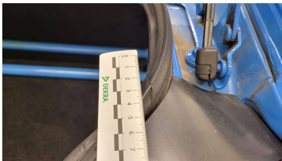
Fot. 92. Uszczelka pokrywy tylnej - Pęknięcie/rozerwanie 1
