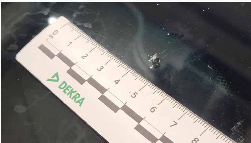
Fot. 49. Szyba czołowa - Pęknięcie/rozerwanie 1
