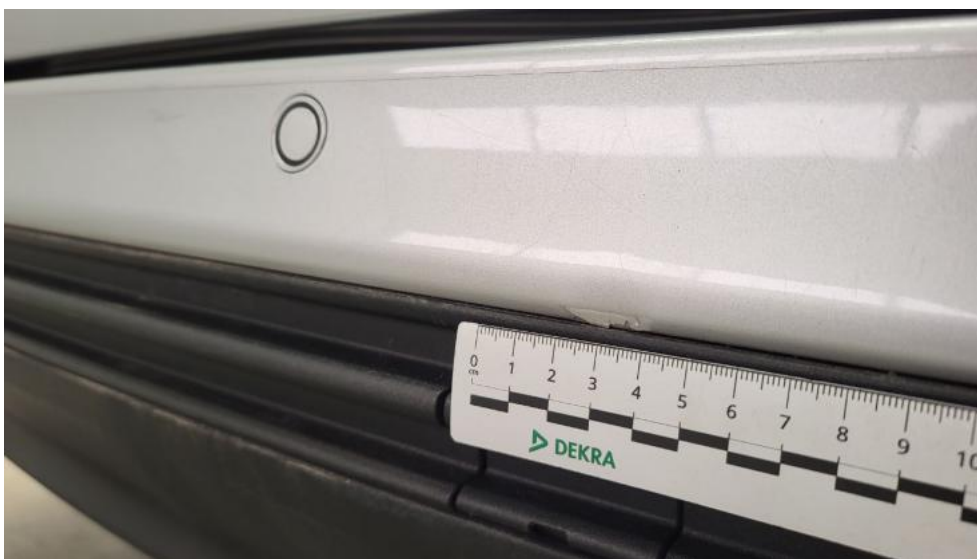
Photo 67. Zderzak tylny - Pęknięcie/rozerwanie 1
