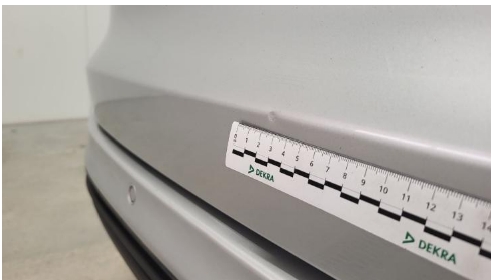
Photo 64. Pokrywy bagażnika - Wgniecenie/odkształcenie 2
