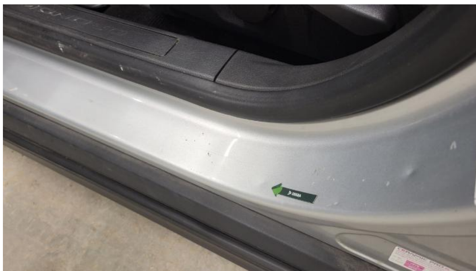
Photo 82. Próg L - Wgniecenie/odkształcenie 1
