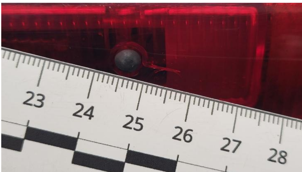
Photo 62. Dodatkowa lampa stopu - Pęknięcie/rozerwanie 1
