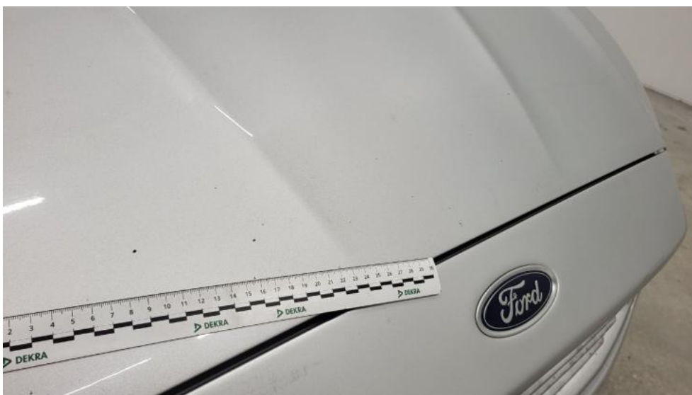
Photo 38. Pokrywa komory silnika - Rysa/odprysk 1
