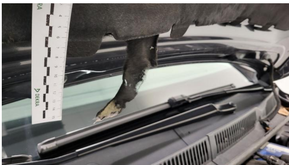
Fot. 42. Wykładzina pokrywy komory silnika - Pęknięcie/rozerwanie 1
