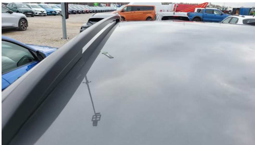
Fot. 62. Dach - Wgniecenie/odkształcenie 1
