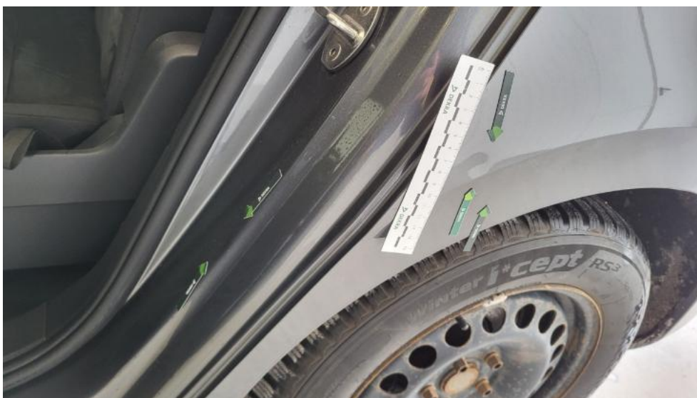
Fot. 66. Błotnik tylny L / Ściana boczna L - Wgniecenie/odkształcenie 2
