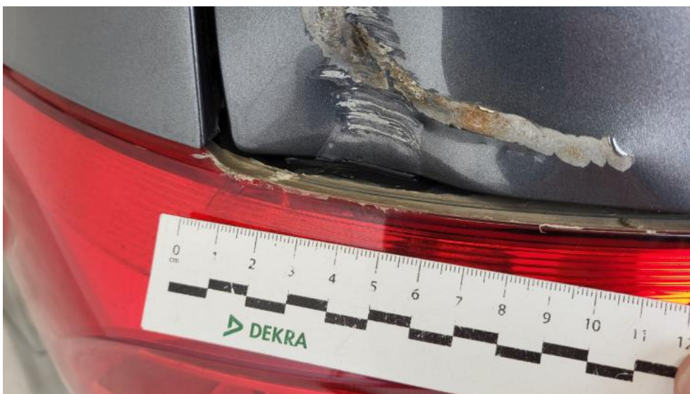
Fot. 69. Lampa tylna zew L - Pęknięcie/rozerwanie 2
