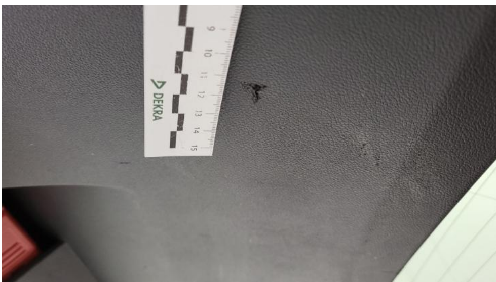
Fot. 86. Wykładzina pokrywy tylnej - Rysa/odprysk 1
