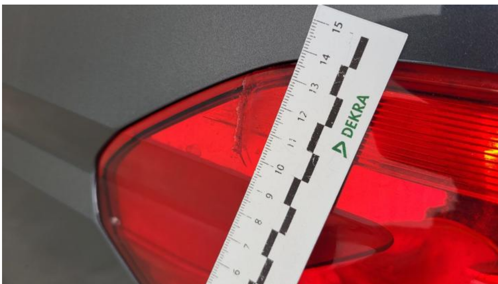
Fot. 68. Lampa tylna zew L - Pęknięcie/rozerwanie 1
