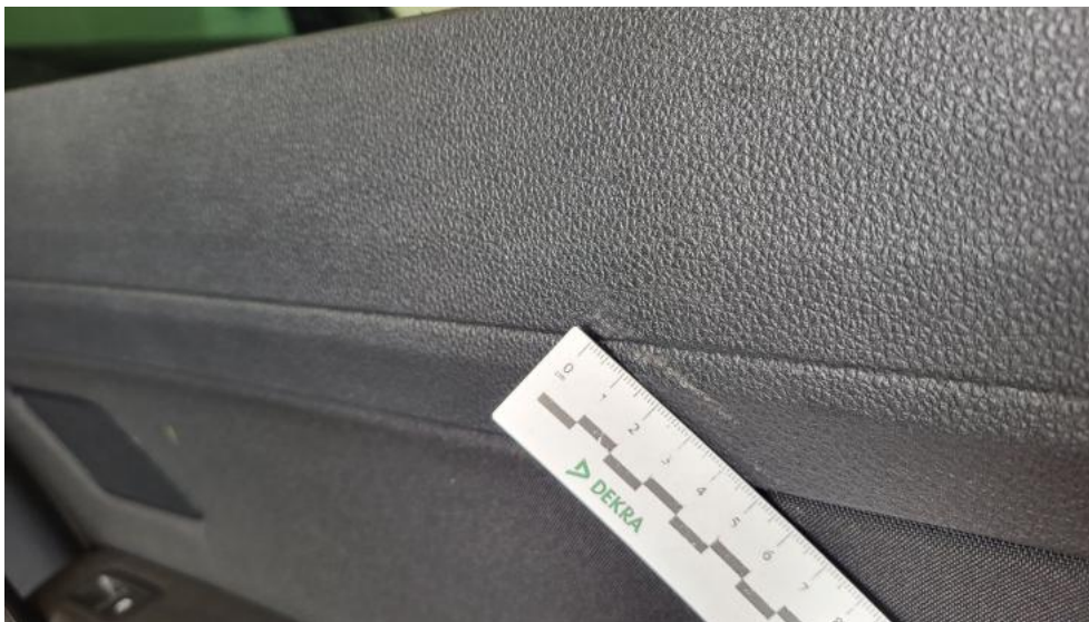
Fot. 81. Tapicerka drzwi tylnych P - Rysa/odprysk 1
