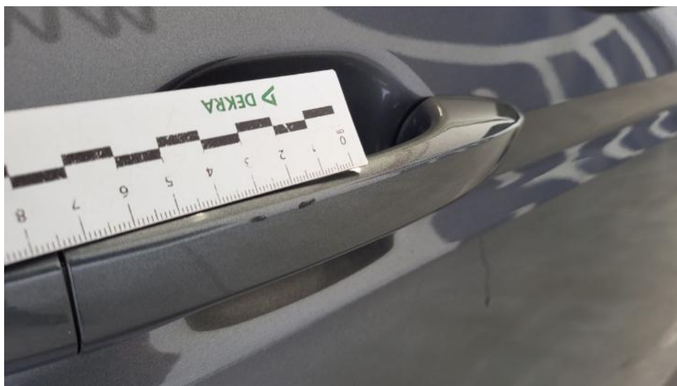
Fot. 49. Klamka drzwi prz P - Rysa/odprysk 1
