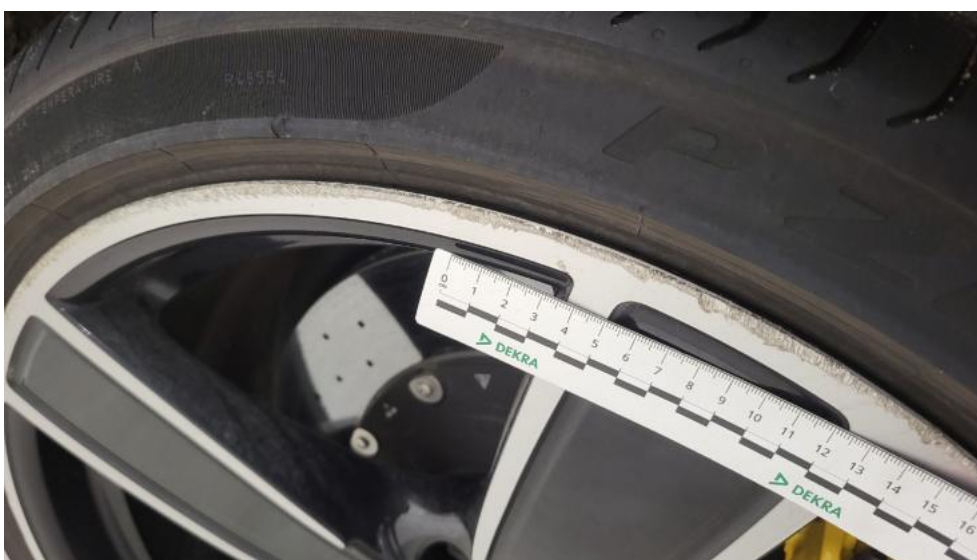
Fot. 56. Felga aluminiowa tylna P - Rysa/odprysk 1
