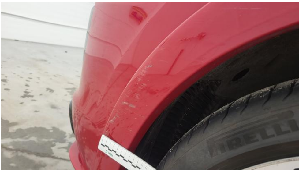
Fot. 69. Listwa zderzaka prz L - Rysa/odprysk 1
