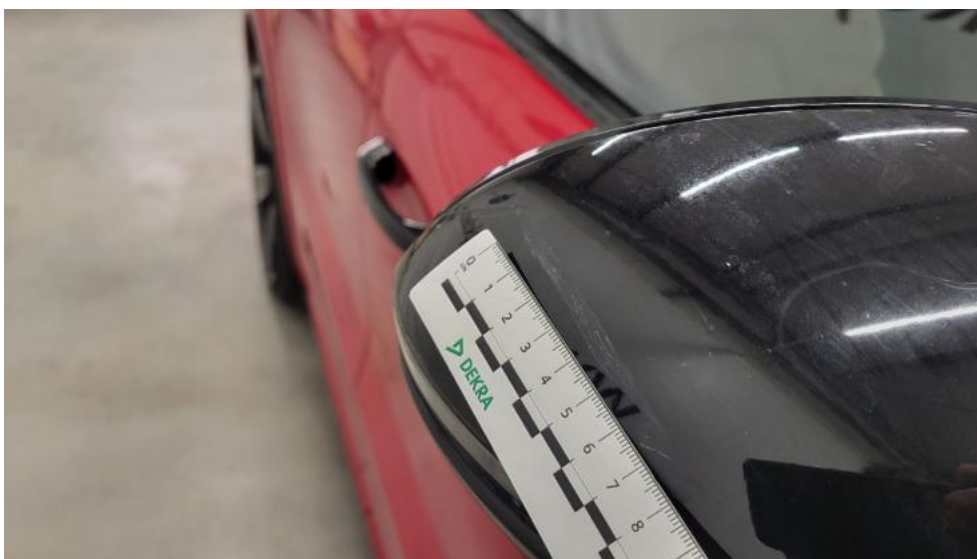
Fot. 55. Lusterko zew P - Rysa/odprysk 1
