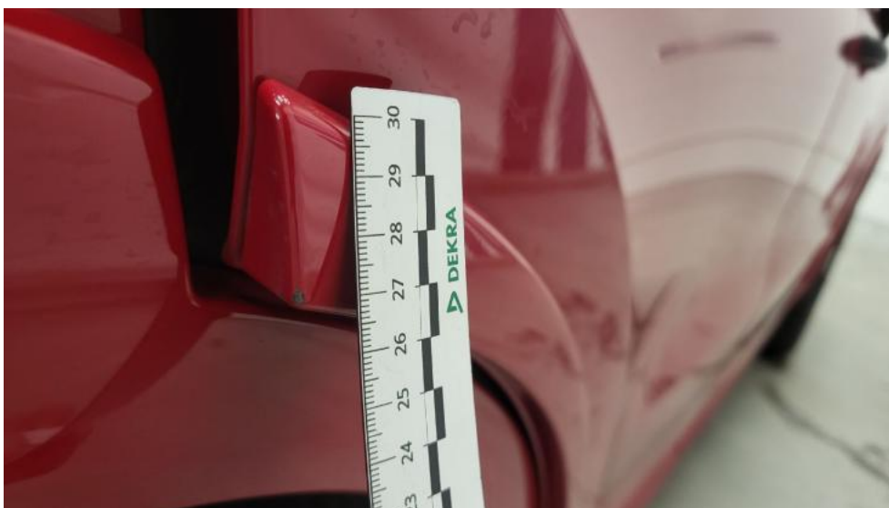
Fot. 54. Listwa drzwi tylnych P - Rysa/odprysk 1
