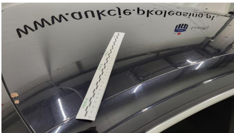
Fot. 60. Dach - Rysa/odprysk 1
