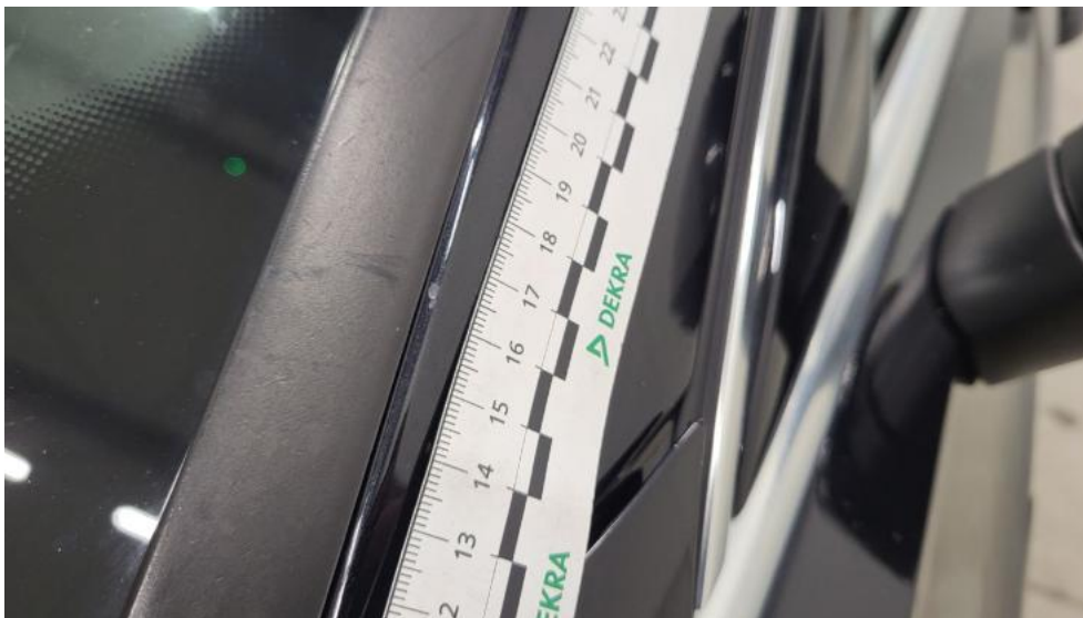
Fot. 71. Stupek przedni L - Rysa/odprysk 1
