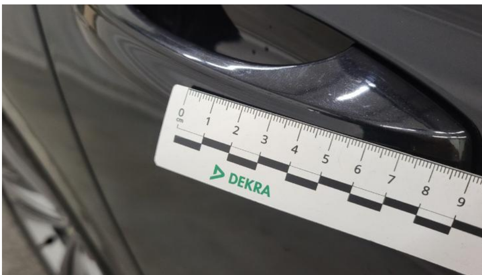
Fot. 53. Klamka drzwi tyl P - Rysa/odprysk 1
