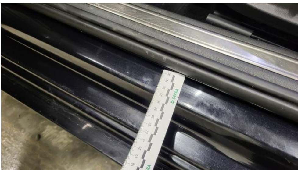
Fot. 70. Próg L - Rysa/odprysk 1
