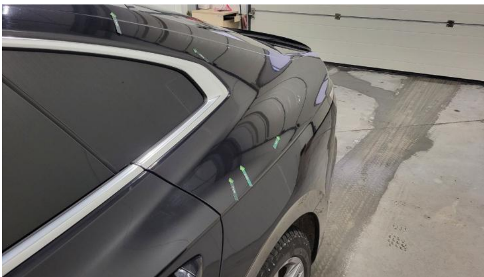
Fot. 63. Błotnik tylny L / Ściana boczna L - Wgniecenie/odkształcenie 1
