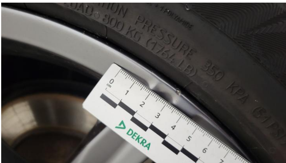
Fot. 56. Felga aluminiowa tylna P - Rysa/odprysk 1
