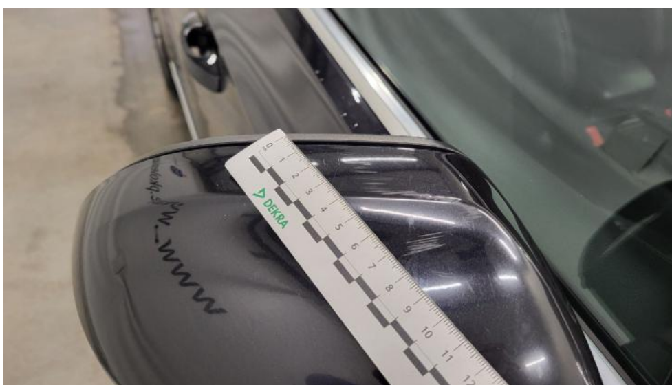
Fot. 54. Lusterko zew P - Rysa/odprysk 1
