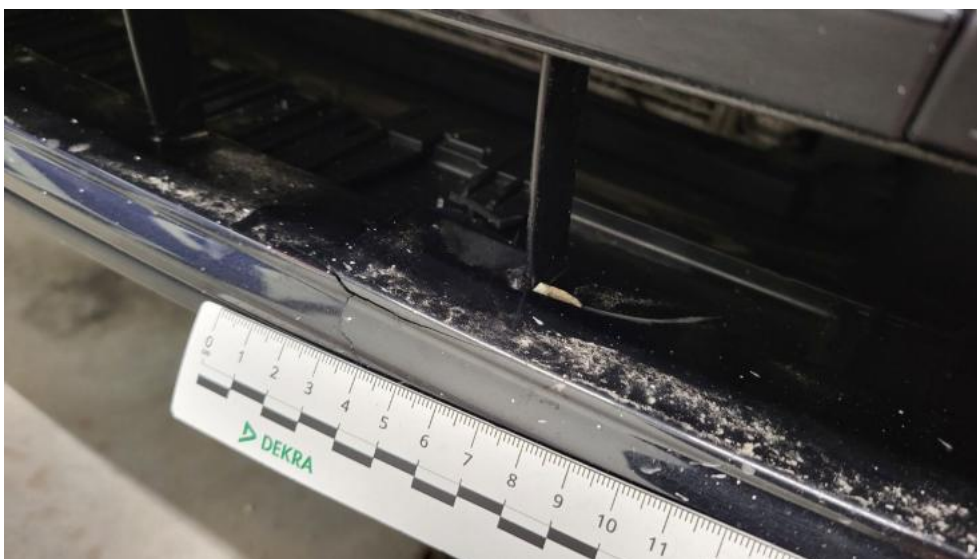
Fot. 43. Krata zderzaka prz. - Pęknięcie/rozerwanie 1
