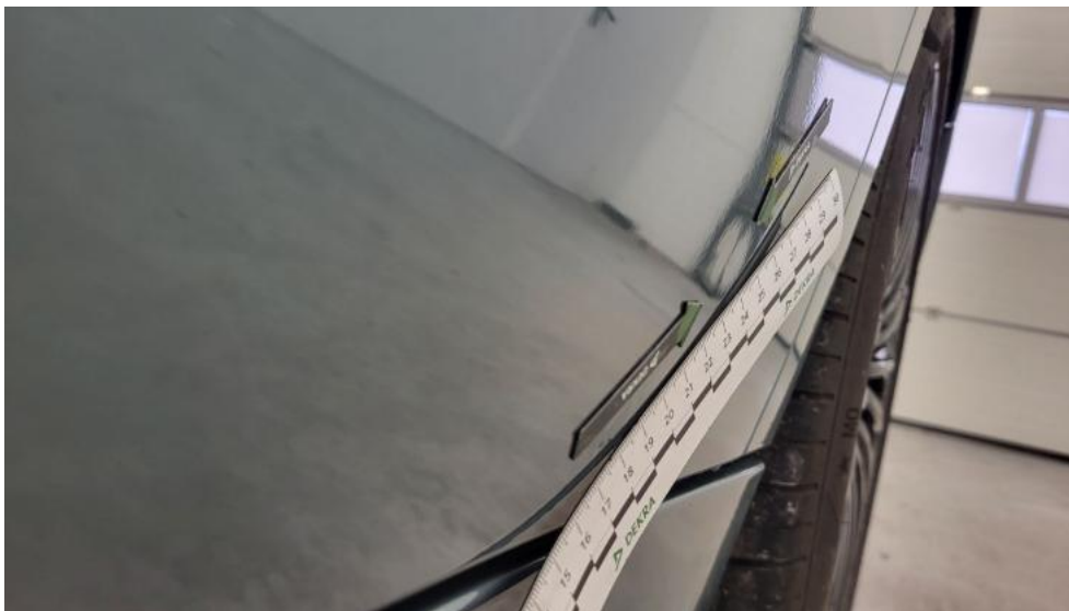
Fot. 49. Drzwi tylne L - Wgniecenie/odkształcenie 1
