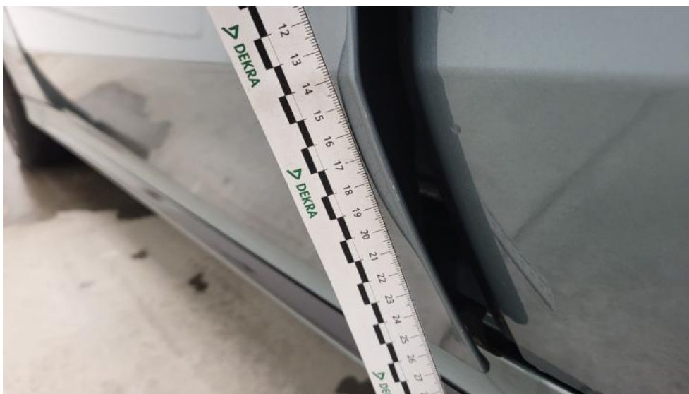
Fot. 48. Drzwi przed L - Rysa/odprysk 1
