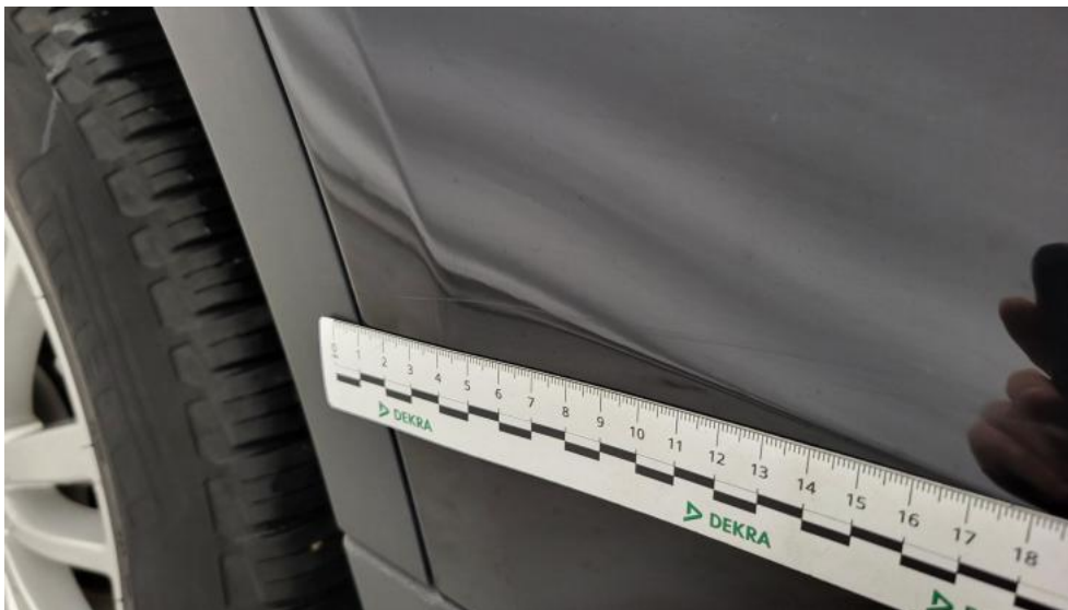
Fot. 53. Drzwi tylne P - Rysa/odprysk 1
