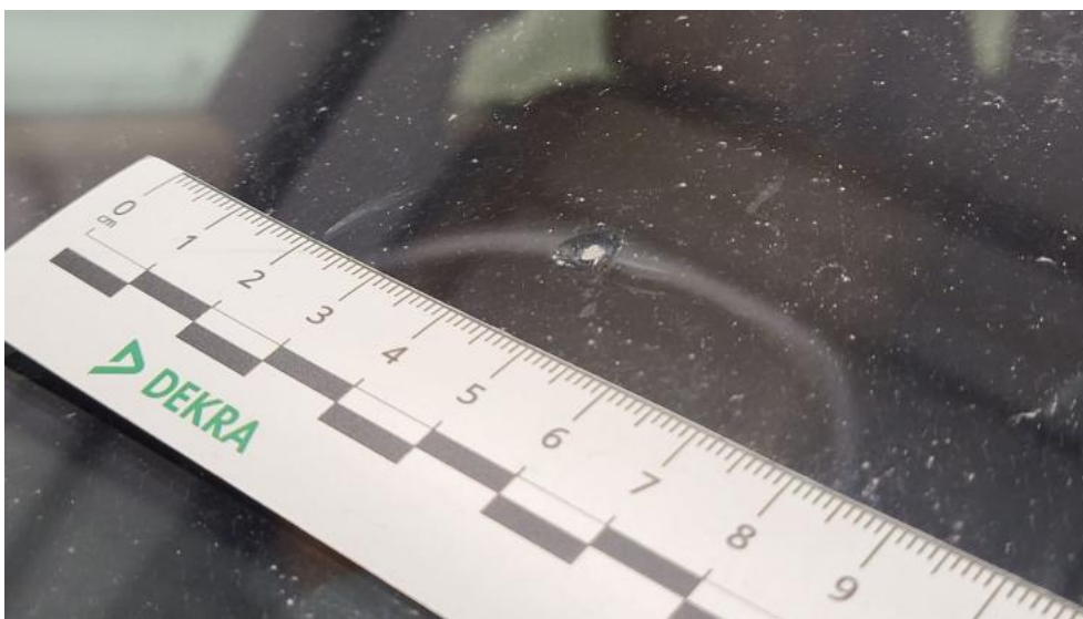
Fot. 45. Szyba czołowa - Pęknięcie/rozerwanie 1
