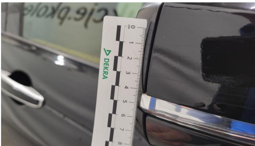
Fot. 55. Lusterko zew P - Rysa/odprysk 1
