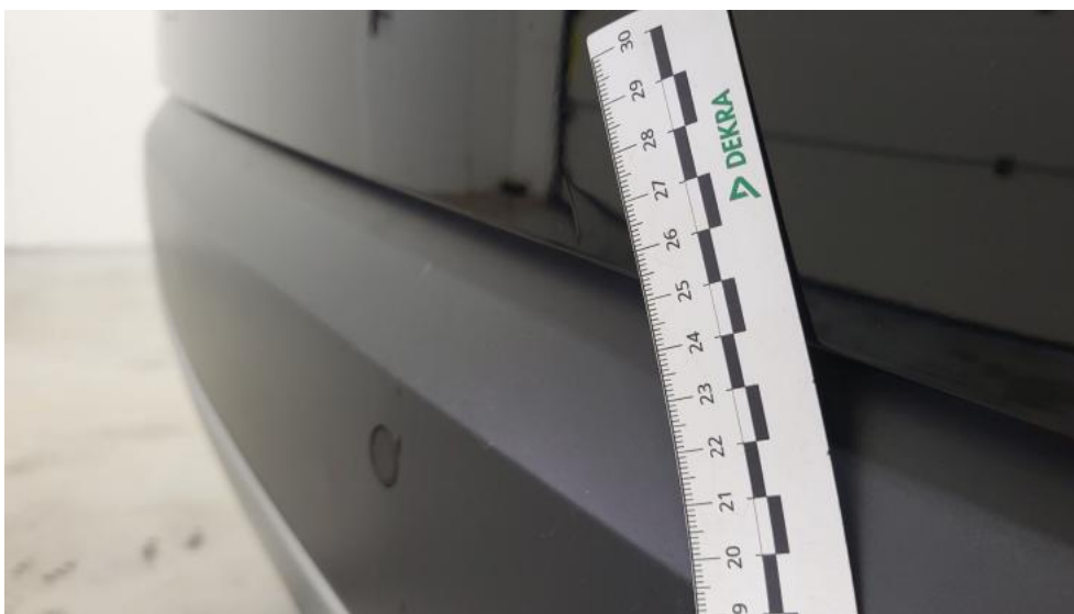
Fot. 59. Pokrywy bagażnika - Wgniecenie/odkształcenie 1
