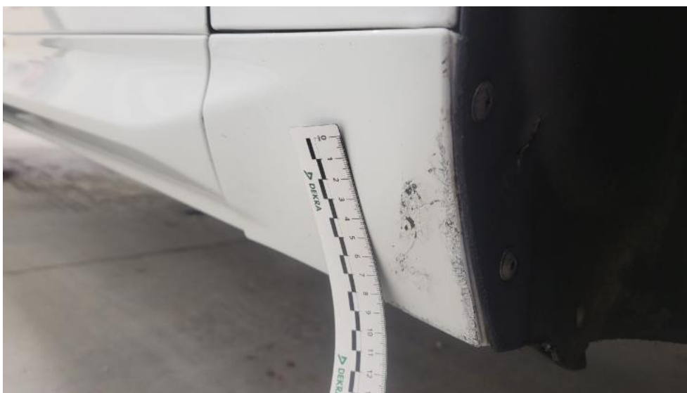
Fot. 51. Próg P - Rysa/odprysk 1
